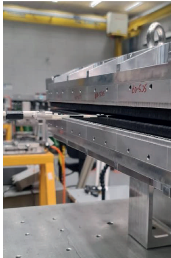
Figura 47: Ondulador montado em processo de medição de campo magnético utilizando haste com sensor Hall acoplado a bancada de caracterização magnética.
