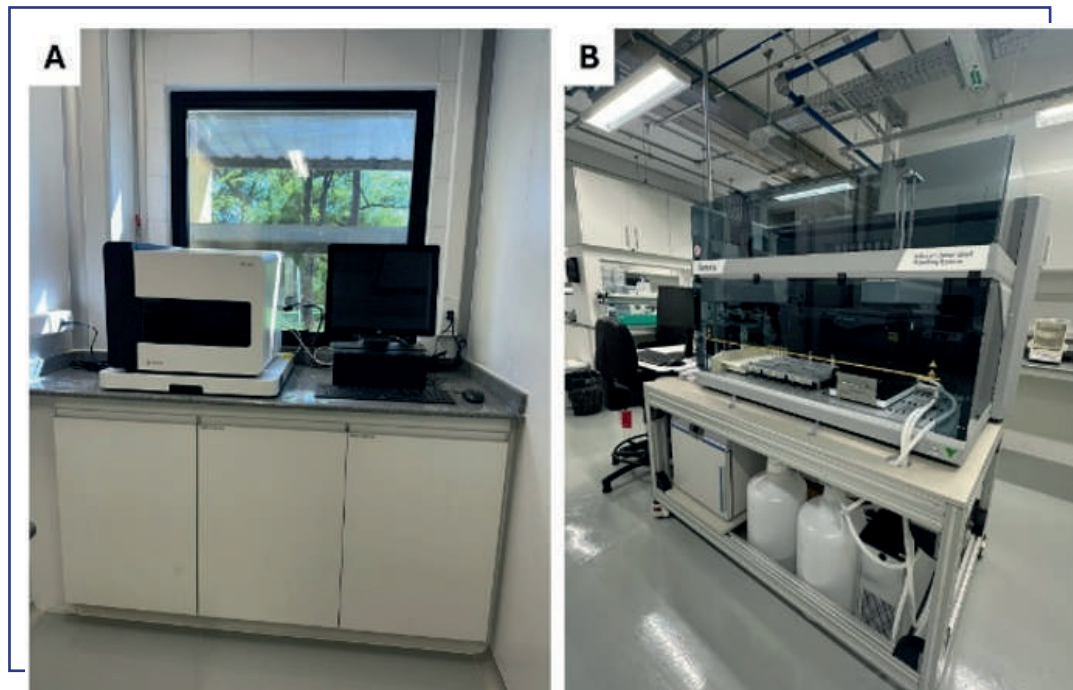
Figura 58: Aquisição e instalação do sistema iSCAN (A) e um sistema de manipulação de líquidos Infinium Automated Pipetting System with Illumina Lab Automation Software Solution – IAPS with ILASS (B).
