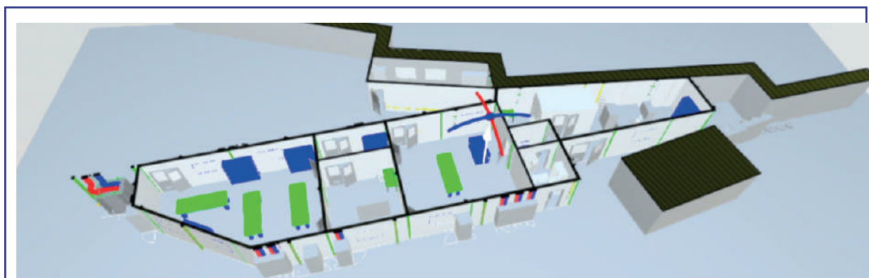
Figura 54: Visão em modelo 3D da nova área de instrumentação e engenharia do Sirius, reunindo salas limpas ISO 6 e ISO 7, áreas de metrologia óptica e mecânica, montagem e testes de componentes de linhas de luz em uma mesma região do prédio.
