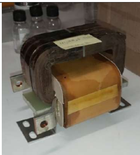
Figura 20 - Bobina montada com 17 espiras
