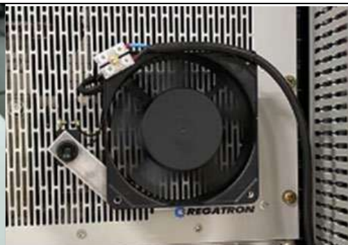
Figura 19 - Ventilador adicionado para refrigeração
