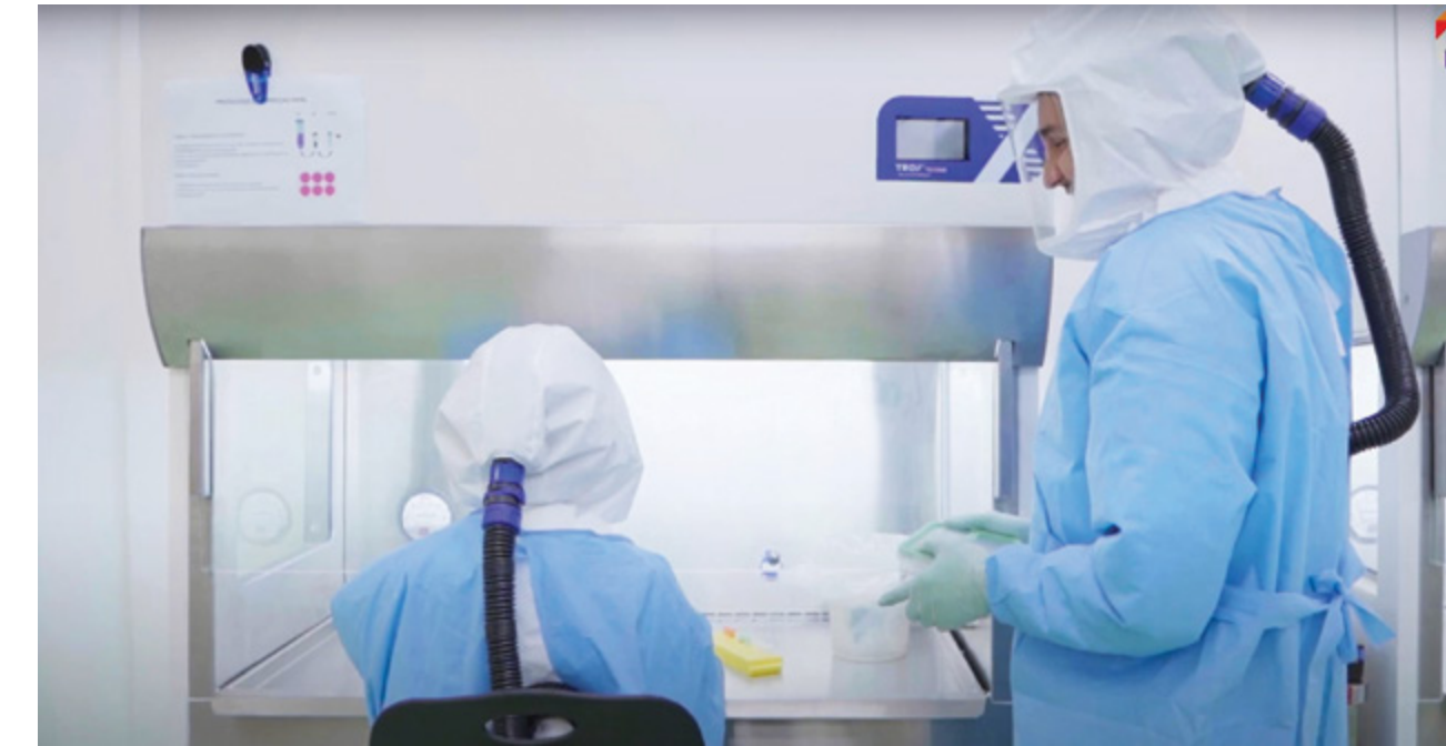
Laboratório de treinamento do CNPEM conta com Equipamentos de Proteção Individual (EPIs) para nível 3 de biossegurança. Na foto, profissional em sessão prática utilizando respirador motorizado com filtro HEPA. CNPEM training laboratory is equipped with Personal Protective Equipment (PPE) for biosafety level 3. In the photo, a professional in a hands-on session uses a powered respirator with a HEPA filter.
