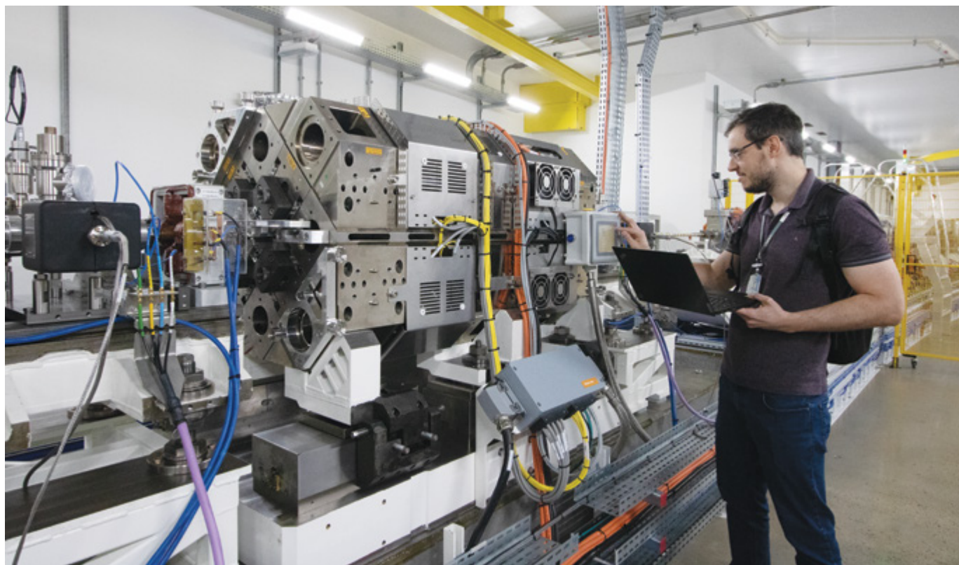
Projetado e construído no CNPEM, o novo ondulador da linha de luz SABIÁ permite o ajuste da polarização e da energia do feixe de luz, oferecendo maior controle e precisão para a realização de experimentos científicos. Designed and built at CNPEM, the new undulator for the SABIÁ beamline allows for the adjustment of the polarization and energy of the light beam, providing greater control and precision for conducting scientific experiments.
