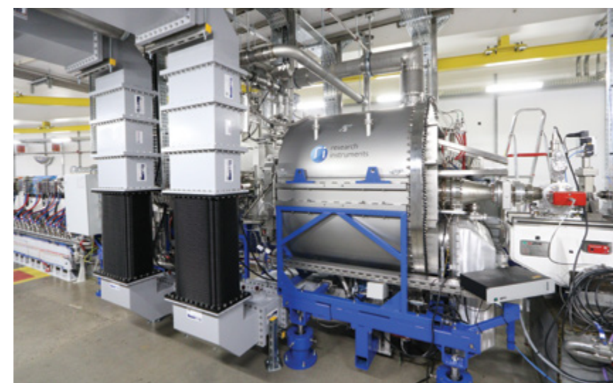
A instalação de uma nova cavidade de radiofrequência supercondutora representará um crescimento de 3,5 vezes no fluxo de luz síncrotron nas estações experimentais. The installation of a new superconducting radiofrequency cavity will result in a 3.5-fold increase in synchrotron light flux at the experimental stations.
