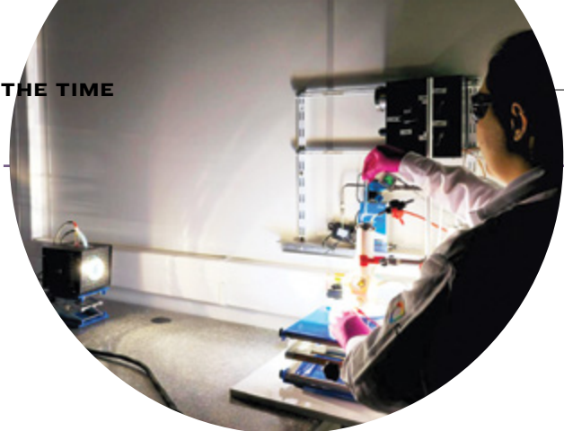
Ilustração de um experimento fotoeletroquímico com iluminação solar artificial, utilizado para análises elétricas e cromatografia gasosa de materiais voltados à geração de hidrogênio. Illustration of a photochemical experiment with artificial solar illumination used for electrical and gas chromatography analysis of materials related to hydrogen production.
