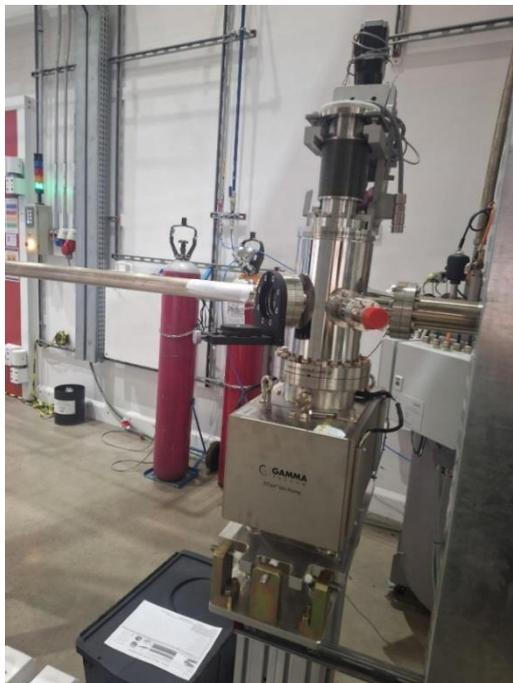
Na figura 9 podemos observar o espelho M3 em posição no trecho TS.6 dentro da cabana experimental.
