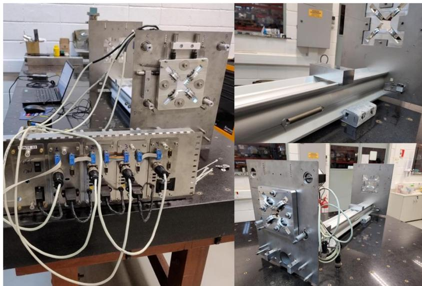
Figura 3: Setup Bead Pull desenvolvida pelo CNPEM para um ajuste de RFQ.
