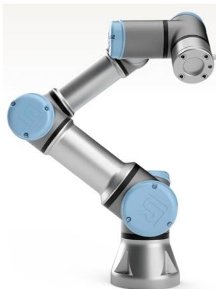
Figura 1- Robô articulado de seis eixos UR3e.
