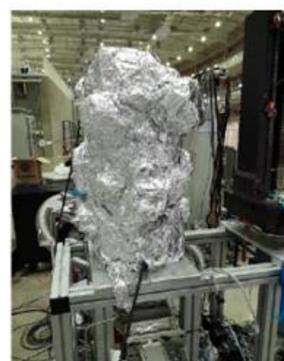
Figura 2 – a) Câmara de preparação da estação experimental da linha SAPÉ com vários dos seus equipamentos já instalados; b) câmara de preparação em “baking” para comissionamento de vácuo
