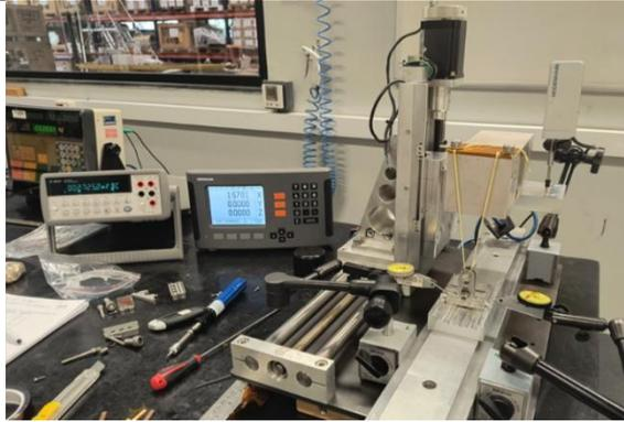
Figura 6 – Setup de teste para simular força de arranque.
