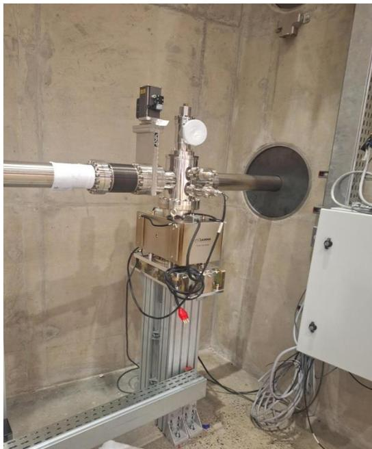
A Figura 8 mostra o trecho TS.3 Estação de bombeamento e manipulador do DVF instalados
