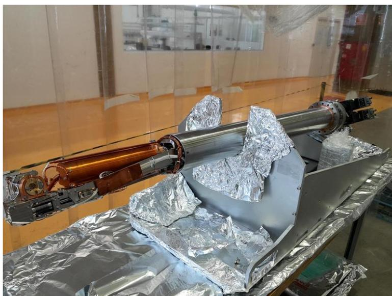
Figura 1 – Manipulador “Carving” da câmara principal da estação experimental retirado para manutenção, melhorias e comissionamento.
