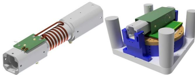
Figura 4: Desenhos mecânicos da sonda de radiofrequência (à esquerda) e ela integrada com o magneto central (à direita).
