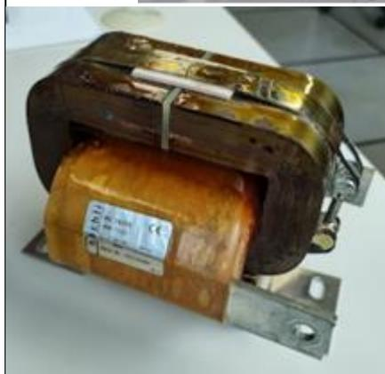
Figura 1 – a) Indutor de saída da Regatron após evento de queima. b) Indutor Reformado.
