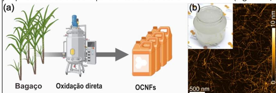
Figura 1. (a) Esquema ilustrativo e (b) fotografia/Imagem de AFM das OCNFs obtidas no processo de reação direta no teste piloto.
