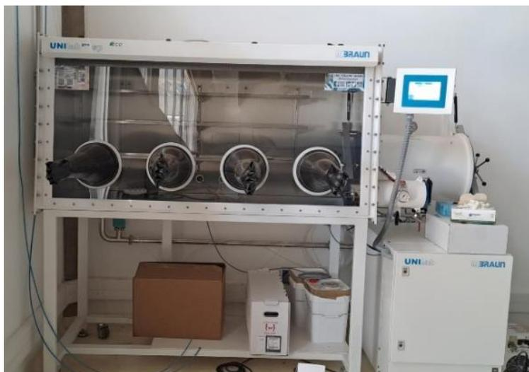
Figura 1: Equipamentos instalados no LMF. Capela walk-in e glovebox para uso de gases em altas pressões e manipulação de materiais sensíveis ao ar atmosférico.
