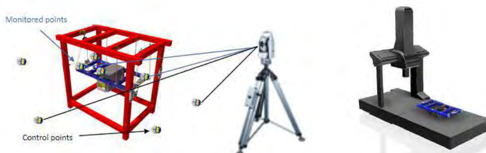
Figura 388: Testes de alinhamento e monitoramento da massa fria e a utilização da CMM para montagens mecânicas de precisão.
