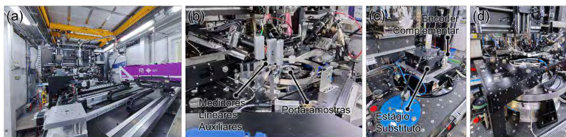
Figura 198: Estação experimental SAPOTI: (a) visão geral antes da intervenção; (b) destaque para a solução de operação paliativa com medidores lineares externos auxiliares; (c) torre de estágios de amostras, com destaque para o novo estágio vertical e o encoder óptico complementar; e (d) estação próxima à finalização de remontagem e realinhamento.
