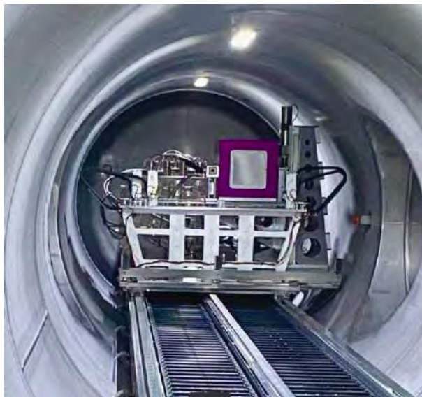
Figura 91: Detector PIMEGA 540D#4 instalado no túnel de vácuo da linha SAPUCAIA.
