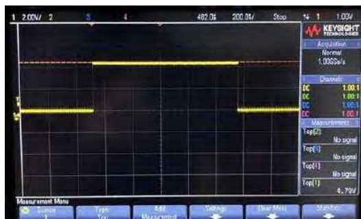
Figura 427: Imagem da tela do osciloscópio detectando o pulso TTL de 1 ms durante o teste realizado para validação do sinal de blanking.
