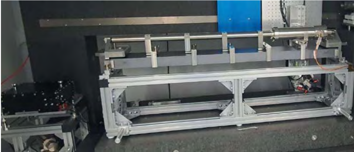
Figura 49: Configuração de medição do espelho QUA-M2.
