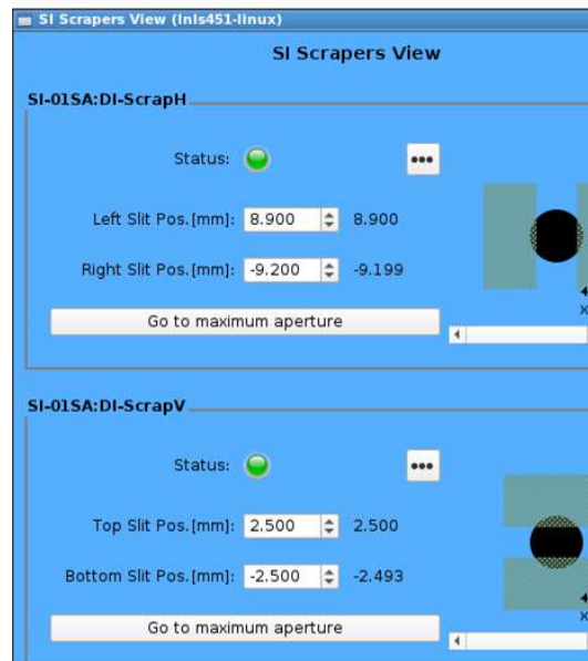
Figura 33: Posição dos scrapers no trecho de injeção atualmente utilizadas para proteção dos IDs a erros de injeção.
