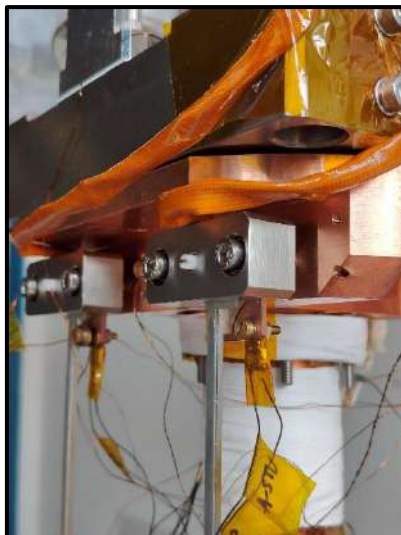
Figura 392: Novo conceito de fixação das “current-leads” instalado na ponta fria da parte HTS no criostato vertical.
