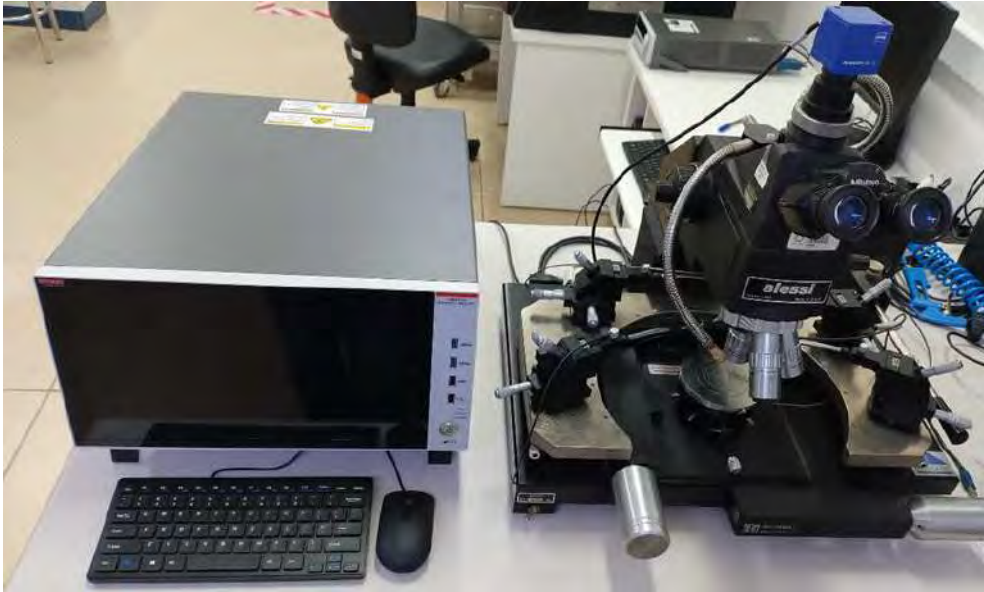
Figura 322: Acoplamento do equipamento Keithley 4200 junto a um sistema do tipo probe station para a conexão de amostras.
