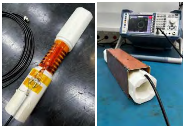
Figura 423: Imagem do segundo protótipo da sonda integrado sem o uso de PCB (à esquerda) e sob testes com o VNA dentro da sua shield de RF (à direita).
