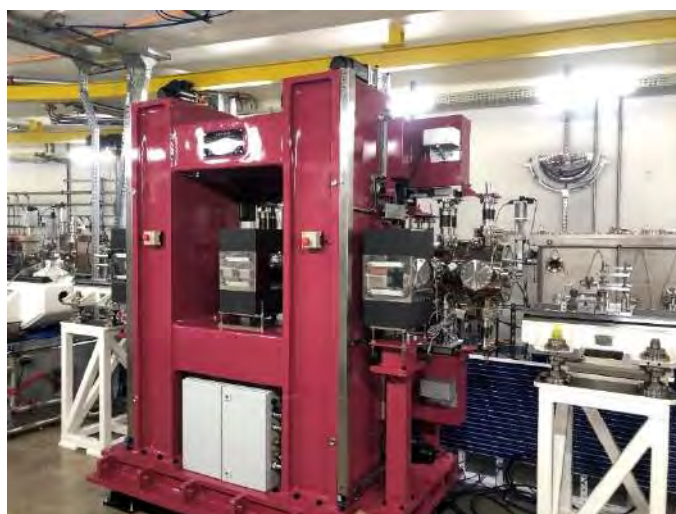
Figura 480: Ondulador e suportes posicionados e alinhados
