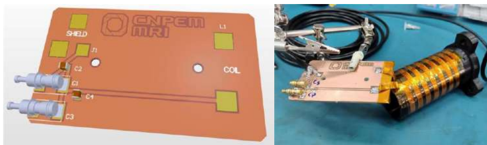
Figura 422: Imagem da PCB com o circuito de casamento de impedâncias e sintonização (à esquerda) integrada com o enrolamento, compondo o primeiro protótipo da sonda completo (à direita).
