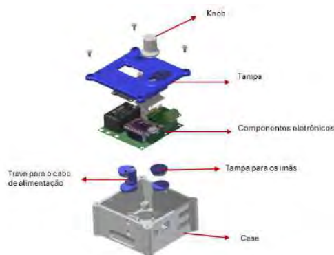
Figura 500: Design completo do case com as montagens dos componentes e parafusos
