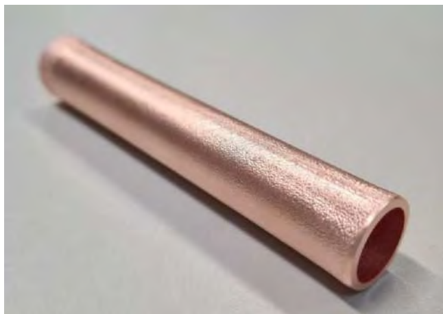
Figura 490: Tubo de cobre eletroformado após corrosão do mandril de alumínio.
