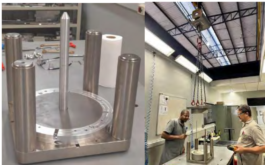
Figura 413: À esquerda, imagem da montagem dos discos na base do magneto central; à direita, imagem do laboratório durante o processo de montagem com auxílio de guindaste para montagem.
