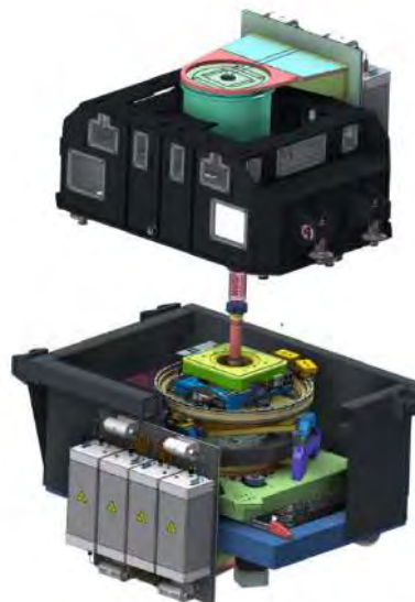
Figura 81: Representação CAD do manipulador de amostras de alta estabilidade e módulos associados da microestação da linha MOGNO. A parte superior ilustra os módulos de controle térmico e acumuladores, enquanto a parte inferior detalha o manipulador com sua estrutura de posicionamento e
