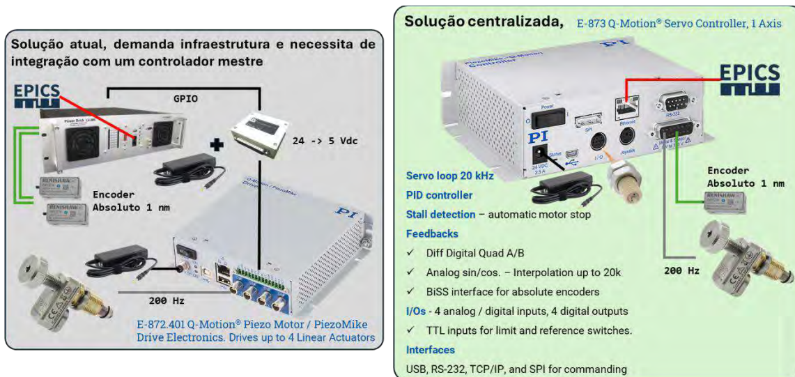
Figura 76: Comparação entre a arquitetura de controle atual, controlador E-872.4, e a proposta, controlador E-873, para o controle dos piezoelétricos em mecanismos de espelho nas linhas de luz.
