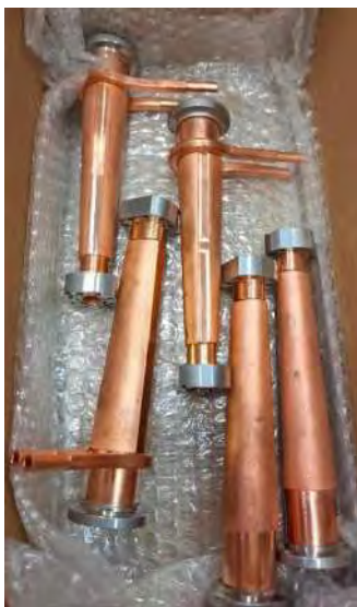
Figura 473: Transições de instalação e reserva com fabricação e brasagem finalizadas, aguardando deposição NEG.
