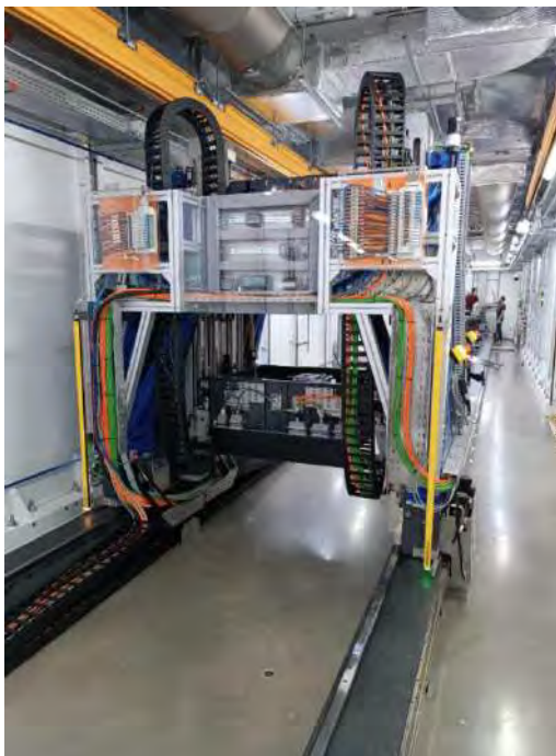
Figura 122: Microestação da linha Mogno instalada dentro do hutch experimental.
