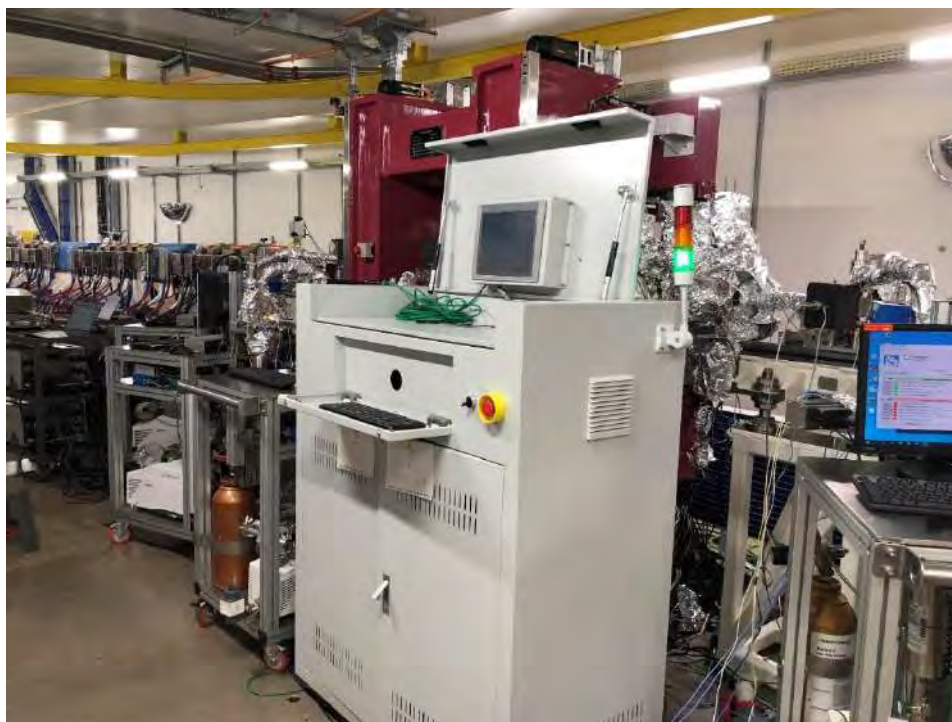
Figura 481: Ondulador e câmaras de vácuo em processo de aquecimento
