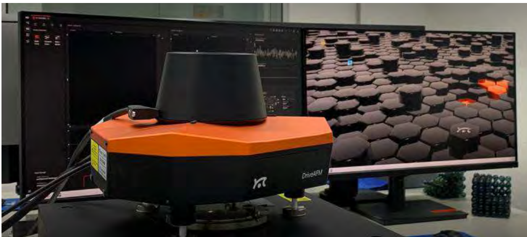
Figura 326: Microscópio de varredura por sonda modelo DriveAFM, do fabricante Nanosurf (Suíça) instalado no Laboratório de Microscopia de Força Atômica do LNNano.
