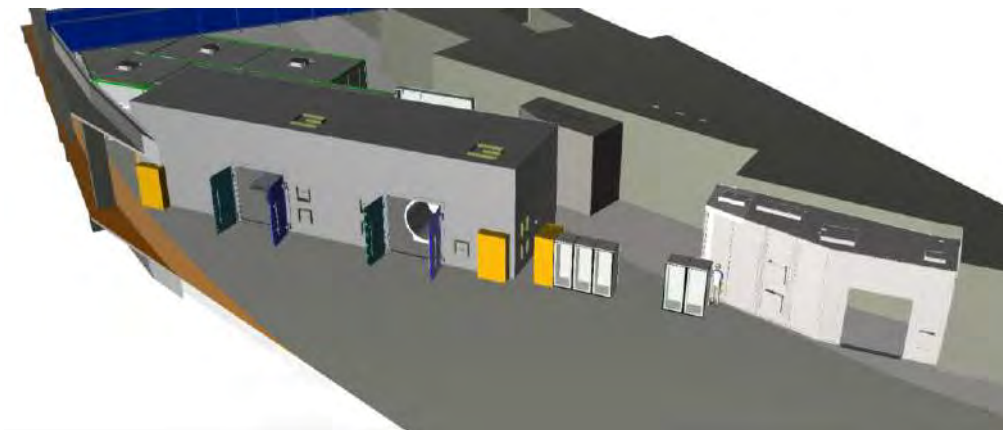
Figura 152: Modelo tridimensional da infraestrutura da linha de luz ARIRANHA, incluindo a cabana ótica e as cabanas experimentais. Essas cabanas foram projetadas para lidar com feixes monocromáticos e "pink", acomodando duas estações experimentais: a estação B dedicada à metrologia óptica, equipada com um refletômetro em vácuo e um difratômetro do UVX, e a estação C, voltada para instrumentação com luz síncrotron, com mesa óptica e outro difratômetro do UVX. A estrutura também inclui áreas dedicadas à instrumentação científica e suporte técnico.
