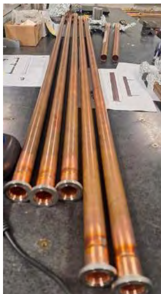
Figura 474: Câmaras retas de instalação dos VPUs com flanges brasadas aguardando brasagem e deposição NEG.
