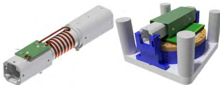
Figura 420: Desenhos mecânicos da sonda de radiofrequência (à esquerda) e ela integrada com o magneto central (à direita).
