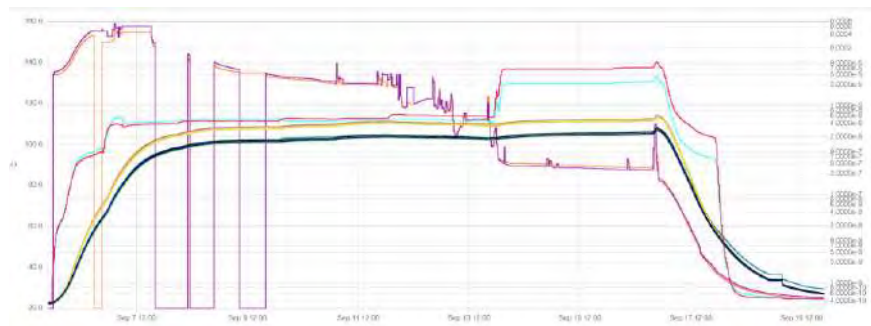
Figura 482: Aquecimento e pressão final do ondulator IVU na linha EMA - 4.0E-10 mbar
