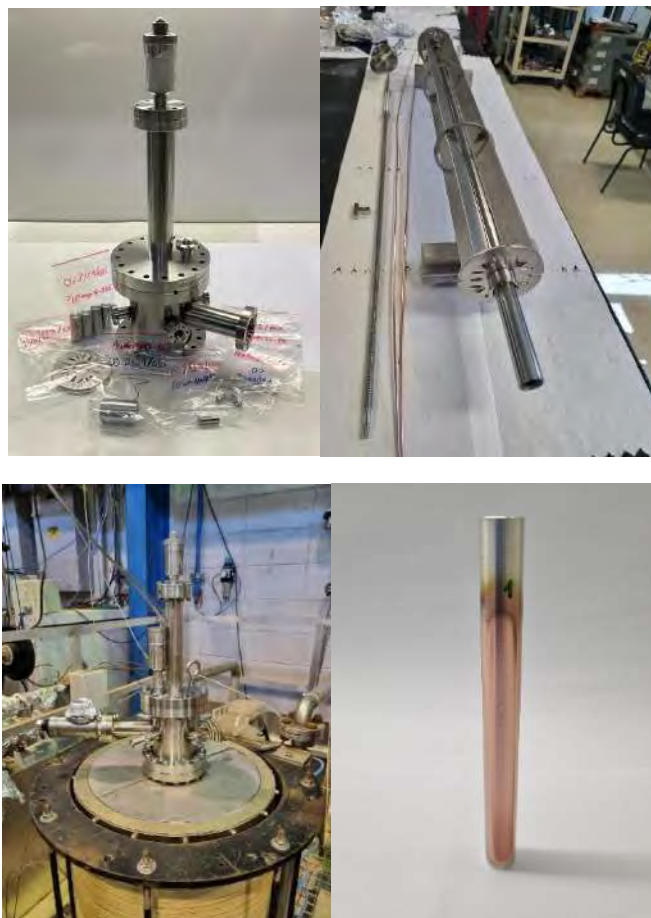
Figura 491: Sistema de deposição de filme NEG no mandril de alumínio utilizado no magnetron sputtering e amostra de tubo após deposição.
