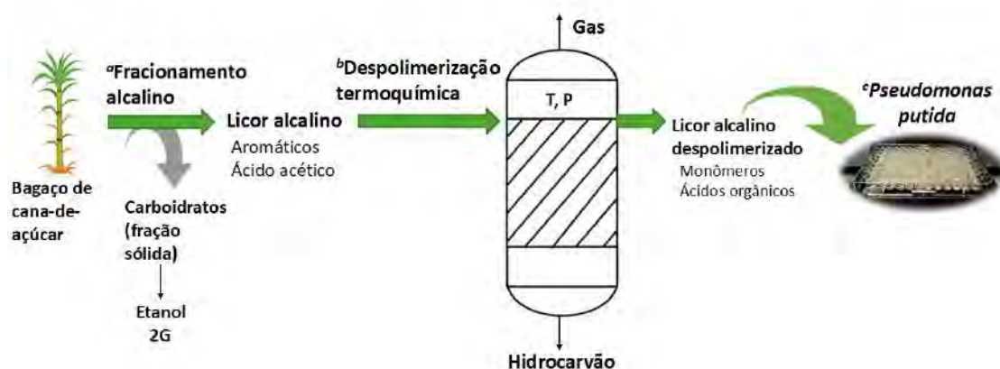
Figura 368 - Representação do processo termoquímico desenvolvido para investigar como a variação das condições de despolimerização da lignina presente no licor alcalino impacta a compatibilidade do licor com a capacidade metabólica de P. putida . a) 70 °C, 1:12 sólido-líquido, 70 gNaOH/kgbagaço); b) Planejamento experimental 2 3 , variando temperatura (T) de 180 a 300 °C, tempo de 30 a 90 min e pressão (P) de oxigênio de 0 a 4 bar. c) Ensaios de crescimento nos licores foram realizados com a bactéria Pseudomonas putida KT2440. A composição de cada licor antes e depois do cultivo bacteriano foi analisada por cromatografia líquida de alto desempenho e cromatografia gasosa acoplada a espectrometria de massas.
