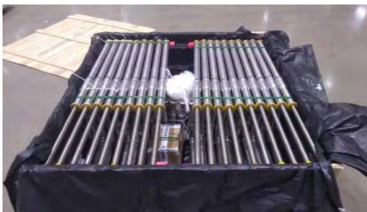
Figura 520: Trechos das linhas de luz embalados para envio para retrabalho na DEMACO
