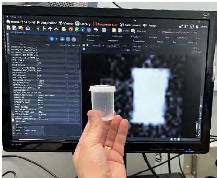
Figura 432: Primeira imagem (no computador) obtida pelo protótipo de MRI de um pote com solução de sulfato de cobre e cloreto de sódio, ao seu lado esquerdo.
