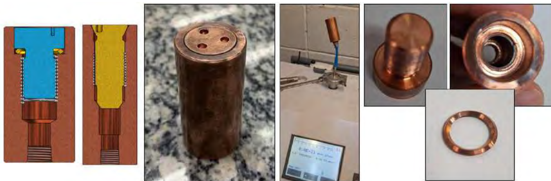
Figura 448: Protótipos para validação da vedação dos tampões dos canais de refrigeração da cavidade RFQ.
