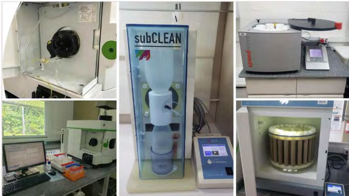
Figura 325: Equipamento ICP-OES e sistema para preparo de amostras no Laboratório Nano Ambiental
