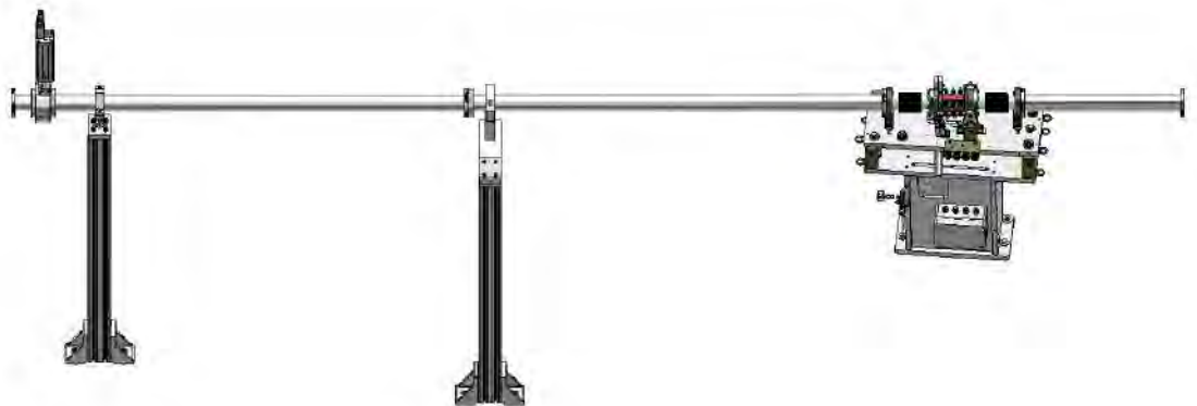
Figura 489: Modelo 3D de um trecho de pré front end com photon shutters.
