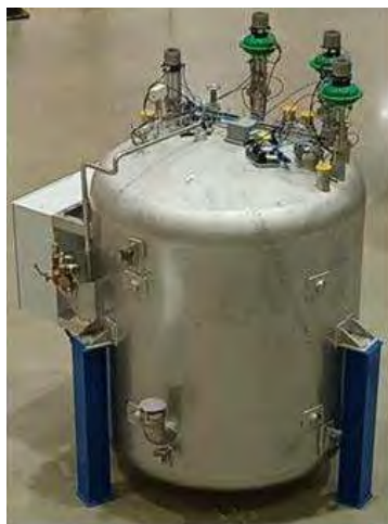
Figura 521: Separador de fases removido para envio para retrabalho na DEMACO
