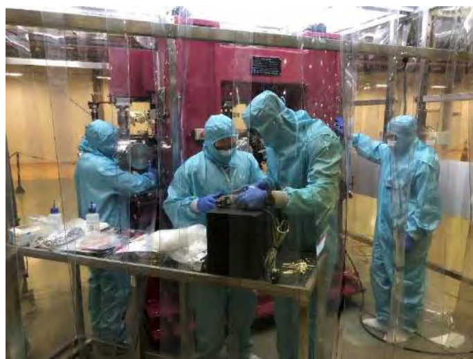
Figura 478: Montagem de bomba iônica e sensores no IVU EMA em ambiente controlado.
