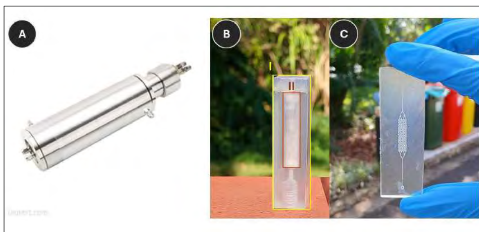
Figura 331 - (A) Core Holder comercial do tipo Hassler; (B) 1 – mini-core Holder 3D, com rocha artificial embutida; e (C) Chip microfluídico preenchido com carbonato de cálcio
