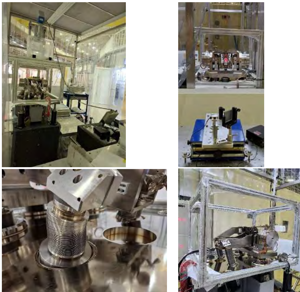
Figura 57: Testes de alinhamento com autocolimador a), principal técnica para colocar o espelho do monocromador alinhado com a gravidade; testes de movimentação b) com laser de alinhamento passando pela grade e espelhos dummy; c) novos foles em compressão quase que máxima para atender o range angular; e d) mecanismo aguardando início do condicionamento de vácuo.
