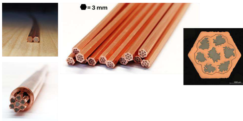
Figura 407: Primeiros fios multifilamentares produzidos contendo 7 monofilamentos de NbTi
