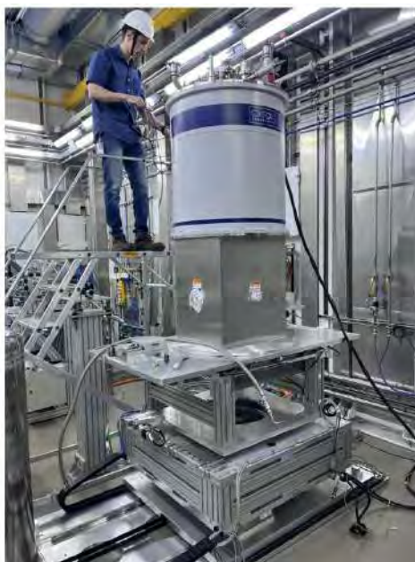
Figura 119: (A) Magneto supercondutor de 11T instalado na linha EMA
