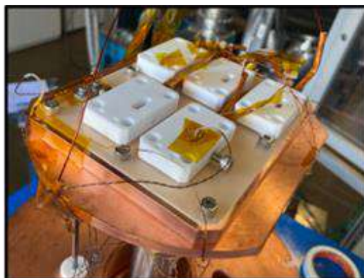
Figura 391: Splice box instalada no criostato vertical para a realização dos testes
