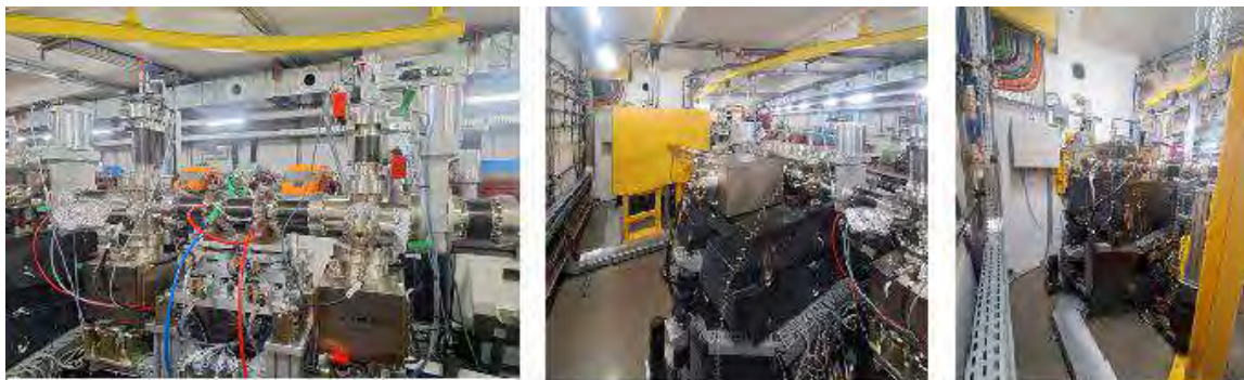
Figura 129: A figura mostra foto da fenda à esquerda, do espelho M1 ao centro e espelho M2 à esquerda. Todos os dispositivos foram instalados na região do FOE.
