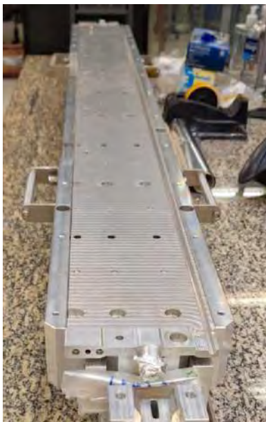
Figura 472: Câmara protótipo do VPU montada no gabarito em setup para deposição de filme NEG
