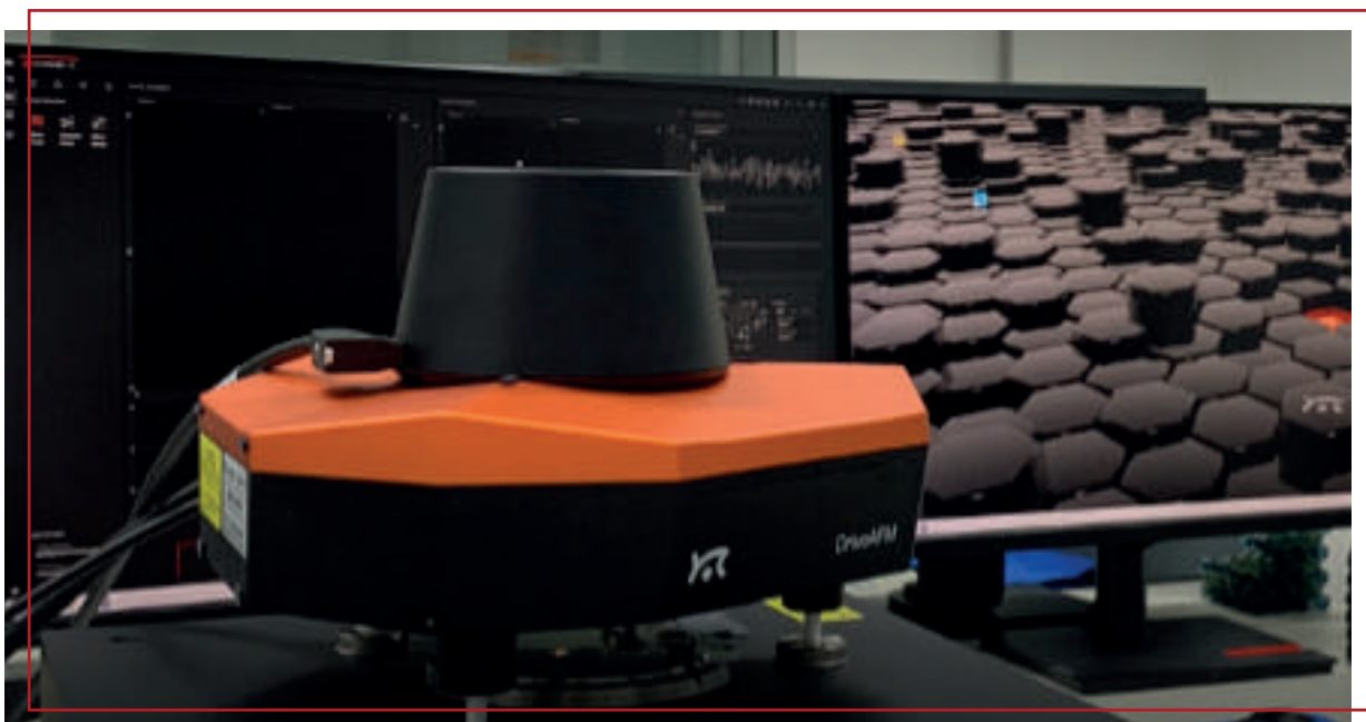
Figura 56: Microscópio de varredura por sonda modelo DriveAFM, do fabricante Nanosurf (Suíça) instalado no Laboratório de Microscopia de Força Atômica do LNNano.
