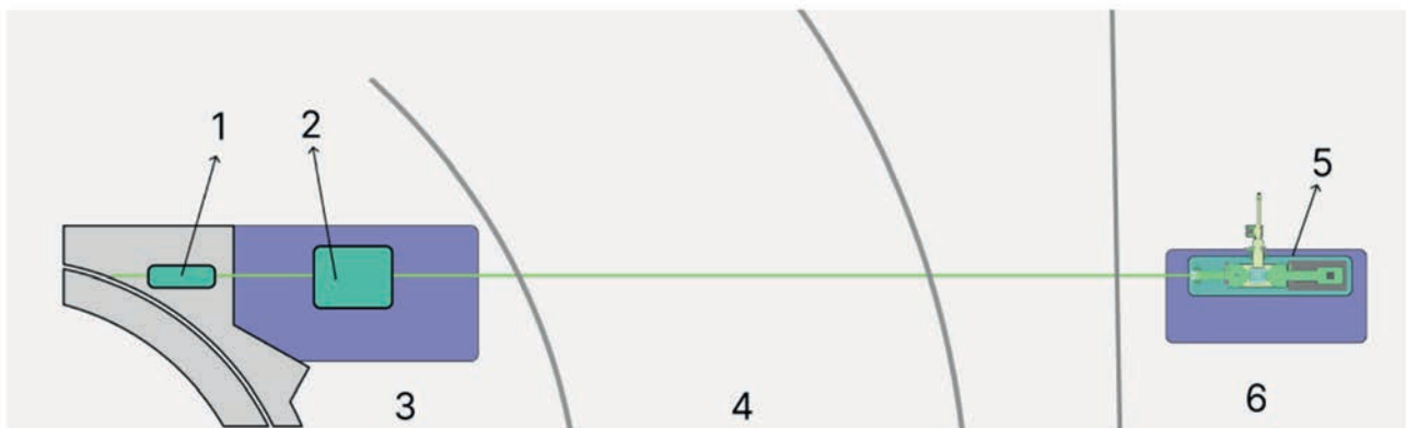
Figura 62 - Layout geral TIMBÓ e disposição dos prédios do Sirius e Orion. (1) Ondulador; (2) monocromador (DCM) dentro da cabana óptica; (3) piso de alta estabilidade do Sirius; (4) Hall experimental do Sirius; (5) estação experimental em nível de biossegurança 4; (6) prédio do Orion.
