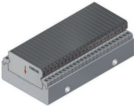
Figura 80. Subcassete superior com 6 períodos.
