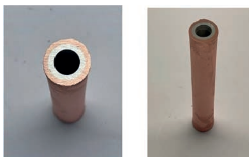
Figura 88. Amostra de alumínio após crescimento do filme de cobre.
