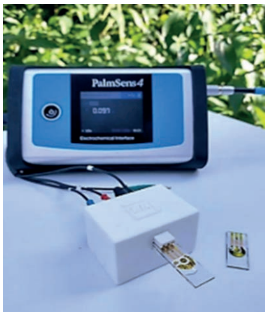
Figura 145 - Imagem do sistema eletroquímico miniaturizado para determinação de matéria ativa de produtos inibidores de incrustação e determinação de residuais em amostras de água produzida.
