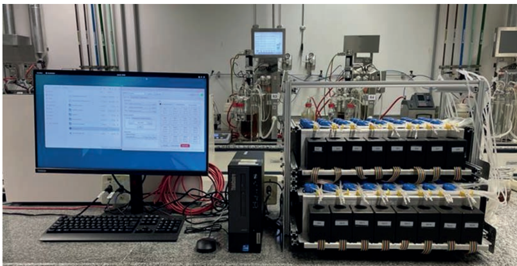
Figura 79. Protótipo de sistema automatizado, customizável e modular para evolução adaptativa em condições de crescimento controladas e com a manutenção de culturas em fase exponencial.
