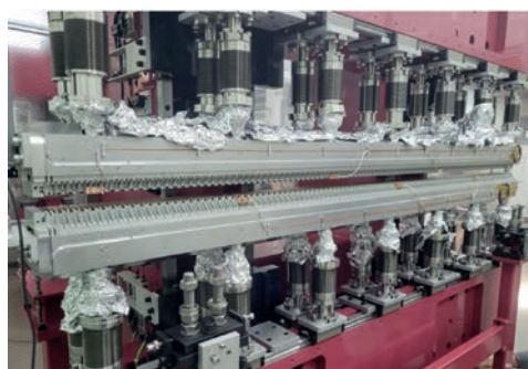
Figura 85. Imagem de Ondulador IVU em processo de montagem
