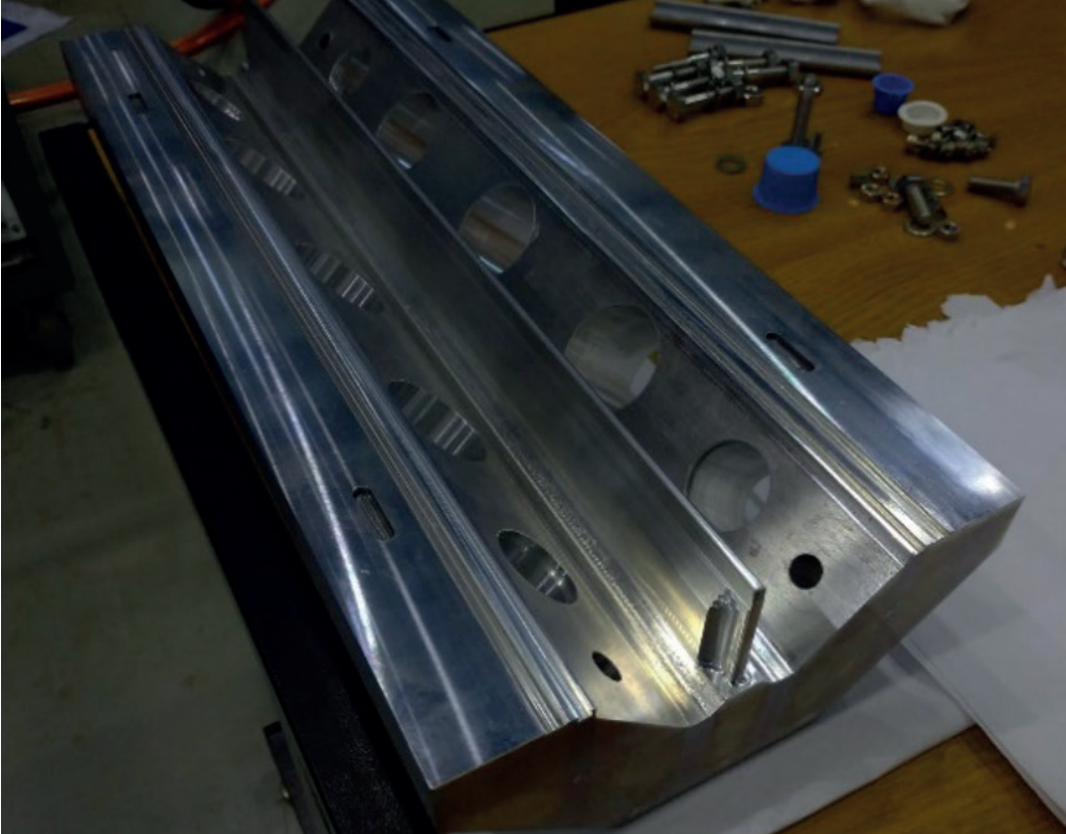
Figura 43. Peça inferior da cavidade usinada em tamanho reduzido como um primeiro teste de processos de usinagem.
