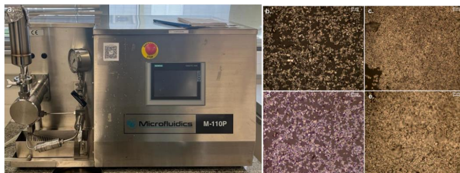
Figura 1. Microfluidizador utilizado no processo (a). Imagens óticas obtidas no início e no final do processo com (a-b) e sem surfactante Tween 20 (c-d).
