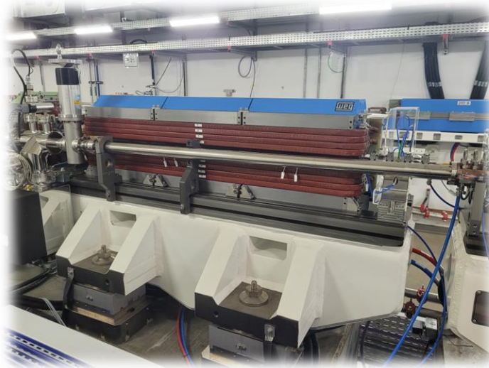
Figura 1: Foto de um dos dipolos B2 da rede magnética do Sirius.
