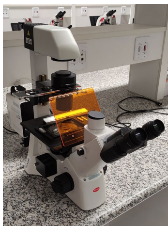
MICROSCÓPIO TRINOCULAR INVERTIDO MOTIC, MODELO AE31 E (30W)
