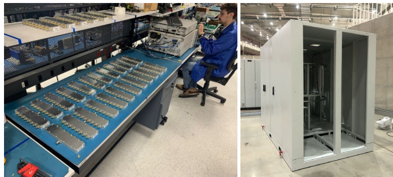
Produção e testes dos divisores 1:10 (esquerda) e primeiro gabinete para o amplificador de 60 kW, com a estrutura do circuito hidráulico em seu interior (direita).
