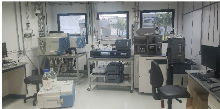
Figura 4: Sala de espectrometria de massas à cromatografia líquida após a reforma , com melhorias no sistema de gases e de controle de temperatura e com o novo espectrômetro de massas já instalado (os dois equipamentos da direita no fundo da sala).
