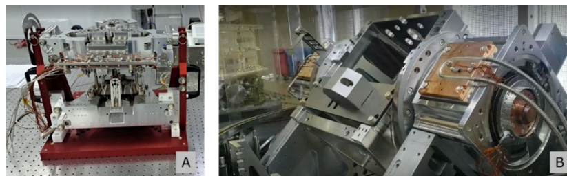
Figura 8 - Monocromador da linha SAPUCAIA em montagem. A: mecanismo interno que comportam os cristais durante teste em bancada; B: câmara com atuador rotativo durante teste de controle
