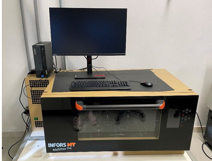
Figura 2. Equipamento Cell Growth Quantifier .
