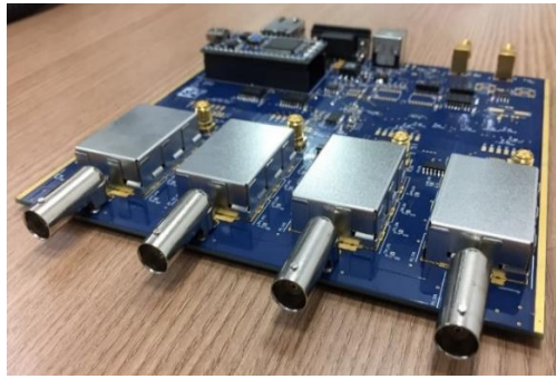
Figura 63: Esquerda: eletrônica digital de 4 canais para medições de correntes de baixa intensidade. Direita: densidade espectral de ruído obtida nas oito escalas de medida.
