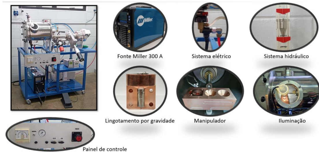
Figura 298. Resumo das adequações e melhorias realizadas no ano de 2023 no forno a arco elétrico do CNPEM
