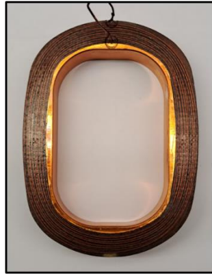
Figura 292. 2ª Bobina Lateral de NbTi fabricada no CNPEM.
