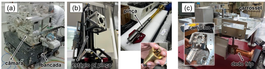
Figura 47: Subsistemas da estação experimental SAPOTI em montagem no prédio da Metrologia no CNPEM: (a) câmaras de vácuo montadas sobre bancada de granito; (b) subsistema de pinça criogênica; e (c) carrossel para armazenamento de amostras em cartuchos criogênicos na câmara de carregamento.
