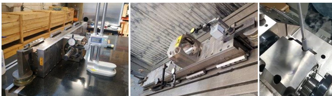
Figura 314. Processo de pinagem dos porta castanhas dos cassetes do DU525.
