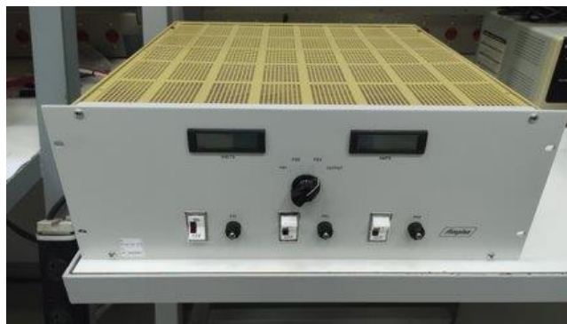
Figura 350. Fonte que alimenta as eletrônicas de BPM
