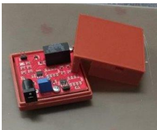
Figura 353. Placa da eletrônica de detecção de vazamento
