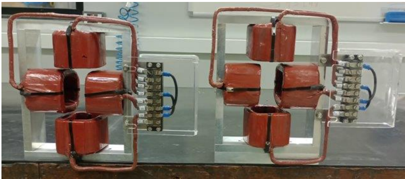
Figura 337. Corretoras horizontais e verticais do ondulador PAPS.
