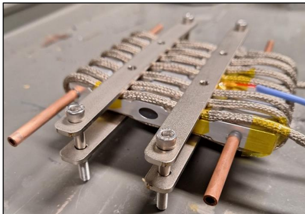
Figura 341 Figura 341 apresenta um corpo de prova com setup de baking em que foi realizada a união dos materiais utilizando a Duralco.
