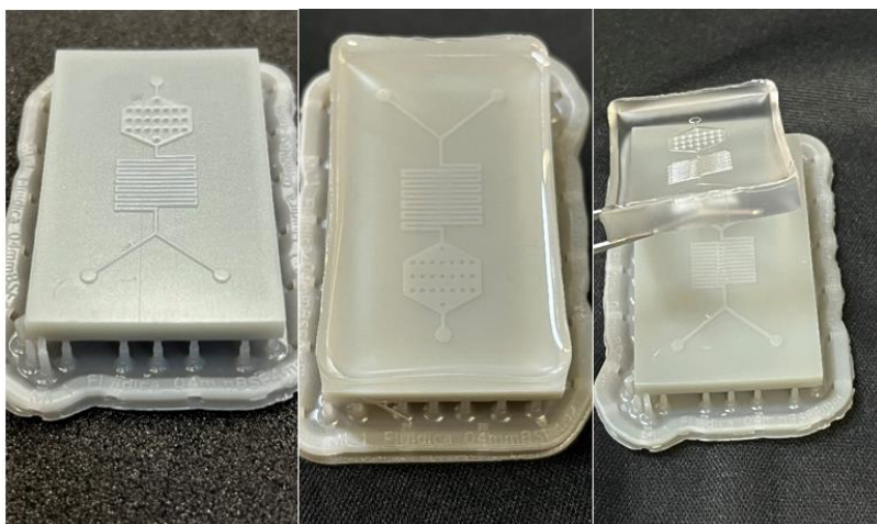
Figura 244. Detalhes do molde para fabricação de um misturador microfluídico obtido em resina por impressão 3D, pela técnica SLA. Na sequência da imagem podemos observar o dispositivo em PDMS já curado e sendo removido do molde, sem causar dano ao mesmo
