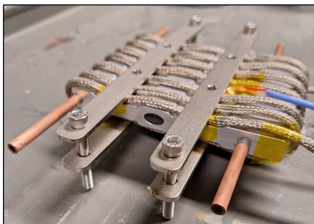
Figura 341. Corpo de prova de alumínio com tubo de refrigeração fixado com Duralco™132.
