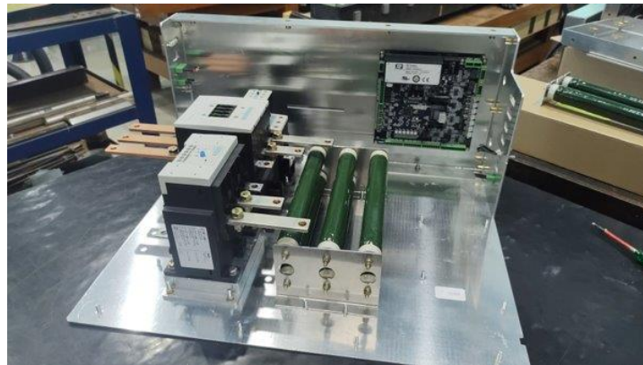
Figura 349. Montagem parcial de um bastidor da gaveta de comando
