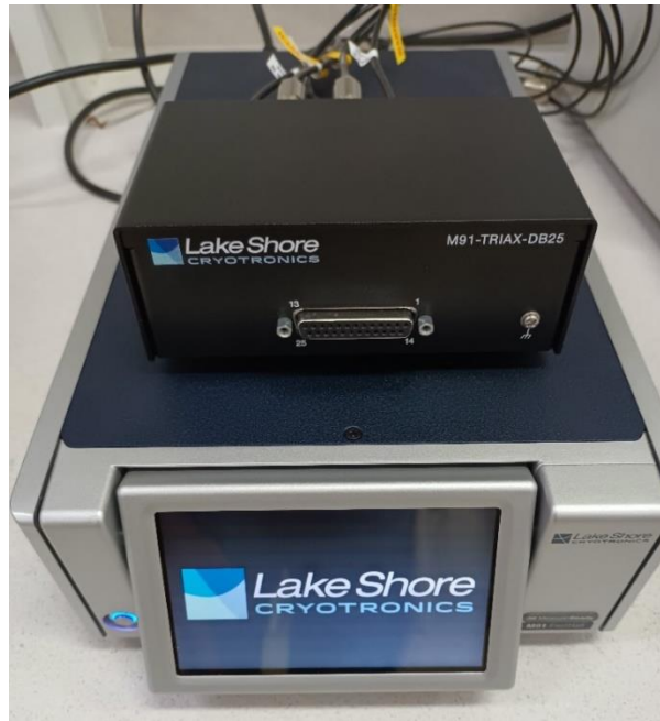
Figura 260. Sistema de medidas de efeito Hall da LakeShore modelo FastHall M91
