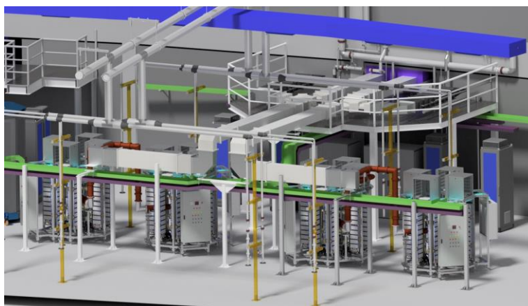
Figura 306. Projeto de instalação dos componentes do sistema de RF na sala de RF do Sirius
