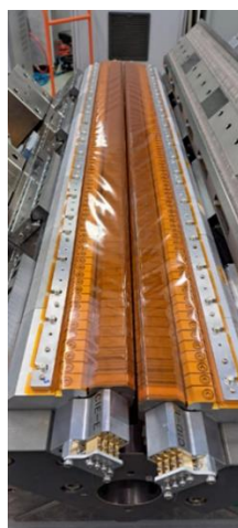
Figura 329. Filmes de Kapton montados nos cassetes do ondulador para diminuir o atrito com a câmara de vácuo.
