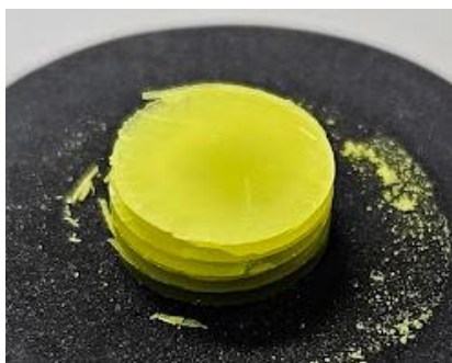
Figura 359. Amostra de YAG após o processo de sinterização
