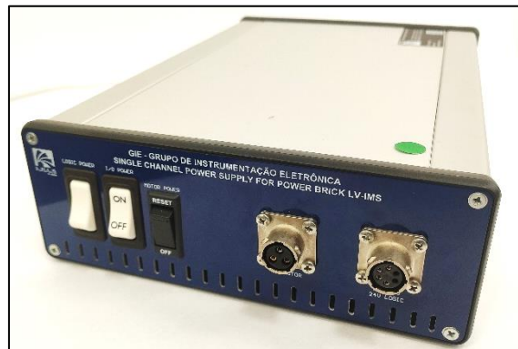
Figura 64: Esquerda: Fonte de alta tensão com capacidade de gerar até 5 quilovolts e 1 miliampere. Direita: Fonte de alimentação para controladores de motor das linhas de luz do Sirius.
