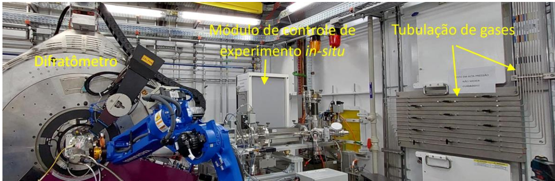
Figura 98: Imagem da cabana experimental da Paineira mostrando as linhas de gases e o módulo de controle de experimentos in situ instalados próximo ao difratômetro.
