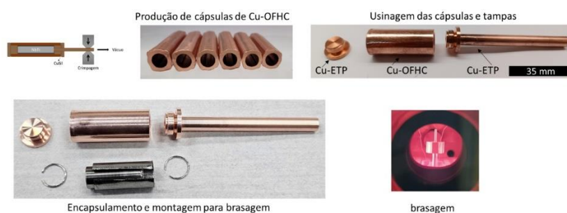
Figura 300. Procedimentos de montagem e brasagem desenvolvidos pelo CNPEM de cápsulas de Cu-OFHC contendo lingote cilíndrico de NbTi e uma barreira de fusão de Nb.
