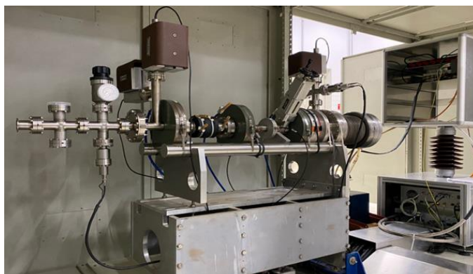
Figura 83: Bancada de testes do canhão de elétrons de 80 kV.
