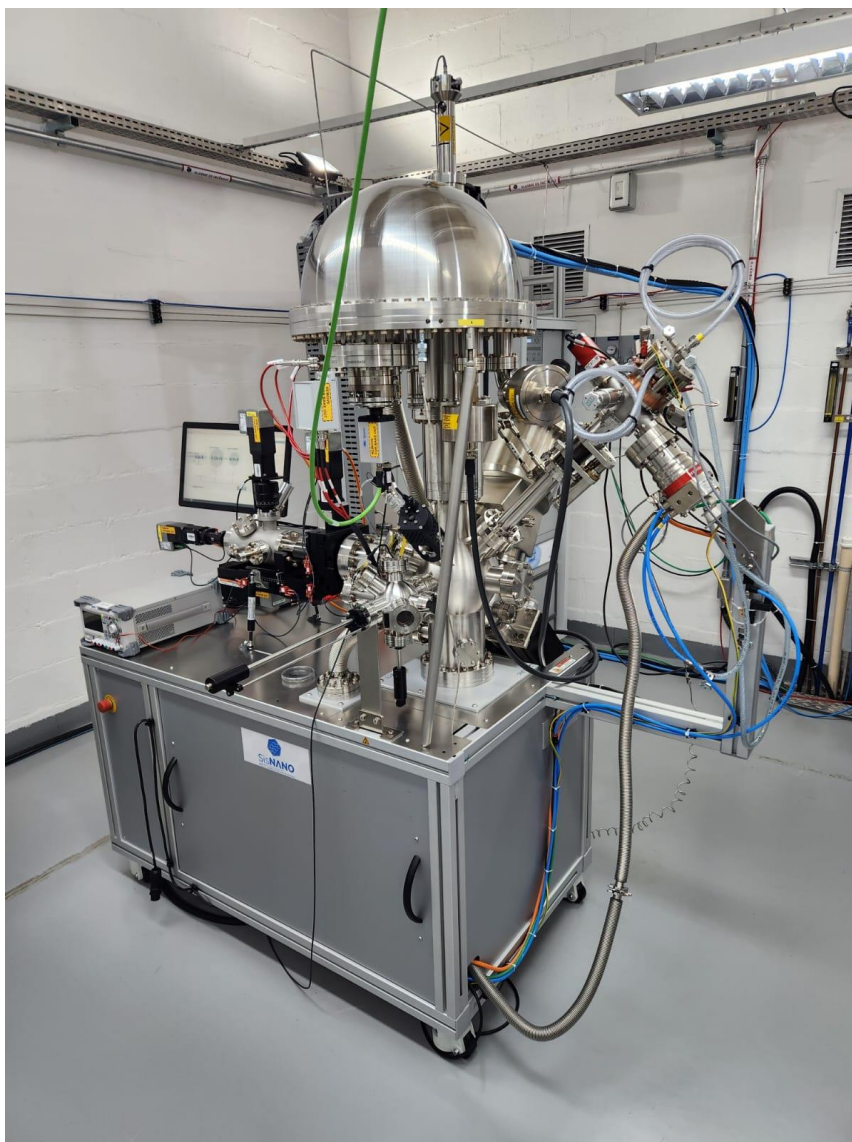
Figura 262. Espectrômetro de fotoelétrons por Raios-X (XPS) e UV (UPS) da SPECS, instalado em fevereiro de 2023 e que está em fase final de comissionamento
