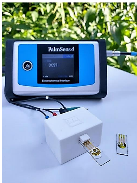
Figura 265 - Imagem do sistema eletroquímico miniaturizado para determinação de matéria ativa de produtos inibidores de incrustação e determinação de residuais em amostras de água produzida
