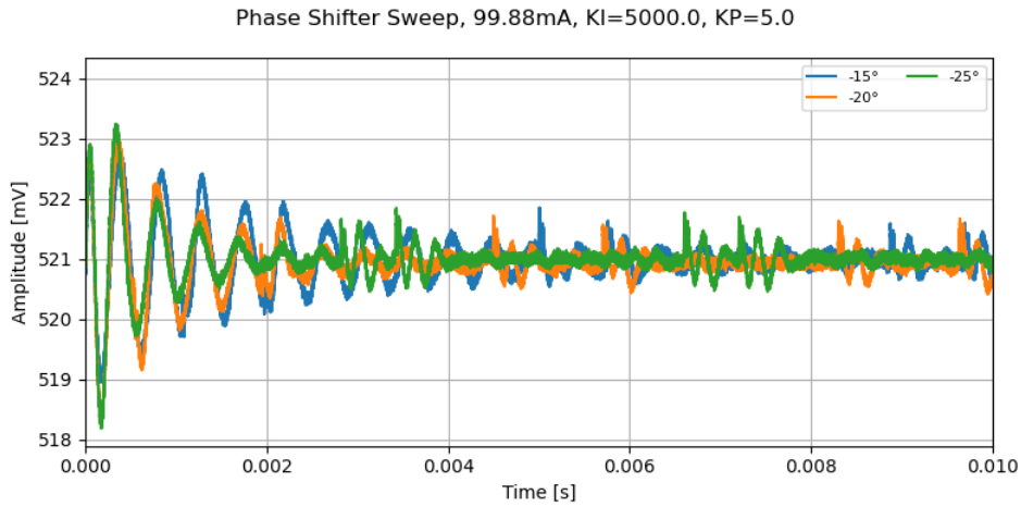
Figura 18: Sinal de amplitude na cavidade em resposta a um degrau em fase com feixe de elétrons em 100mA. Em azul o sinal quando o defasador estava em -15^\circ , em laranja quando o defasador estava em -20^\circ e em verde quando o defasador estava em -25^\circ . Vemos que neste ultimo caso, o tempo de decaimento é menor que os outros, mostrando uma melhor atuação do sistema de controle.
