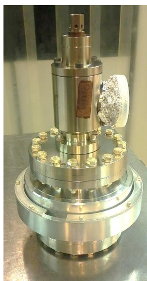
Figura 308. Bellows pronto para instalação da cavidade supercondutora
