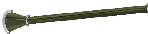
Figura 311. Trecho de vácuo para cenário com operação de apenas um módulo da cavidade
