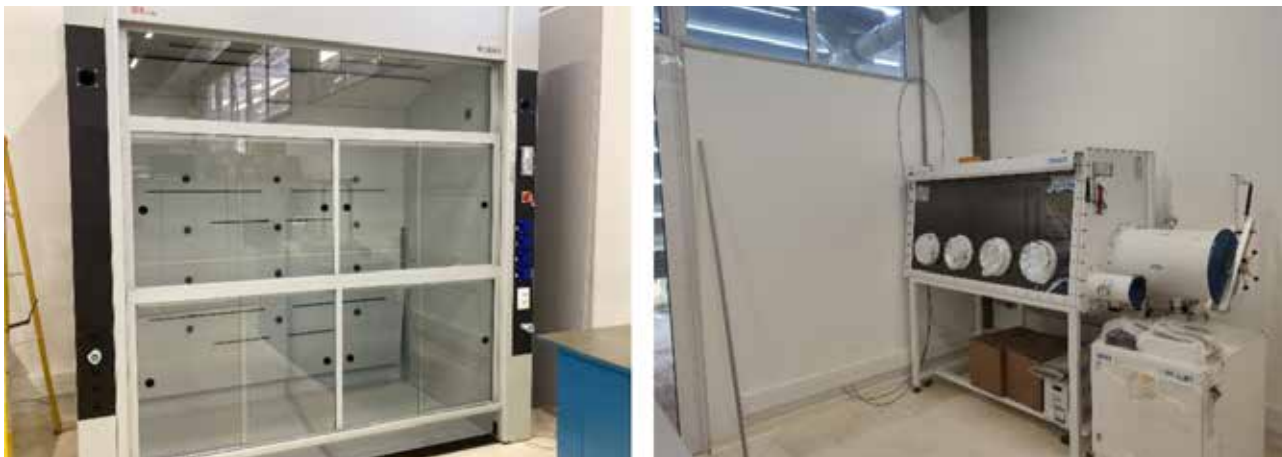
Figura 88: Capela Walk-in onde o experimento e o operador trabalham com exaustor ativo (esquerda); Glovebox para amostras sensíveis, pode ser usada por até 2 pessoas (direita).
