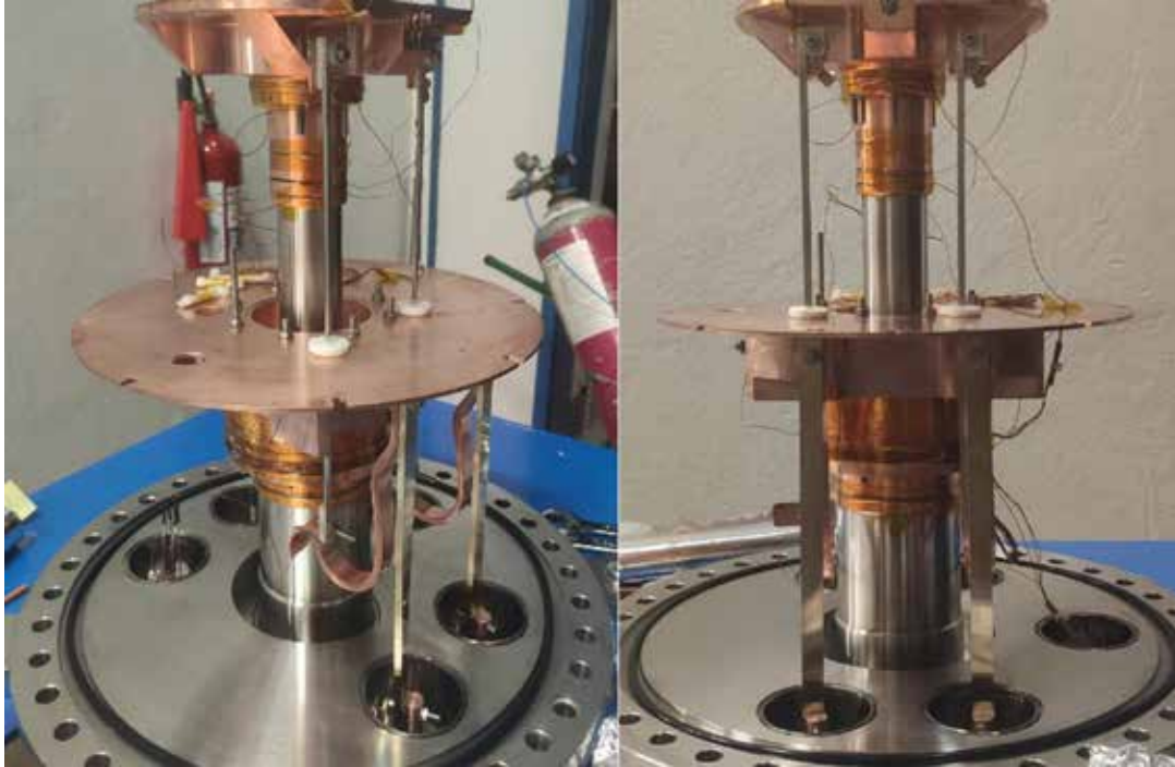
Figura 22 - Conceito das current leads do SWLS instaladas no criostato vertical.
