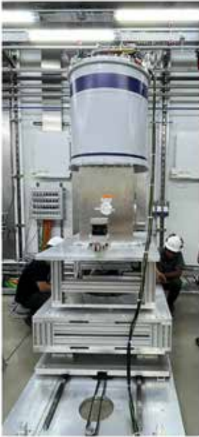
Figura 70: Foto do ima supercondutor de 11T instalado na linha EMA.
