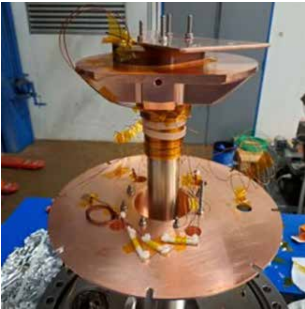
Figura 25 - Criostato vertical durante montagem do teste da primeira bobina supercondutora.
