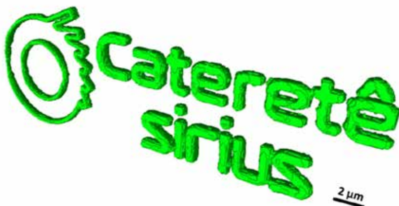
Figura 69: Reconstrução tridimensional da imagem do espaço real obtida pelo método CDI implementado na linha de luz de espalhamento coerente do Sirius. O objeto tem 25 micrometros de largura e resolução de 156 nanômetros.
