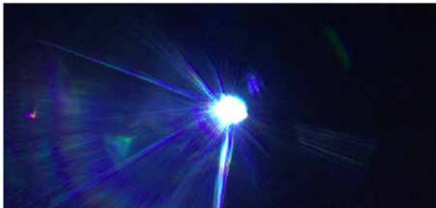
Figura 76: Feixe síncrotron visualizado na janela de saída da linha Cedro após ajuste de janela óptica.
