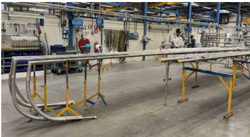
Figura 44 - Trechos do anel de distribuição de nitrogênio fabricados
