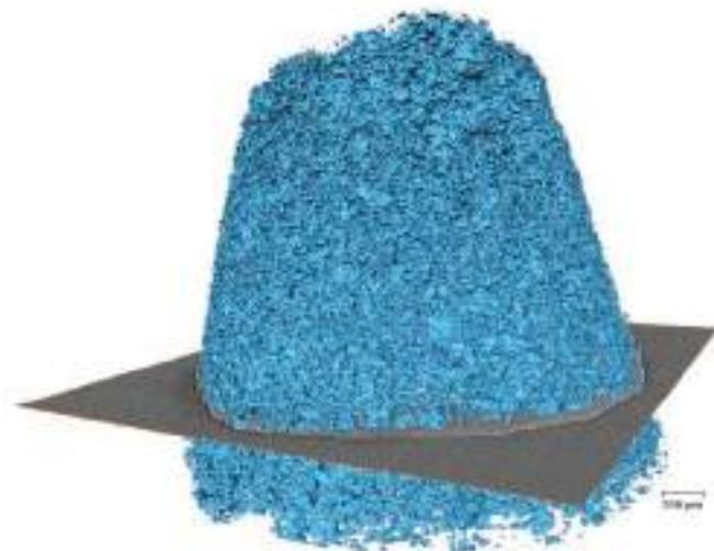
Microtomografia síncrotron de uma rocha do pré-sal fornecida pela Petrobras, em imagem produzida na linha de luz Mogno, do Sirius
