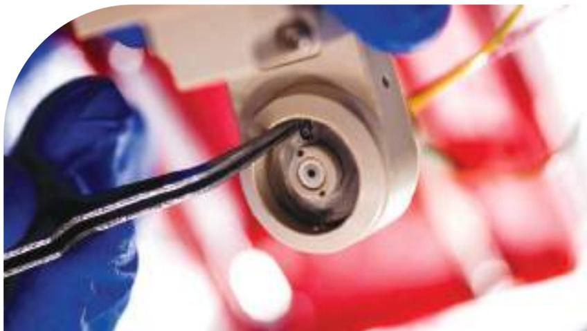
Célula eletroquímica miniaturizada projetada para atender experimentos in situ e in operando em sistemas eletroquímicos utilizando técnicas avançadas de síncrotron
