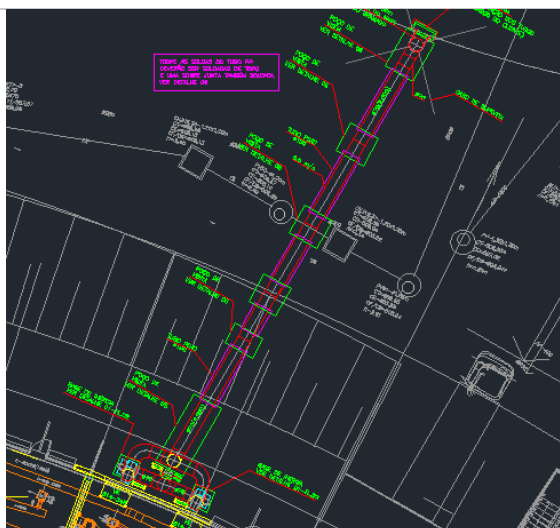
Figura 8 - Vista superior do duto enterrado no talude
