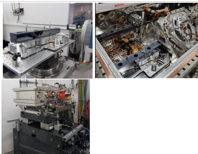
Figura 19 - Espelho M2 do conjunto KB sendo medido no sistema FZI no laboratório de metrologia óptica (à esquerda), conjunto KB totalmente montado dentro da câmara de vácuo (meio), e câmara de vácuo do KB totalmente montada na base de granito na estação experimental (à direita)
