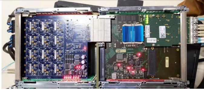
Figura 2 - Figura 4. Hardware do controlador das corretoras rápidas. Esquerda: placa RTM-LAMP. Direita: placa AFC-FOFB com placa mezanino FMC-4SFP+ acoplada (canto superior direito)
