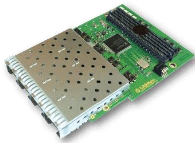
Figura 4 - Placa mezanino para conversores optoeletricos (FMC-4SFP+)
