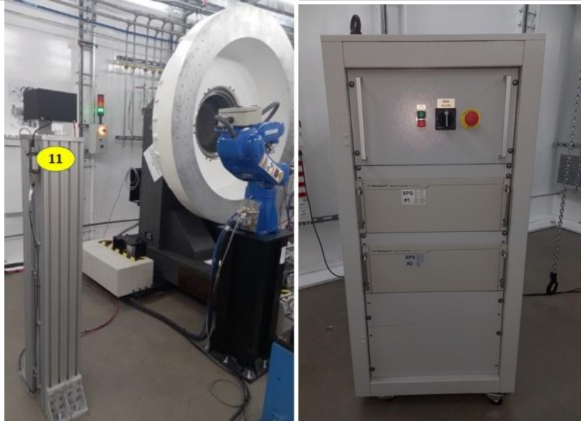
Figura 52 - Imagens do suporte com o “olho de raios X” instalado no topo (11) e do sistema de controle do difratômetro Newport da Paineira.
