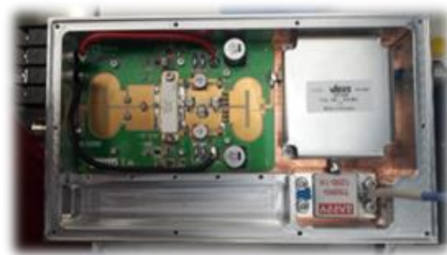
Figura 6- Blindagem com base de cobre
