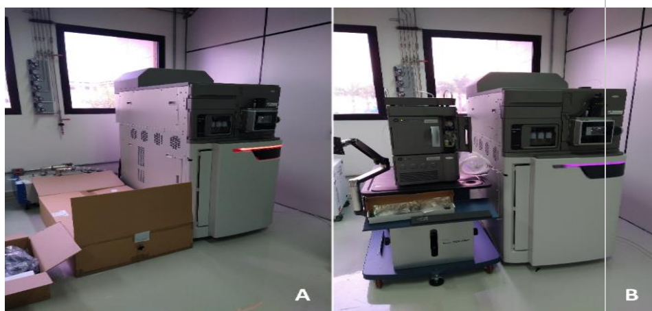
Figura 10: Instalação e verificação de comunicação entre os equipamentos. Início (A) e finalização (B) do processo (a luz lilás indica uma comunicação efetiva entre o cromatógrafo, o espectrômetro de massas e a workstation).
