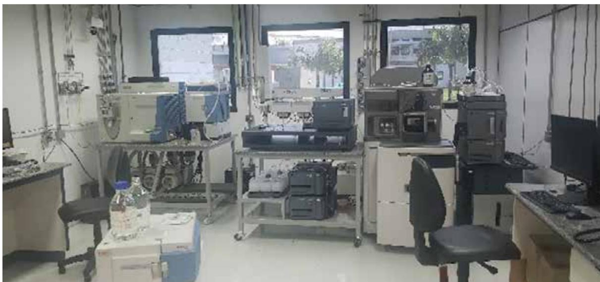
Figura 14 - Sala de espectrometria de massas à cromatografia líquida após a reforma, com melhorias no sistema de gases e de controle de temperatura e com o novo espectrômetro de massas já instalado (os dois equipamentos da direita no fundo da sala)
