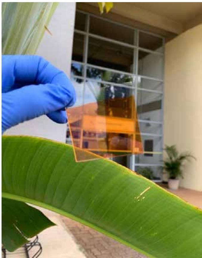
Figura 3. Foto ilustrativa de um dos principais componentes do dispositivo fotoeletroquímico utilizado para geração dos gases H<sub>2</sub> e O<sub>2</sub>. Este componente fabricado no LNNANO via deposição de uma solução contendo óxido de ferro capaz de absorver luz do sol e na presença de água, e em conjunto com germânio, realizam as reações químicas de quebra da molécula da água gerando o hidrogênio verde (livre de carbono) e o oxigênio.
