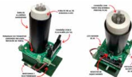
Figura 15 - Protótipo de sistema automatizado, customizável e modular para evolução adaptativa em condições de crescimento controladas e com a manutenção de culturas em fase exponencial
