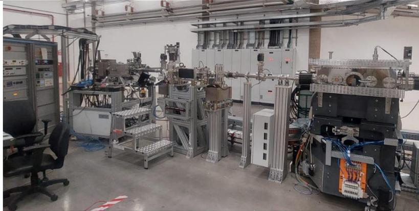
Figura 42 - Visão geral da estação experimental Photoemission Electron Microscopy, PEEM, da linha SABIA. O microscópio em si é o equipamento à direita dos racks eletrônicos.
