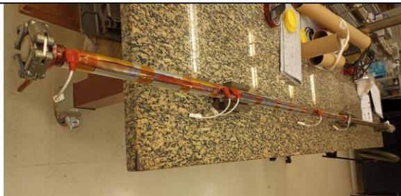
Figura 20 - Câmara de vácuo do wiggler sendo preparada para o baking).
