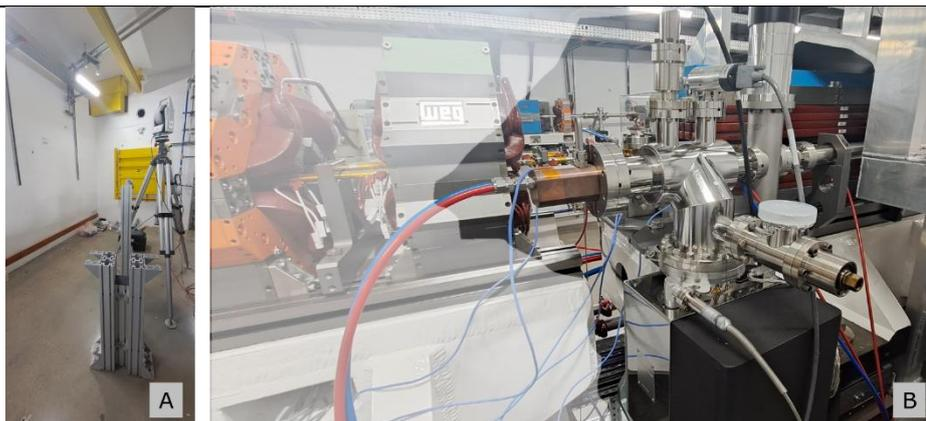
*Figura 10 - Trecho final da região do Front-End da linha SAPÊ aguardando instalação de equipamentos (A) e trecho inicial temporário contendo bomba de vácuo e bloco de cobre que bloqueia a passagem dos Raios-X*
