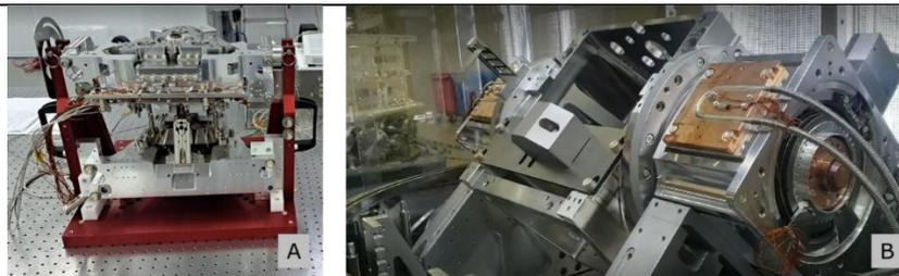
*Figura 32 - Monocromador da linha SAPUCAIA em montagem. A: mecanismo interno que comportam os cristais durante teste em bancada; B: câmara com atuador rotativo durante teste de controle*
