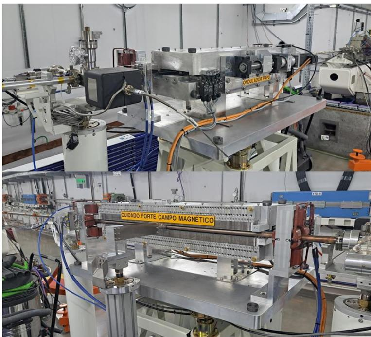
*Figura 31 - Ondulador PAPU instalado para linha SAPUCAIA.*
