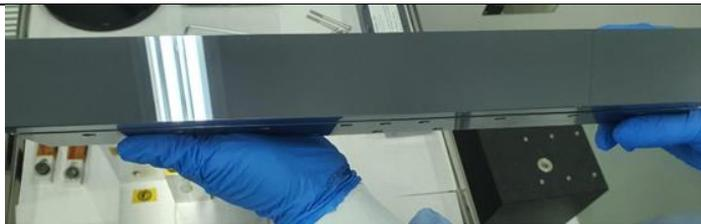
*Figura 13 - Espelho cilíndrico M1 em inspeção no laboratório de metrologia óptica*
