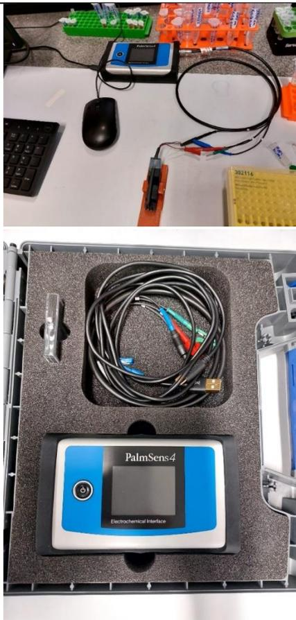
Figura 81 - Potenciostato Palmsens4 Galvanostato
