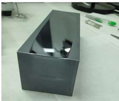
*Figura 14 - Espelho elipsoidal M3 em inspeção no laboratório de metrologia óptica.*
