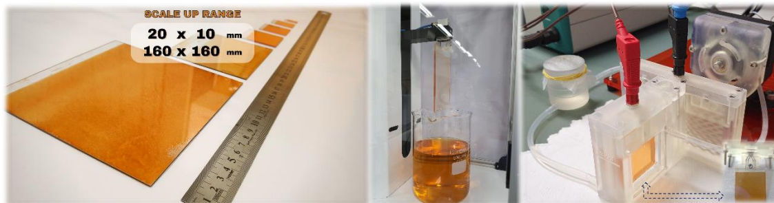
Figura 319. (Esquerda) Imagem que representa a versatilidade do método para fabricação de materiais com diferentes dimensões, (Central) Foto ilustrando o sistema de deposição de soluções por imersão, exemplo da fabricação de um fotoanodo de óxido de ferro e (Direita) Imagem que ilustra a estação de caracterização fotoeletrolítica para avaliar materiais com área de até 5 cm 2 .
