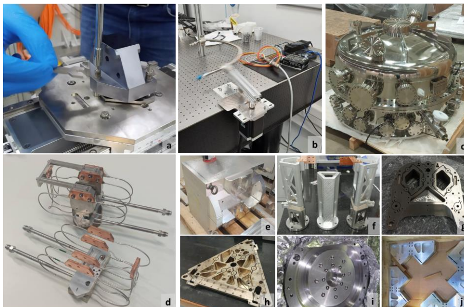
Figura 8: Montagem de cristal para medição de assimetria de planos cristalinos executada em estação experimental da linha EMA (a), teste de fadiga em mangueira corrugada para nitrogênio líquido (b), chegada da câmara de vácuo (c), circuitos internos de refrigeração por LN2 (d) e exemplos de peças usinadas (e-j).
