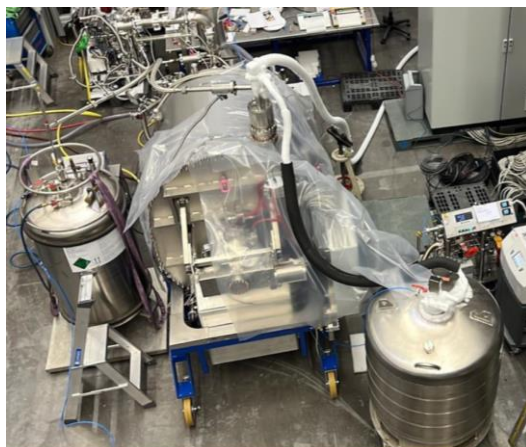
Figura 386 - Criomódulo 02 sendo abastecido com hélio líquido para os testes de aceitação na Research Instruments, fabricante das cavidades supercondutoras do Sirius.
