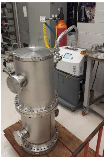
Figura 382 – Teste de leak na câmara de vácuo do criostato vertical.
