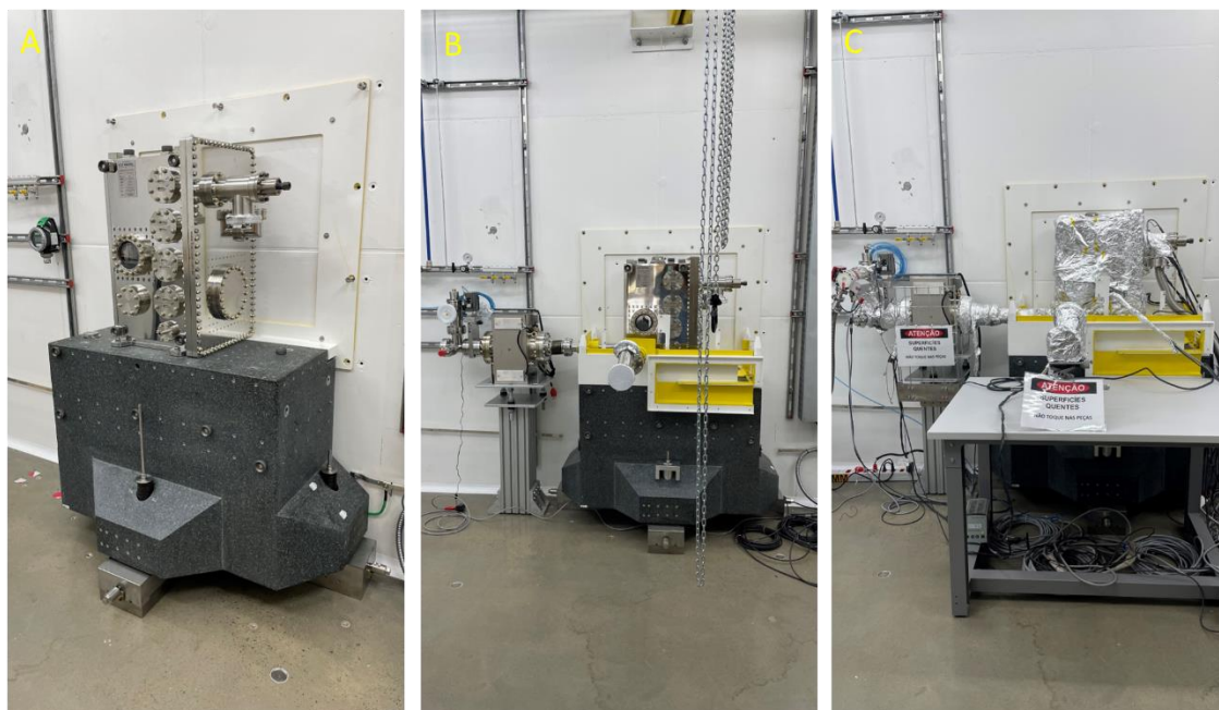
Figura 133. A: Posicionamento da câmara no granito. B: Conexão com a bomba iônica. C: Montagem do baking.
