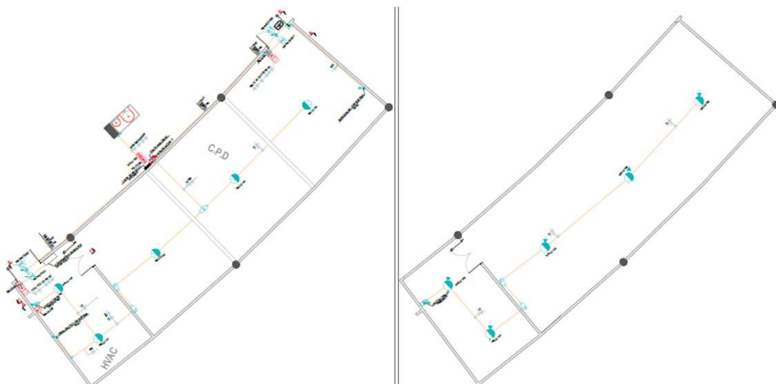
Figura 459 – Planta baixa do sistema de detecção do ambiente do CPD e sala de HVAC
