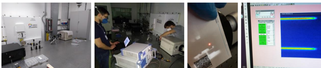
Figura 502 – A partir da esquerda, as duas primeiras fotos mostram streak camera posicionada sobre a bancada ótica da linha Imbuia e o início dos testes e alinhamento. A terceira figura mostra o feixe focalizado sendo obstruído por um anteparo, na entrada do equipamento. Na foto à direita o software de operação exibe as esperadas duas linhas horizontais que indicam correto funcionamento da varredura, quando os eixos vertical e horizontal estão operando corretamente.
