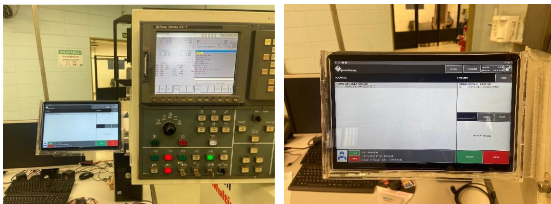
Figura 134 – Tablet de Apontamento de horas no torno CNC, com software GRV acoplado.
