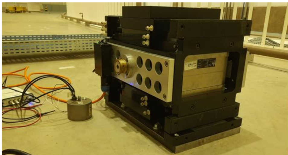
Figura 446 – Shaker modelo APS 420 simulando a vibração da Cold Box
