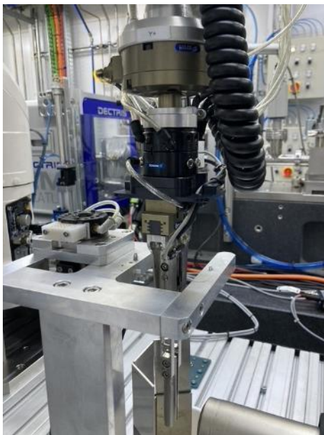
Figura 189. Braço robótico com garra na posição de secagem.
