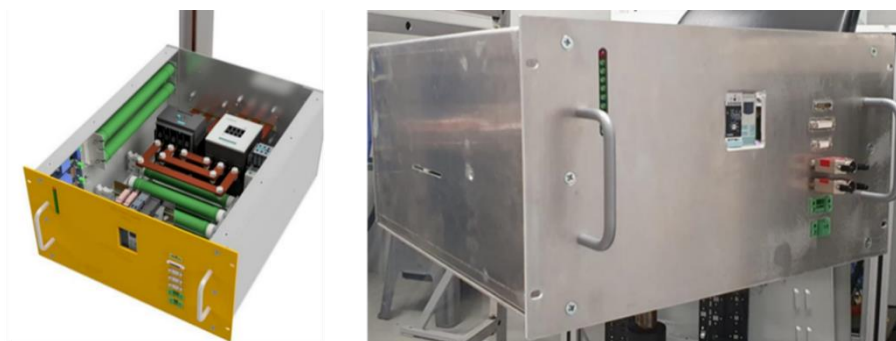
Figura 504 – Projeto mecânico 3D da nova gaveta de comando (esquerda) e protótipo operacional (direita).
