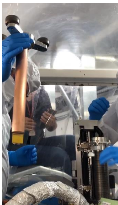
Figura 20: Processo de instalação do espelho M1 dentro do anel de armazenamento.
