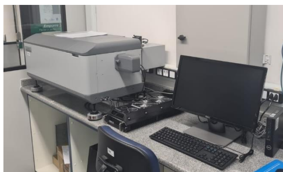
Figura 231. Espectro-polarímetro Jasco, modelo J-1500, com capacidade para medidas de dicroísmo circular e fluorescência de biomoléculas
