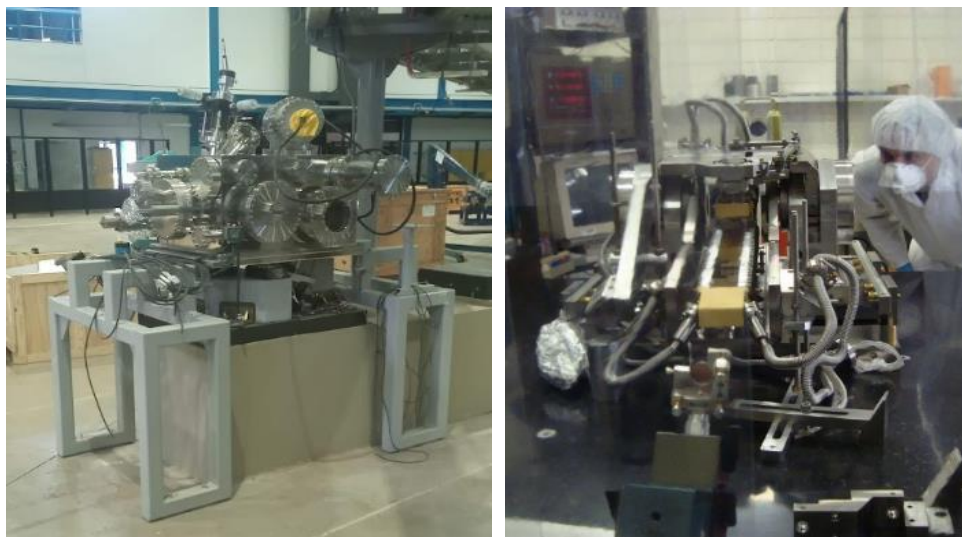
Figura 13: O UVX-PGM montado na UVX e durante o processo de alinhamento do PGM em 2010.
