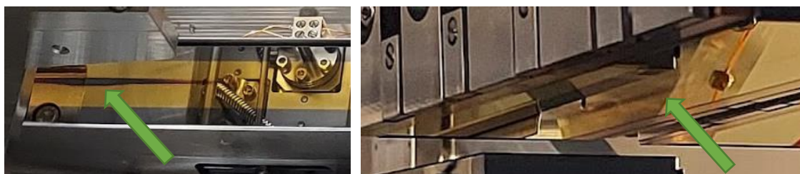
Figura 46: Pegada de carbono na óptica PGM: IPE-M1 (esquerda) e IPE-GR (direita).
