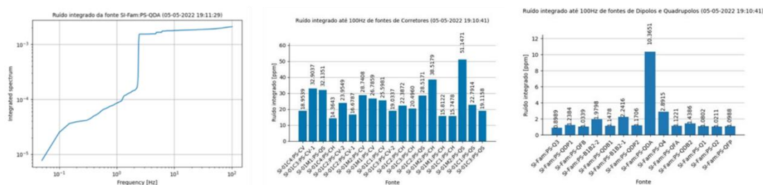
Figura 509 – Espectro de ruído integrado da fonte QDA (esquerda). A comparação do ruído integrado para diversas fontes de corretores do Sirius (centro) mostra o ruído integrado médio da ordem de 25 ppm em relação ao fundo de escala das corretoras. Também apresentado o ruído integrado de várias fontes de alta potência, dipolos e quadrupolos (direita), que é sempre menor que 10 ppm. Todos os valores de ruído atendem às especificações de ripple das fontes de corrente.
