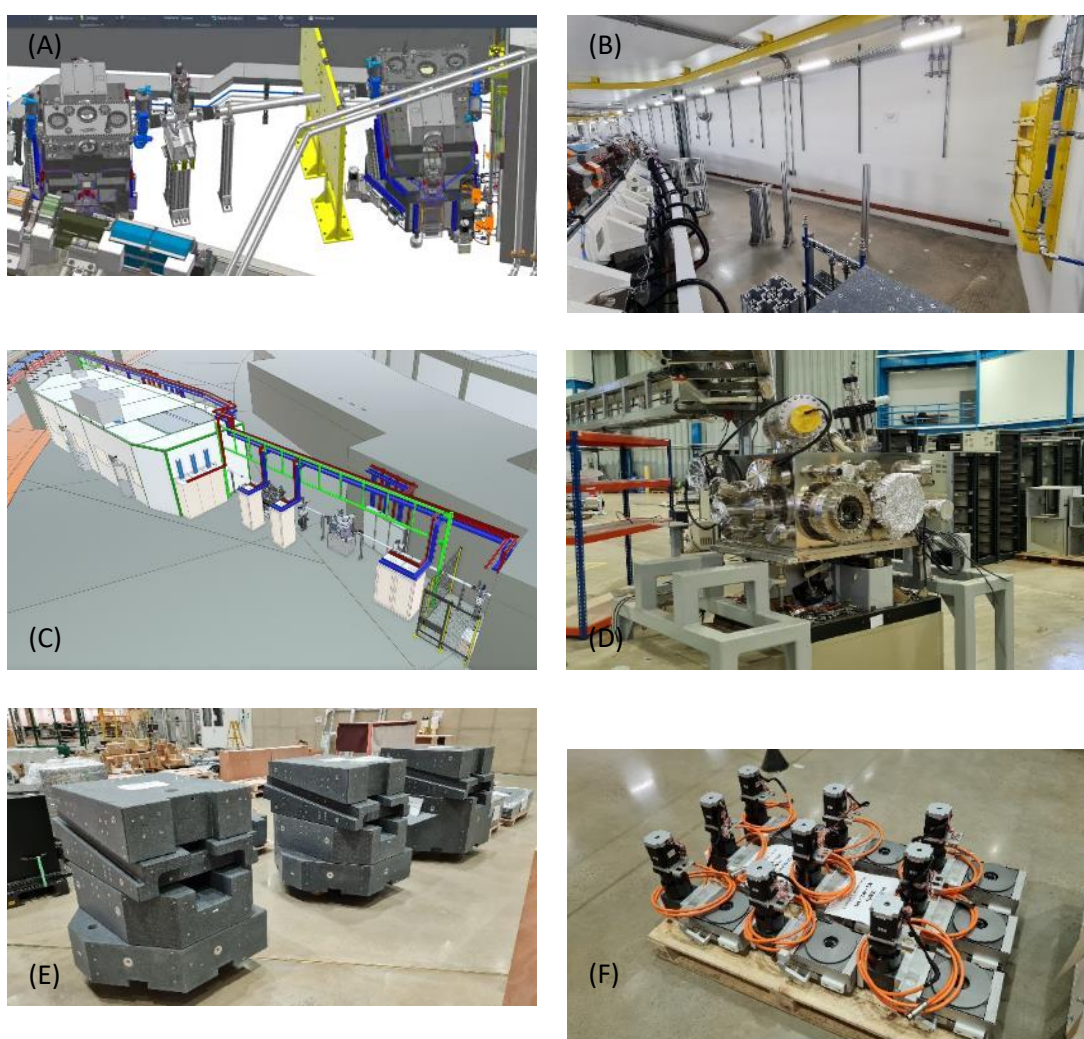
Figura 144: (A) Projeto inicial do front-end; (B) estado atual da instalação do front-end; (C) projeto integrado básico de infraestrutura; (D) monocromador da linha PGM do anel UVX; (E) bases de granito dos 3 sistemas de espelho da linha SAPÊ; (F) niveladores das bases de granito.
