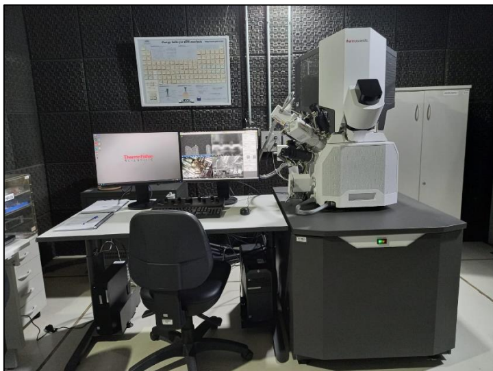
Figura 356. Microscópio eletrônico de duplo feixe Thermo Fisher Scientific Scios 2 instalado no LNNano.
