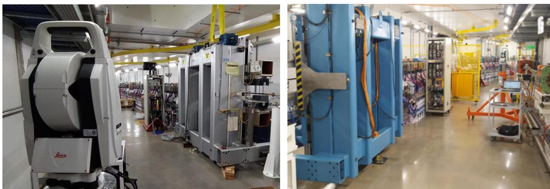
Figura 497 – Alinhamento Wiggler STI (esquerda) e Alinhamento EPU (Direita)
