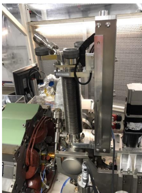
Figura 20: Processo de instalação do espelho M1 dentro do anel de armazenamento.
