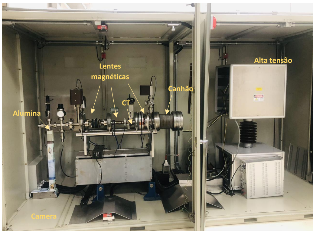
Figura 550 – Montagem finalizada da bancada de testes do canhão de elétrons, mostrando à esquerda o canhão, o trecho de focalização e a montagem da câmara, e à direita os racks de instrumentação.
