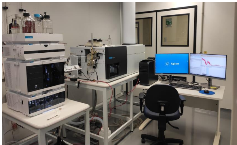
Figura 230 - Equipamento Agilent 6545XT AdvanceBio LC/Q-TOF, acoplado ao sistema de cromatografia líquida Infinity II.
