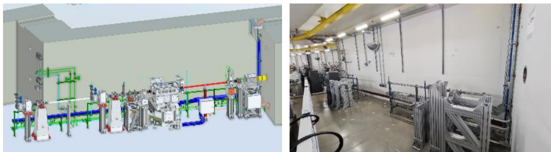
Figura 150: (Esqueda) Projeto integrado do front-end da linha JATOBÁ com espelho toroidal M1. (Direita) Situação da execução do front-end em junho de 2022.
