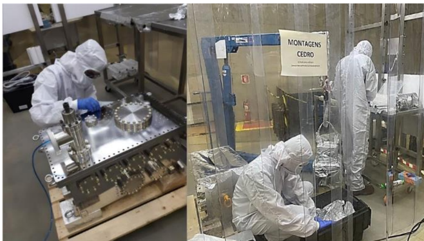
Figura 131 Pré-montagem da câmara de espelhos (junho 2022).
