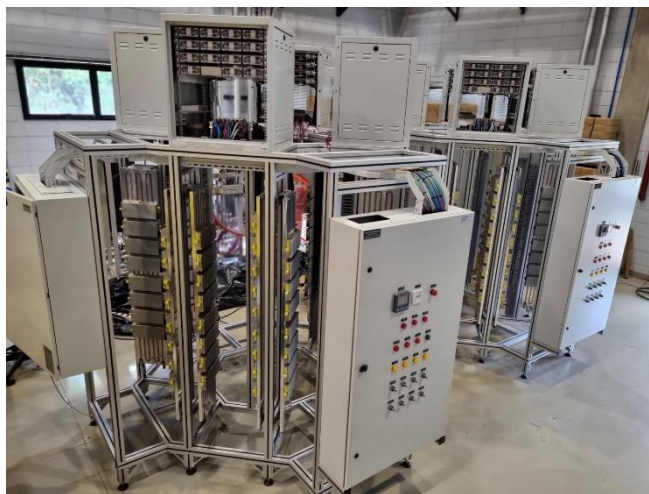
Figura 399 – Amplificadores em fase de montagem no laboratório de RF
