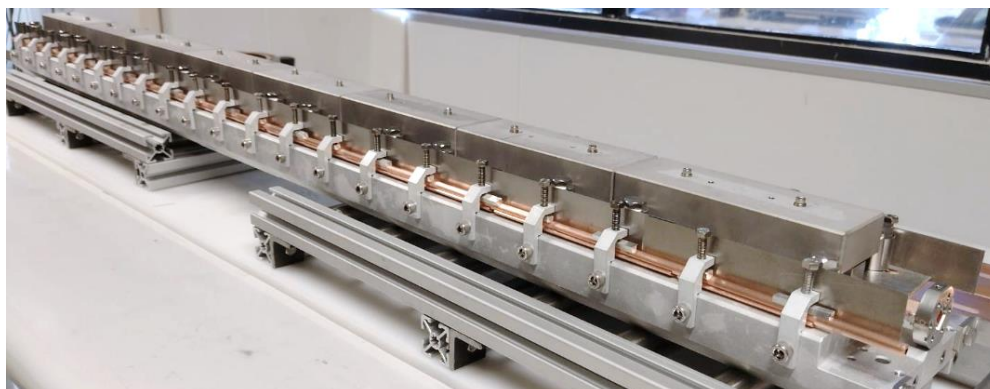
Figura 431 – Dispositivo de brasagem desenvolvido para a solda do sistema de refrigeração do DU220
