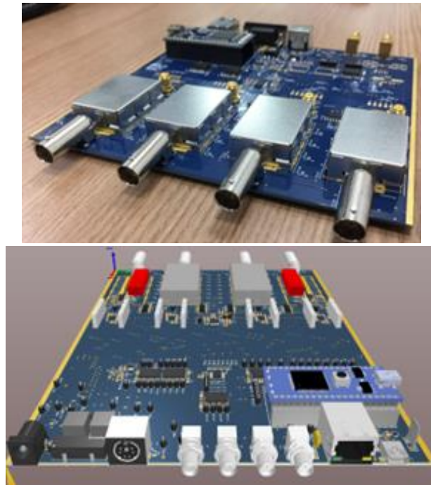
Figura 70 - Protótipo (esq.) e modelo 3D (dir.) do Projeto final do picoamperímetro de 4 canais.
