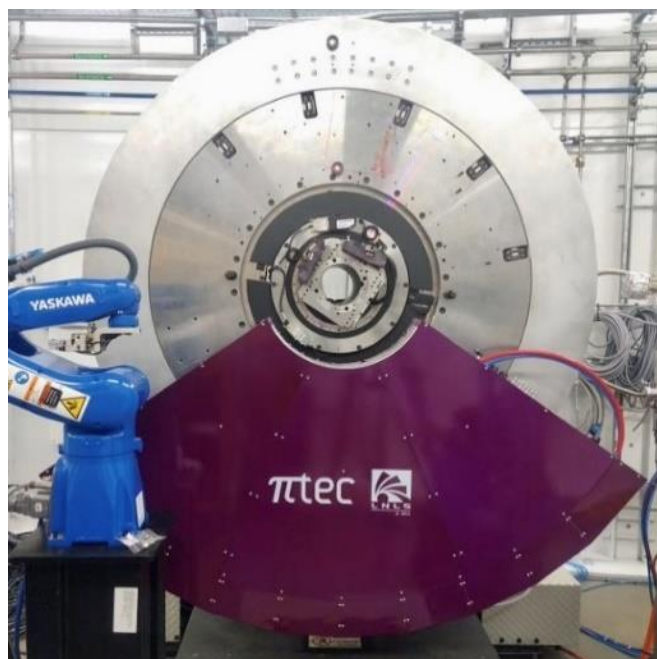
Figura 51: Detector Pimega 450D instalado no difratômetro da PAINEIRA.
