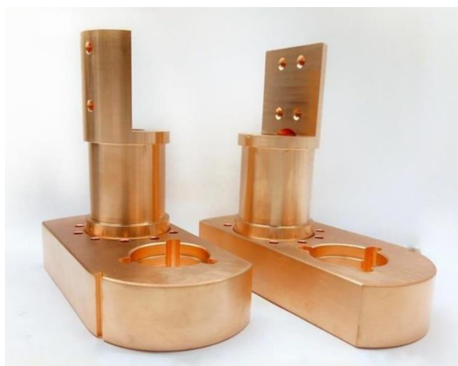
Figura 390 – Lâminas usinadas e brasadas para o scraper vertical.
