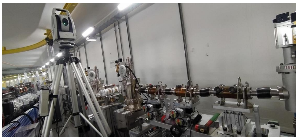
Figura 499 – Alinhamento componentes front end de linha de luz
