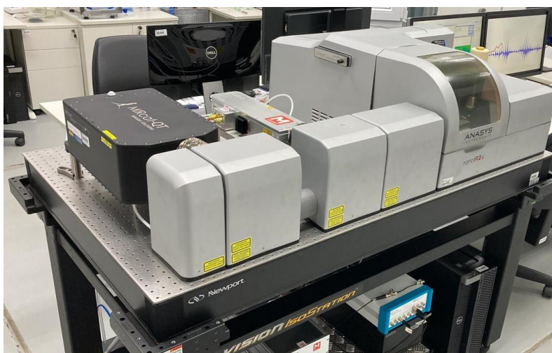
Figura 358. Microscópio de varredura por sonda Bruker NanoIR2-s do laboratório de microscopia de força atômica do LNNano.
