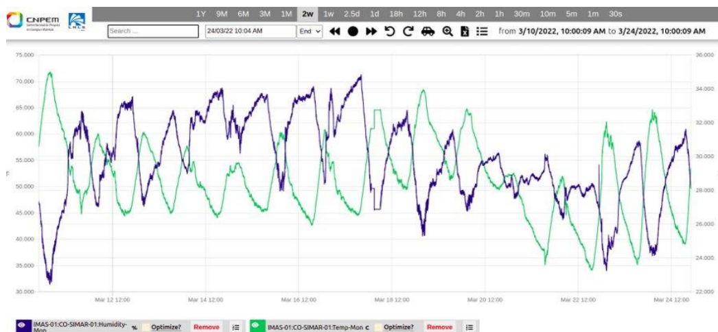
Figura 525 – Monitoração de temperatura e umidade de uma área de estoque durante duas semanas realizada pelo equipamento miniSIMAR.
