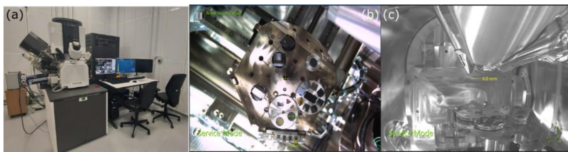
Figura 203 (a) PFIB em junho de 2022 após final da instalação; (b) Imagem do estágio de amostras e (c) Imagem do estágio das amostras obtida por uma câmera IR-CCD, mostrando a posição da amostra em relação às colunas de elétrons e de íons.
