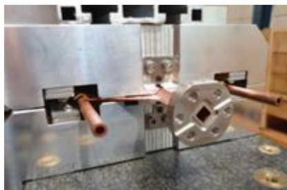
Figura 433 – Teste da câmara no gabarito passa-não-passa.
