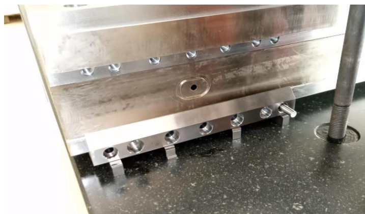
Figura 408 – Instalação do guia linear fixo no cassete, agora com 5 parafusos M8 e dois pinos guia.
