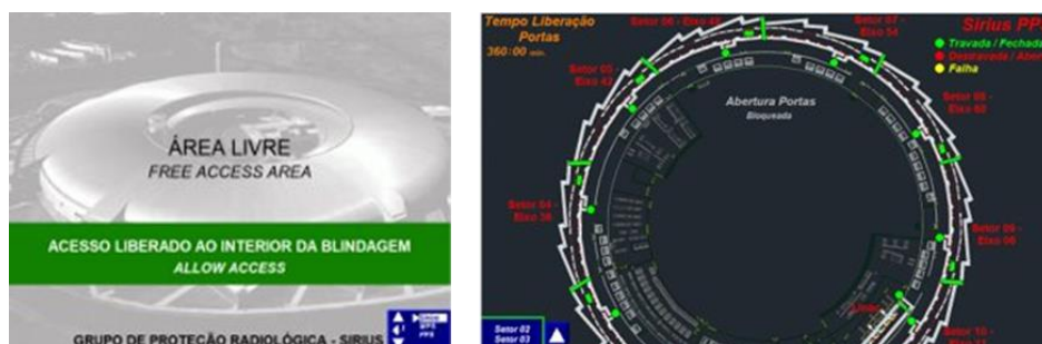
Figura 516 – Tela de interface homem-máquina mostrando a contagem de tempo de segurança 6 horas necessária para acesso aos aceleradores após o desligamento dos equipamentos.
