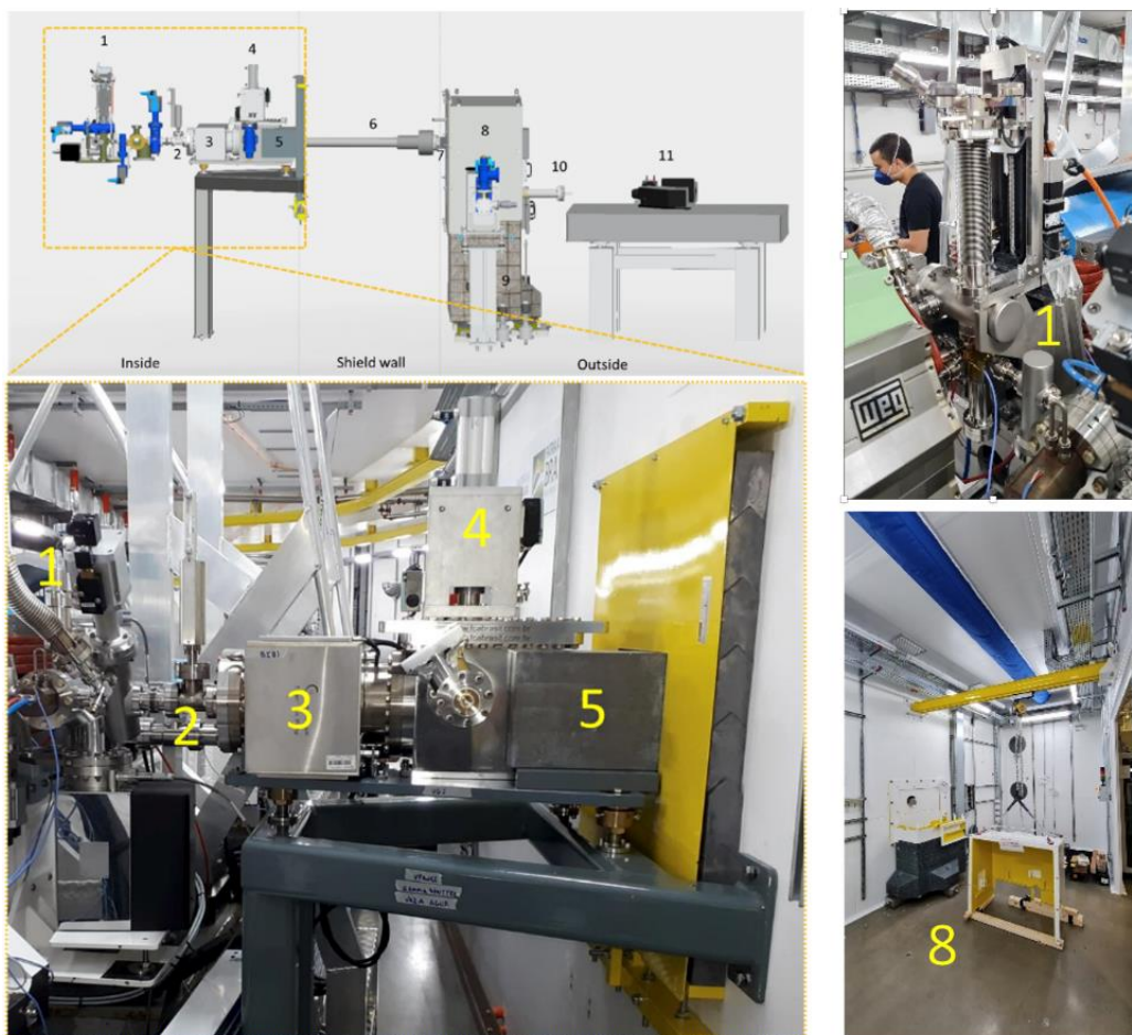
Figura 130. 1- Espelho M1, 2 – Janela óptica de safira (W1), 3 – Bomba iônica, 4 – Obturador Gama, 5 – Chumbo para proteção radiológica, 6 – Nipple, 7 – Bellow, 8 – Câmara de proteção radiológica contendo os espelhos M2, M3 e M4, 9 – Base de granito, 10 – Janela óptica de fluoreto de cálcio (W2), 11 – Espectrômetro DSM20.
