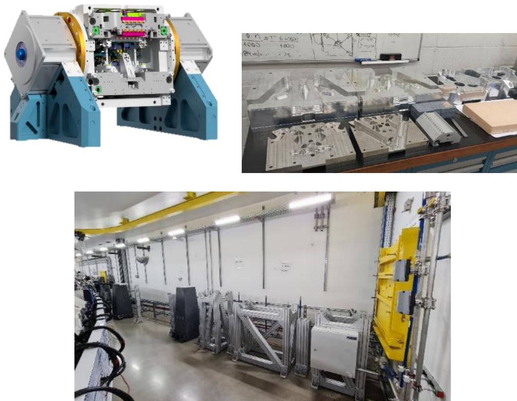
Figura 141. (Superior) Monocromador de duplo cristal e peças em fabricação na oficina interna do CNPEM e em parceiros externos. (Inferior) Estado atual da instalação do front-end no interior do túnel do anel de armazenamento.
