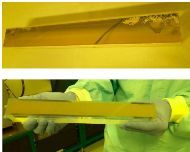
Figura 122 : (Superior) Espelho toroidal a ser usado para focalizar o feixe na estação final do HFM, conforme retirado da antiga linha de feixe PGM no UVX. Note a severa delaminação de parte do revestimento dourado. (Inferior) HFM após revestimento de ouro no LNNano/CNPEM.
