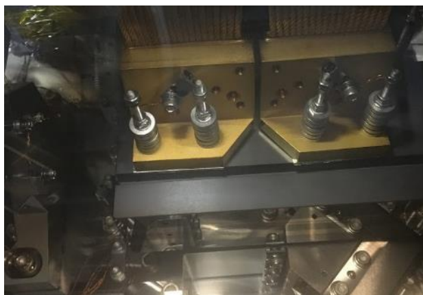
Figura 17: Contaminação observada após operar em picos de pressão devido ao controle dos aquecedores.
