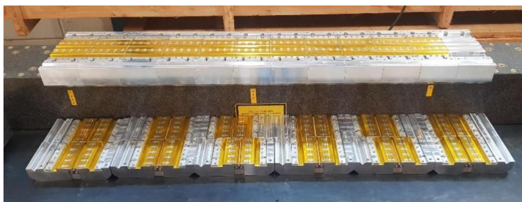
Figura 432 – Gabarito de teste passa-não-passa desenvolvido para a conferência das tolerâncias dimensionais da câmara do DU220
