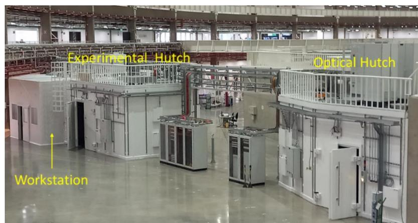
Figura 17: Imagem da linha de luz PAINEIRA no SIRIUS (04/04/2022): a) Cabana Óptica; b) Estação experimental hutch e c) Workstation (três salas): sala de preparação de amostras; sala de controle e sala de manutenção.
