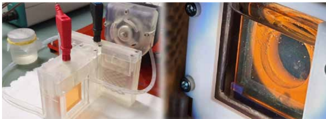
Figura 11. (Lado Esquerdo) Célula fotoeletroquímica com sistema de fluxo para evitar acúmulo de bolhas devido a eletrólise da água. (Lado Direito) Zoom da frente da célula em operação sob irradiação solar e condições reais de uso ilustrando a presença das bolhas geradas H_2 e O_2 provenientes da eletrólise da água induzida pela luz solar.
