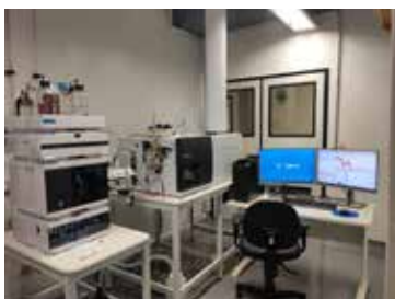
Figura 39. 6545XT AdvanceBio LC/Q-TOF, Agilent, acoplado ao sistema de cromatografia líquida Infinity II, Agilent
