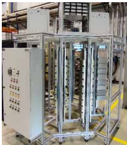
Figura 59. Torre amplificadora em processo de montagem na área de RF.
