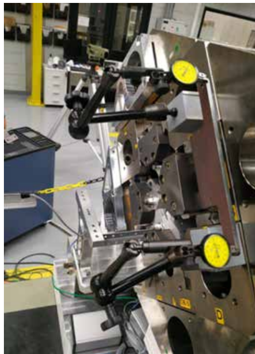
Figura 64. Setup montado para medição das deformações nos cassetes, com dispositivo para acionamento dos relógios apalpadores.
