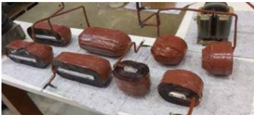
Figura 69. Bobinas de corretoras verticais, horizontais e quadropolo skew impregnadas
