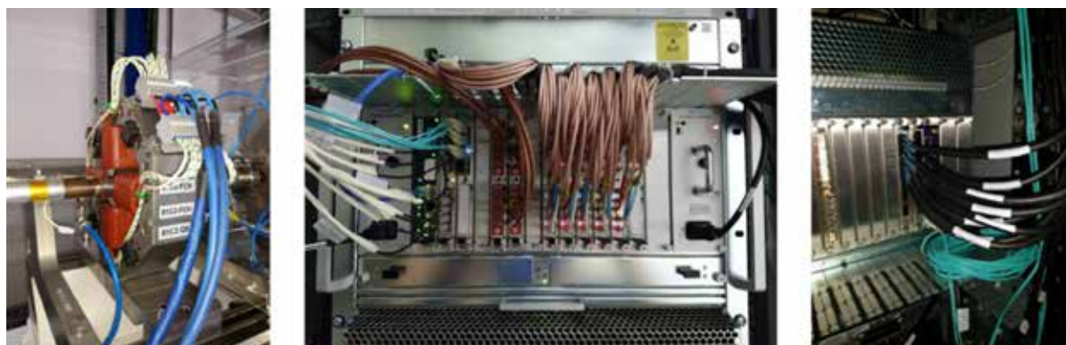
Figura 52. Ímãs de corretora rápida (esquerda), bastidores MicroTCA evidenciando placa AFC-FOFB com FMC-4SFP+ e conexões de fibra óptica (centro) e fonte rápida RTM-LAMP com 8 cabos de corretora conectados (direita).
