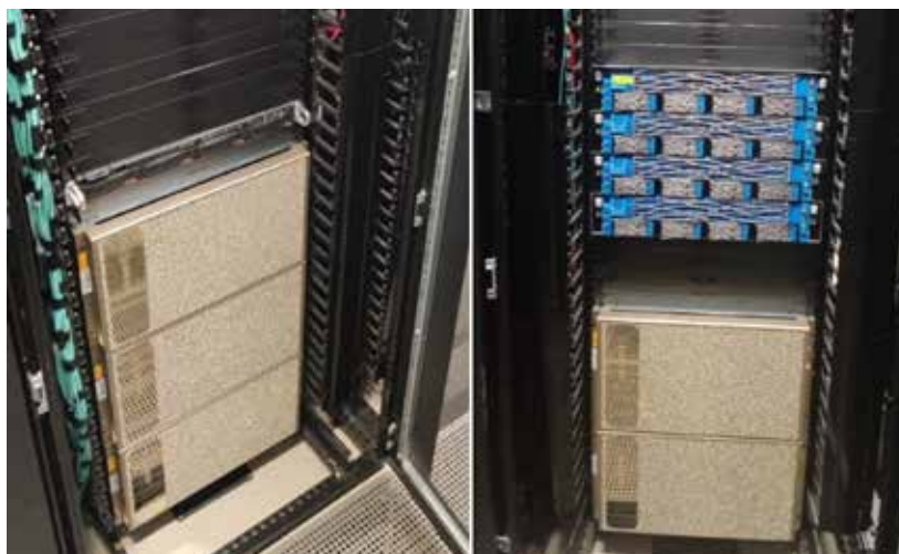
Figura 27 - Servidores que compõem o cluster receberão um nó adicional de processamento, totalizando 6 nós de GPUs (Unidades de processamentos gráficos).
