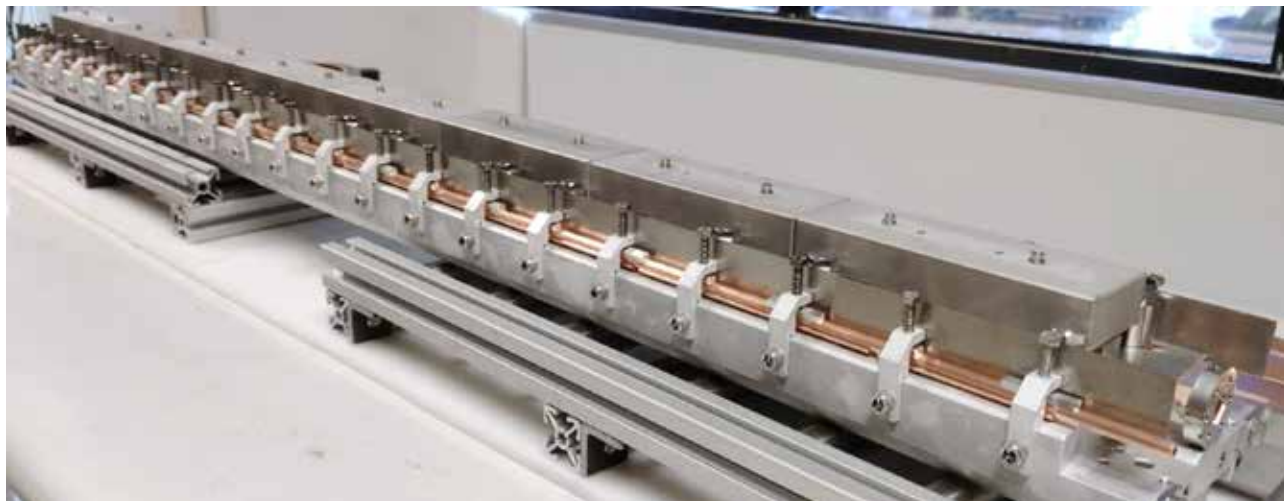
Figura 77. Dispositivo de brasagem desenvolvido para a solda do sistema de refrigeração do DU220.
