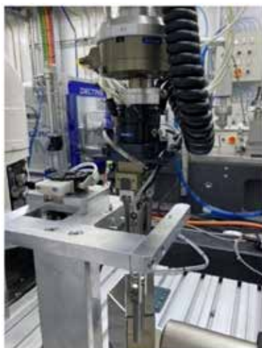
Figura 97. Braço robótico com garra na posição de secagem.
