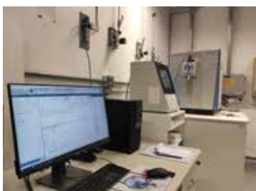
Figura 38. Orbitrap Exploris 240, Thermo Scientific, acoplado ao sistema de cromatografia líquida EASY-nLC™ 1200, Thermo Scientific
