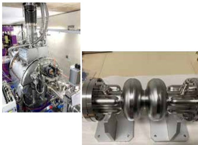
Figura 53. Cavidade harmônica do SSRF instalada na fonte de luz; (dir) detalhe da cavidade: acoplados às duas células estão os guias canelados que levam os HOM até os absorvedores de RF (SiC)
