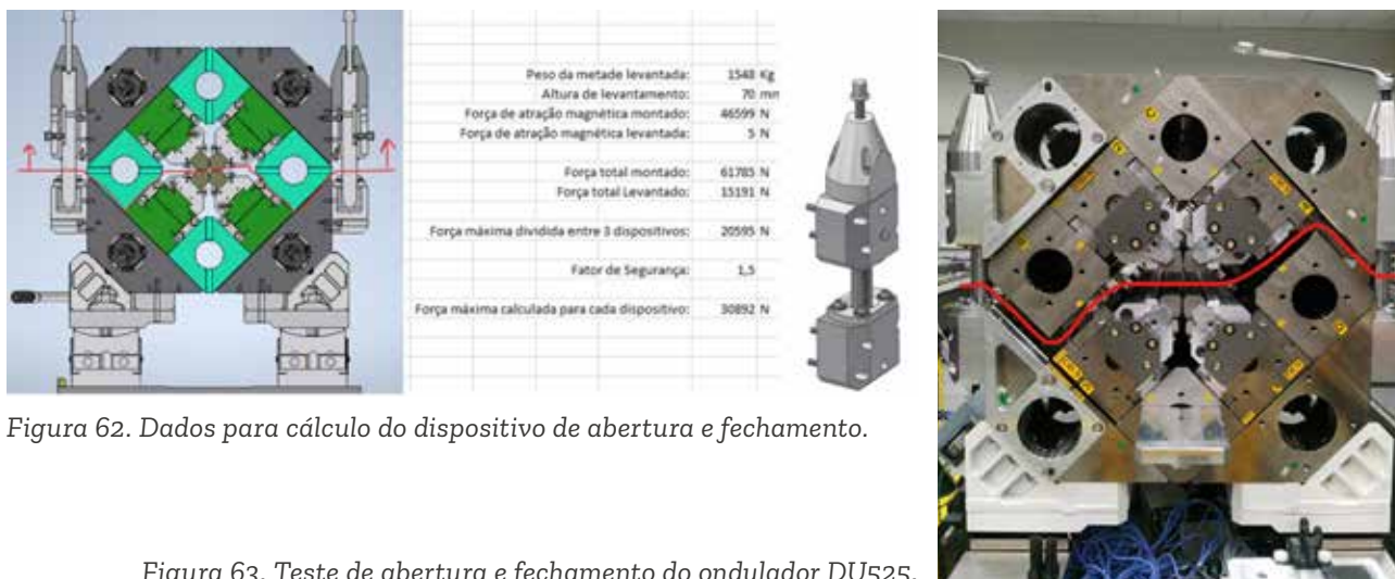
Figura 63. Teste de abertura e fechamento do ondulator DU525.
