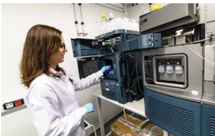
Carolina utilizou um dos espectrômetros de massas do LNBio. Carolina used one of LNBio's Mass Spectrometer.
