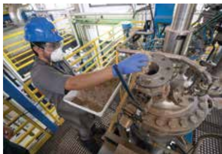
Marcos Guilherme Martins carrega o reator de pré-tratamento com bagaço de cana-de-açúcar in natura. Marcos Guilherme Martins loading pre-treatment reactor with sugarcane bagasse in natura.
