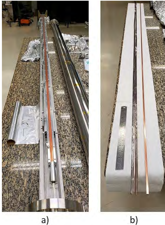
Figura 160. Desenvolvimento do processo de deposição NEG das câmaras para os Onduladores Delta 22 com comprimento de 2600 mm: a) montagem provisória para os testes de deposição NEG; e b) tubo aberto com deposição NEG em todo o comprimento de 2600 mm.
