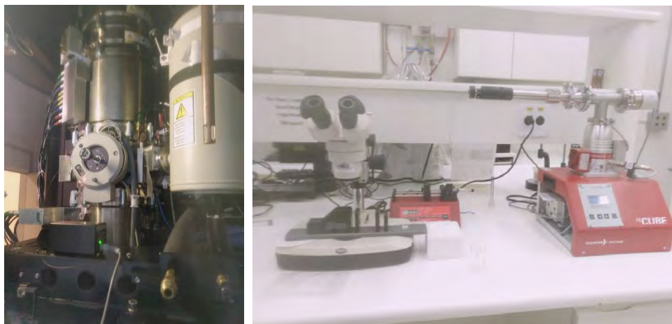
Figura 126. (A) Porta-amostras in situ de aquecimento (Wildfire) sendo inserido no microscópio eletrônico de transmissão Titan Cubed Themis. (B) Porta-amostras in situ com célula líquida (Ocean) na estação de bombeamento turbo molecular utilizada para teste de vedação do chip (procedimento utilizado antes de inserir no microscópio).
