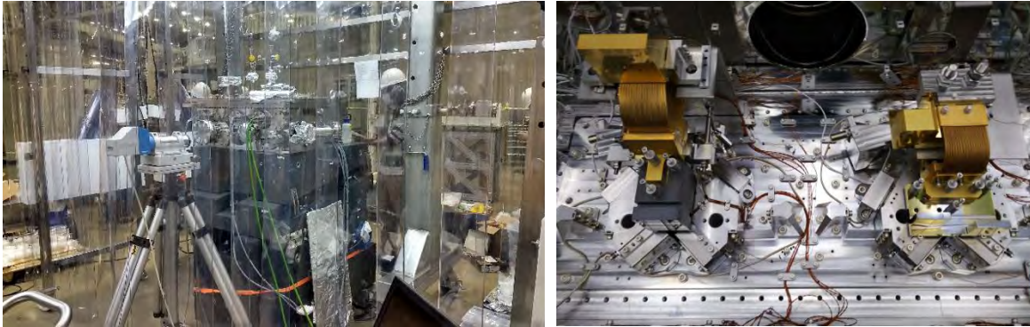
Figura 22. Base de granito e câmara de vácuo sob fluxo laminar (esq.) durante montagem do mecanismo interno com espelho e sistema de diagnóstico (dir.) do sistema M1 da linha CARNAÚBA.
