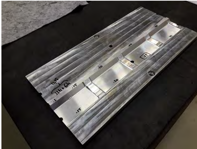
Figura 155. Teste de usinagem no perfil de alumínio para definir o passo de usinagem no primeiro protótipo.
