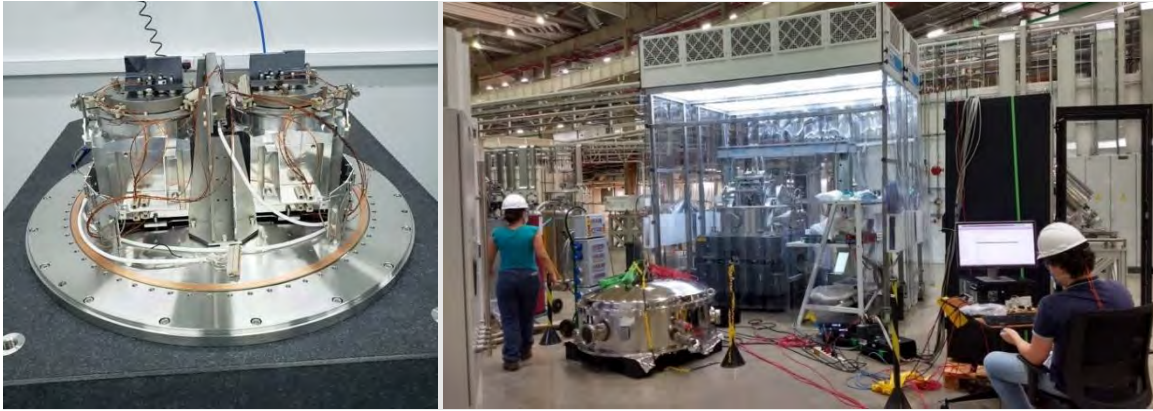
Figura 20 Visão interna do monocromador 4CM em calibração e foto da instalação do segundo exemplar do monocromador HD-DCM na linha EMA durante as verificações finais do sistema de controle antes do fechamento em vácuo.
