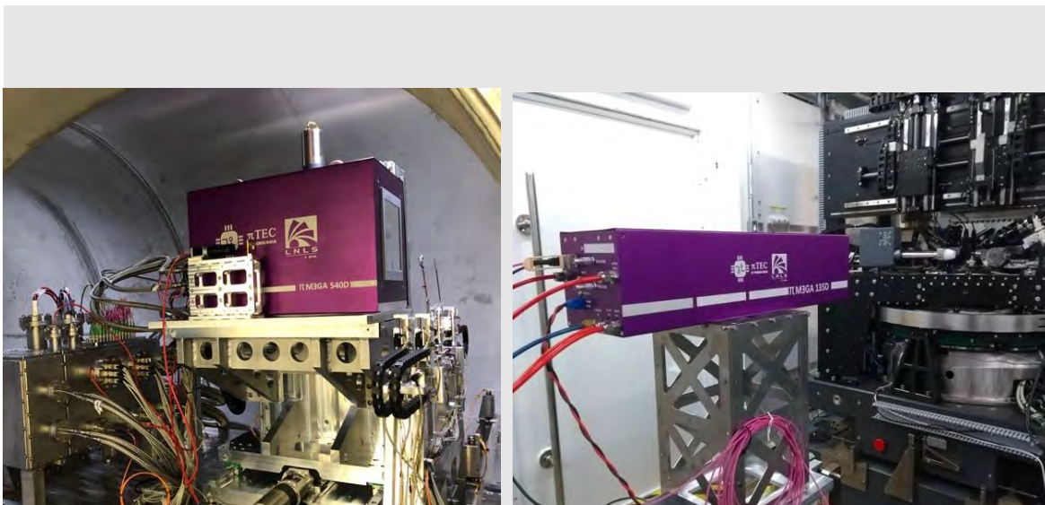
Figura 23. Detectores p-MEGA instalados nas linhas do Sirius. (esq.) Detector p-MEGA 540 D instalado dentro do túnel de vácuo da linha CATERETÊ e (dir.) detector p-MEGA 135D de 675 um de Si, instalado na estação TARUMÃ da linha CARNAÚBA
