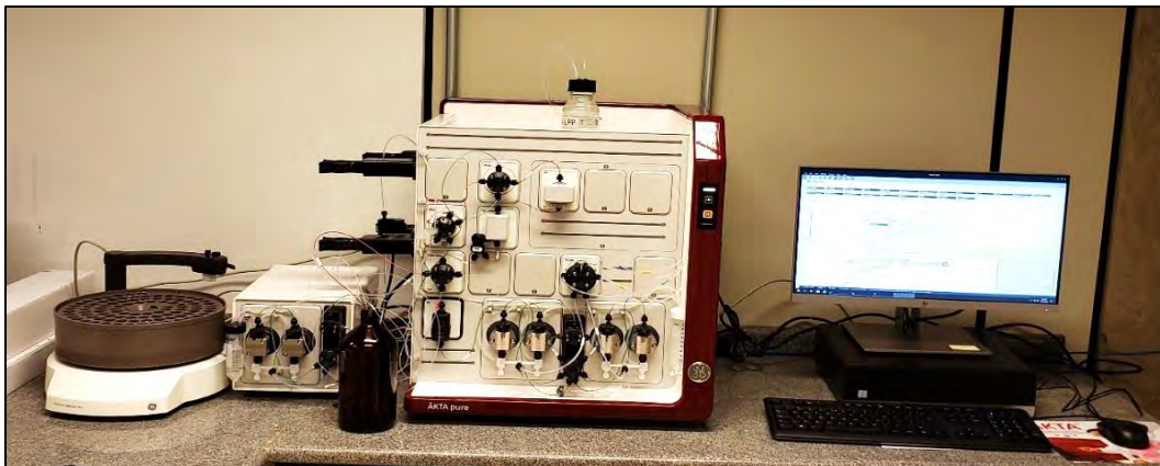
Figura 62. Sistema de cromatografia líquida 'AKTA Pure' (GE Healthcare) utilizado para purificar proteínas, peptídeos e outras macromoléculas.
