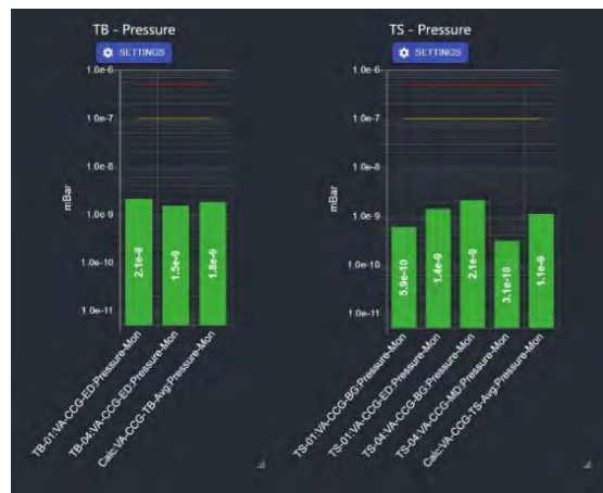
Figura 148. Pressões de vácuo das linhas de transporte: linha linac-Booster (TB) e linha booster-anel (TS).
