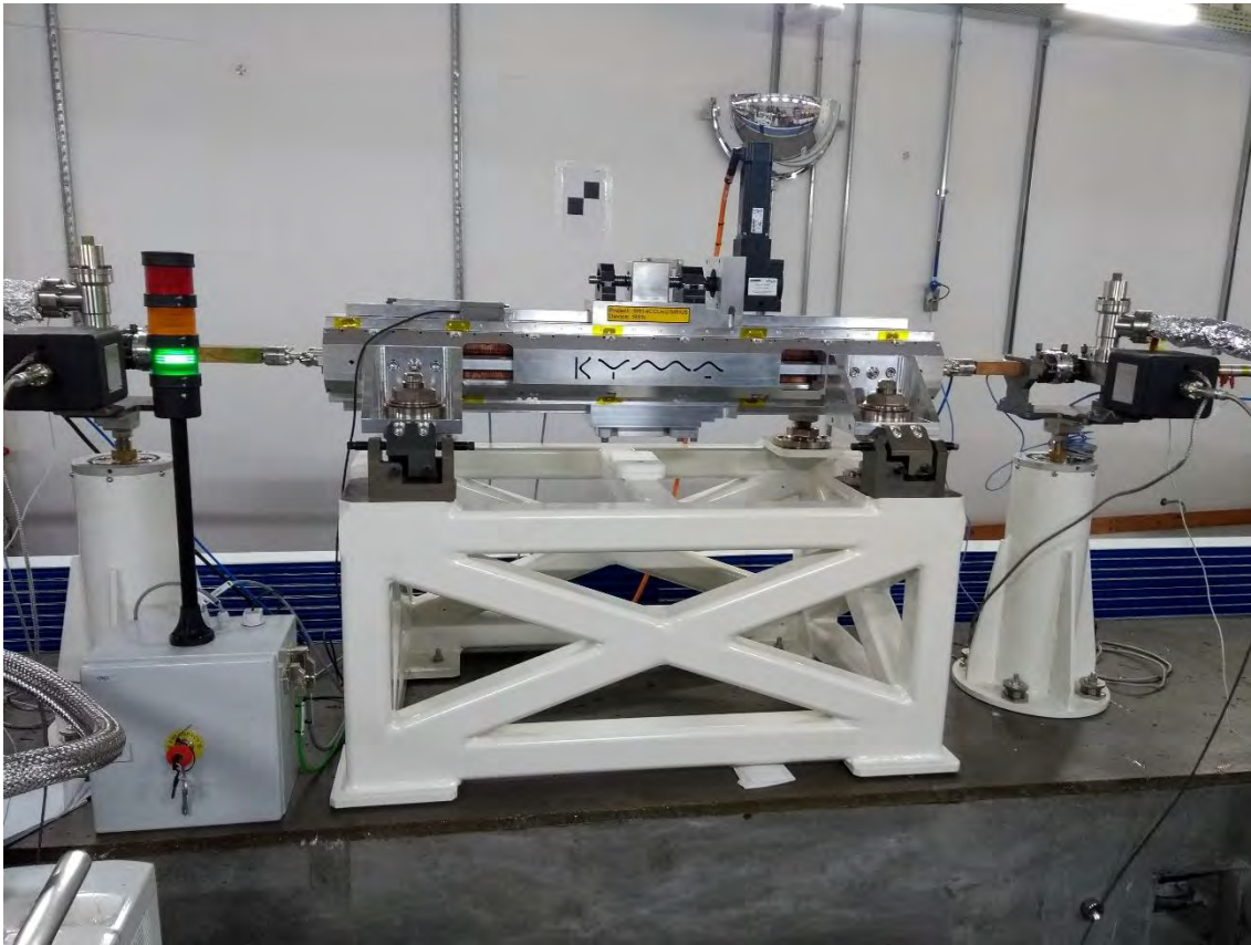
Figura 188. Ondulador planar de comissionamento instalado no trecho reto da linha de luz EMA.
