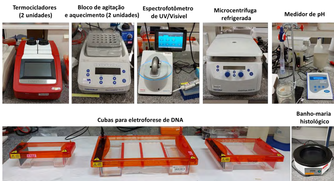
Figura 60. Equipamentos instalados no LOM em 2020 utilizados nos procedimentos rotineiros de geração das construções de DNA usadas na técnica CRISPR/Cas9 de edição de genoma.
