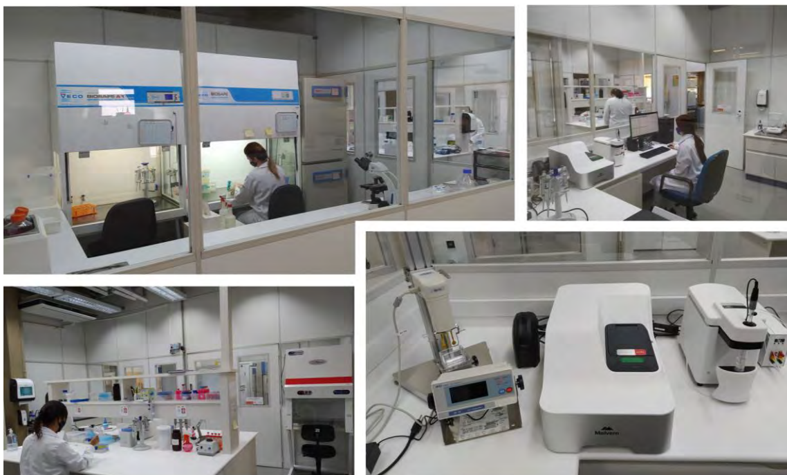
Figura 134. Laboratório de Nanotoxicologia. Início da operação e experimentos com cultura de células (nanotoxicidade in vitro ) e comissionamento do novo equipamento Zetasizer Ultra (Malvern) para estudos de dispersão de nanomateriais em meios biológicos e matrizes ambientais utilizados em ensaios nanotoxicológicos.
