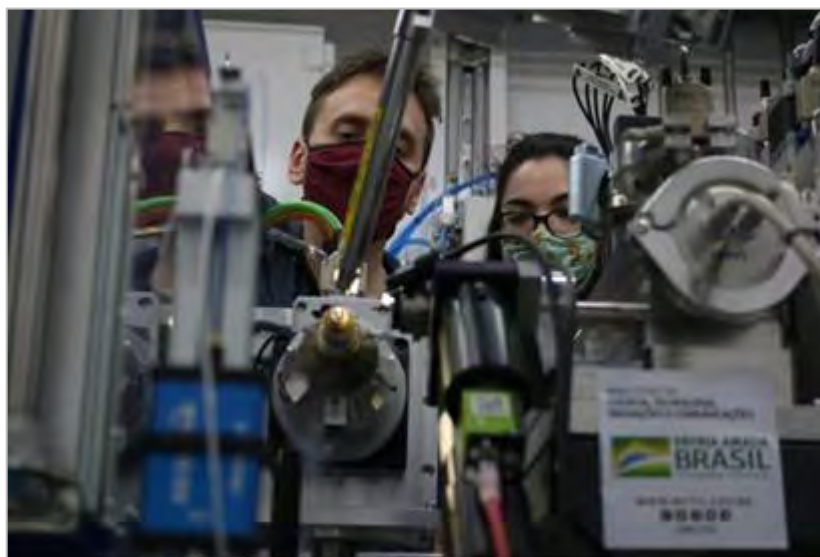
Figura 9. Primeiros usuários da linha MANACÁ posicionam cristal de proteína de SARS-CoV-2 para análise.
