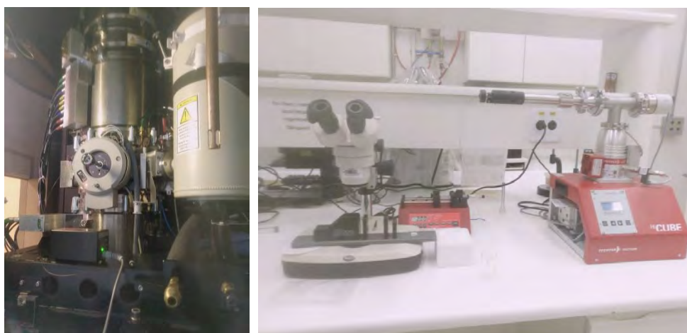
Figura 126. (A) Porta-amostras in situ de aquecimento (Wildfire) sendo inserido no microscópio eletrônico de transmissão Titan Cubed Themis. (B) Porta-amostras in situ com célula líquida (Ocean) na estação de bombeamento turbo molecular utilizada para teste de vedação do chip (procedimento utilizado antes de inserir no microscópio).
