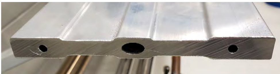
Figura 152. Perfil de alumínio extrudado na liga 6063-T6 para a fabricação das câmaras do Delta 52.
