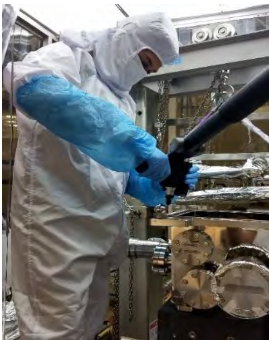
Figura 199. Fiducialização de espelho de uma das linhas de luz do Sirius, com auxílio de máquina de medição por coordenadas de braço articulado.
