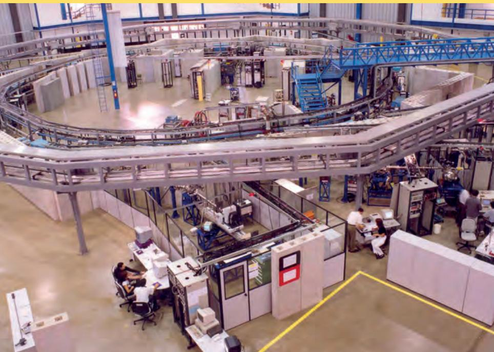
No momento de sua inauguração, UVX contava com sete linhas de luz: Estrutura fina da absorção de raios X (XAS), espectroscopia de raios X moles (SXS), espalhamento de raios X a baixos ângulos (SAXS), difração de raios X (XRD), cristalografia de proteínas (PCR) e duas linhas de espectroscopia no ultravioleta.
