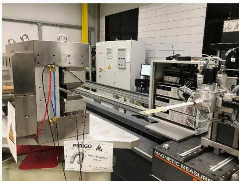
Figura 32: Primeiro protótipo do BC pronto na bancada de medição magnética.
