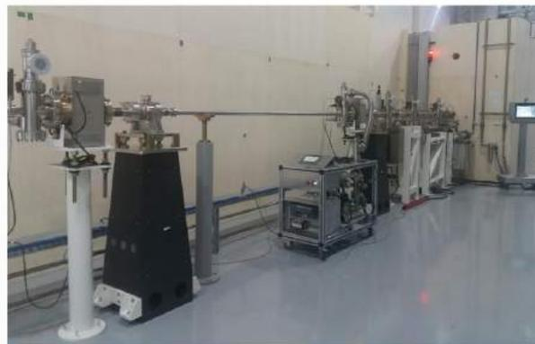
Figura 44: Front-end completo montado no prédio de metrologia
