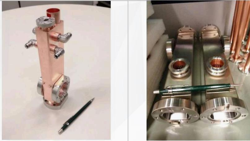
Figura 26: Esquerda Protótipo final de um dos modelos de estações de bombeamento/crtoch absorber. Direita: Protótipos finais das estações de bombeamento convencionais.
