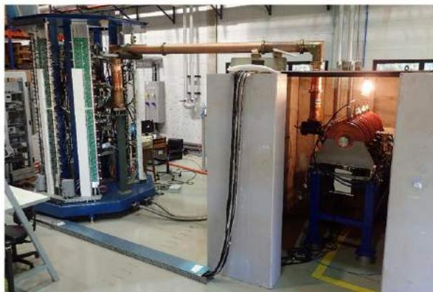
Figura 37: Área de testes com o amplificador de 50 kW à esquerda e a cavidade de RF do booster à direita.
