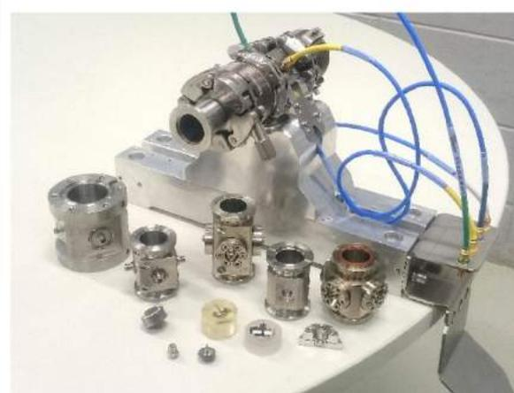
Figura 29: Componentes e montagem dos sensores BPM.
