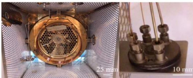
Figura 57. Módulo Peak Hunter para cromatografia bidimensional abrangente.
