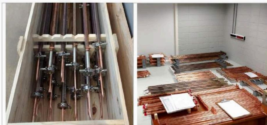
Figura 25: Esquerda: Lote de câmaras retas para trechos multipolares prontas aguardando instalação no Sirius. Direita: Lote de câmaras retas para trechos multipolares parcialmente prontas.
