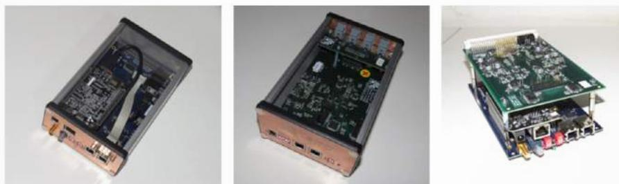
Figura 35: Da esquerda para direita, cabeças de série das placas Serial, Monitora de temperatura e Conversores.
