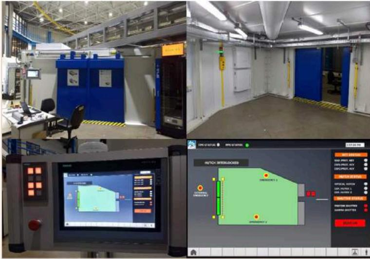
Figura 43. Fotos do exterior e interior da cabana protótipo instalada no UVX e detalhes da interface do sistema de automação.
