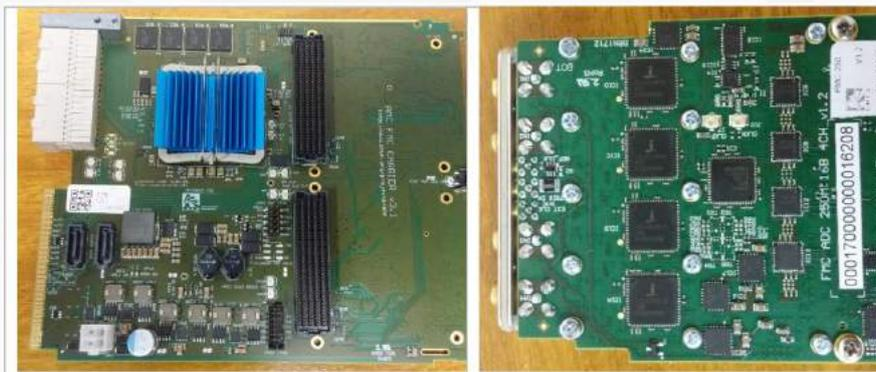
Figura 38: Esquerda: Eletrônica de processamento digital de sinais baseada em chip FPGA, em sua versão final. Direita: Eletrônica multicanal de aquisição de sinais de RF, com taxa de amostragem de 250 MSP/s, em sua versão final.
