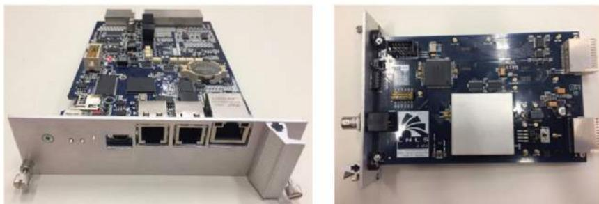
Figura 39: Foto das placas do UDC (esquerda) e HRADC (direita) da versão final do DRS.
