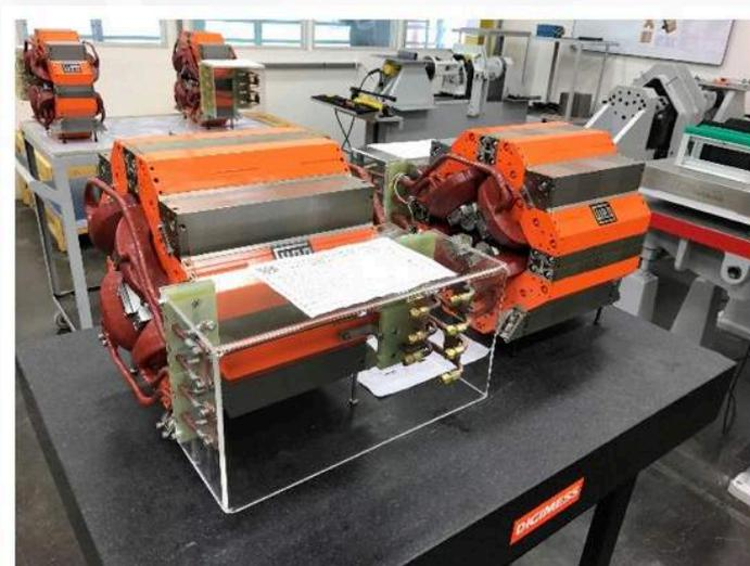
Figura 31: Protótipos do Quadrupolo Q30 do anel de armazenamento do Sirius prontos para envio na WEG.
