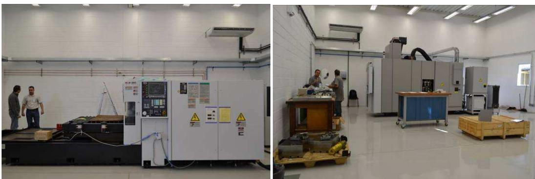
**Figura 2 – Ampliação da oficina mecânica do LNLS para abrigar as novas máquinas de usinagem: corte a laser (esquerda) e centro de usinagem de cinco eixos (direita). A terceira máquina, um centro de usinagem de quatro eixos, será instalada na sala à direita no segundo semestre.**
