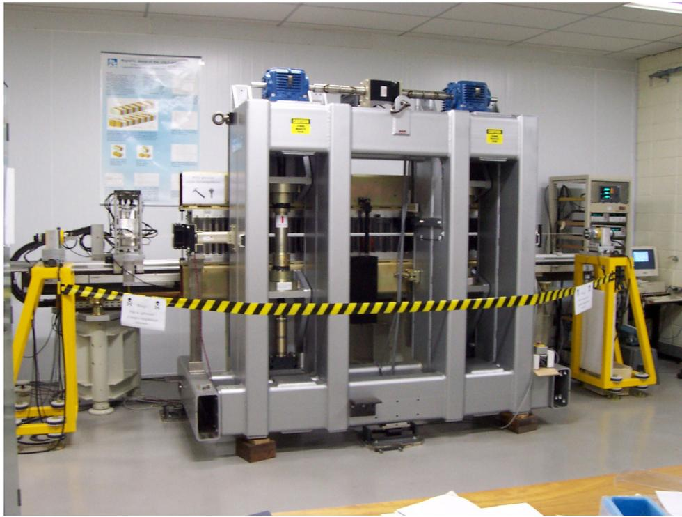
*Figura 4: Dispositivo wiggler multipolar híbrido de 2 T na bancada de caracterização no Laboratório de Ímãs.*
