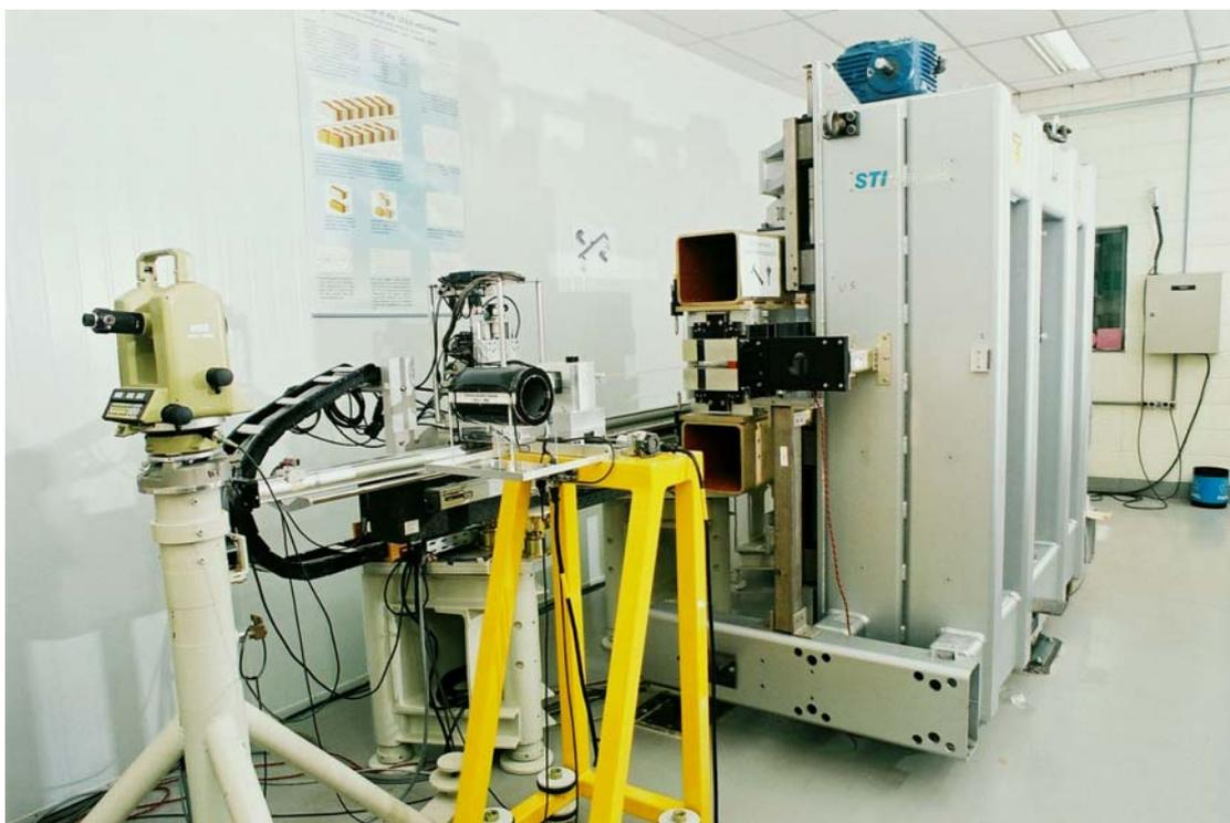
*Figura 5: Dispositivo wiggler multipolar híbrido de 2 T na bancada de caracterização no Laboratório de Ímãs*
