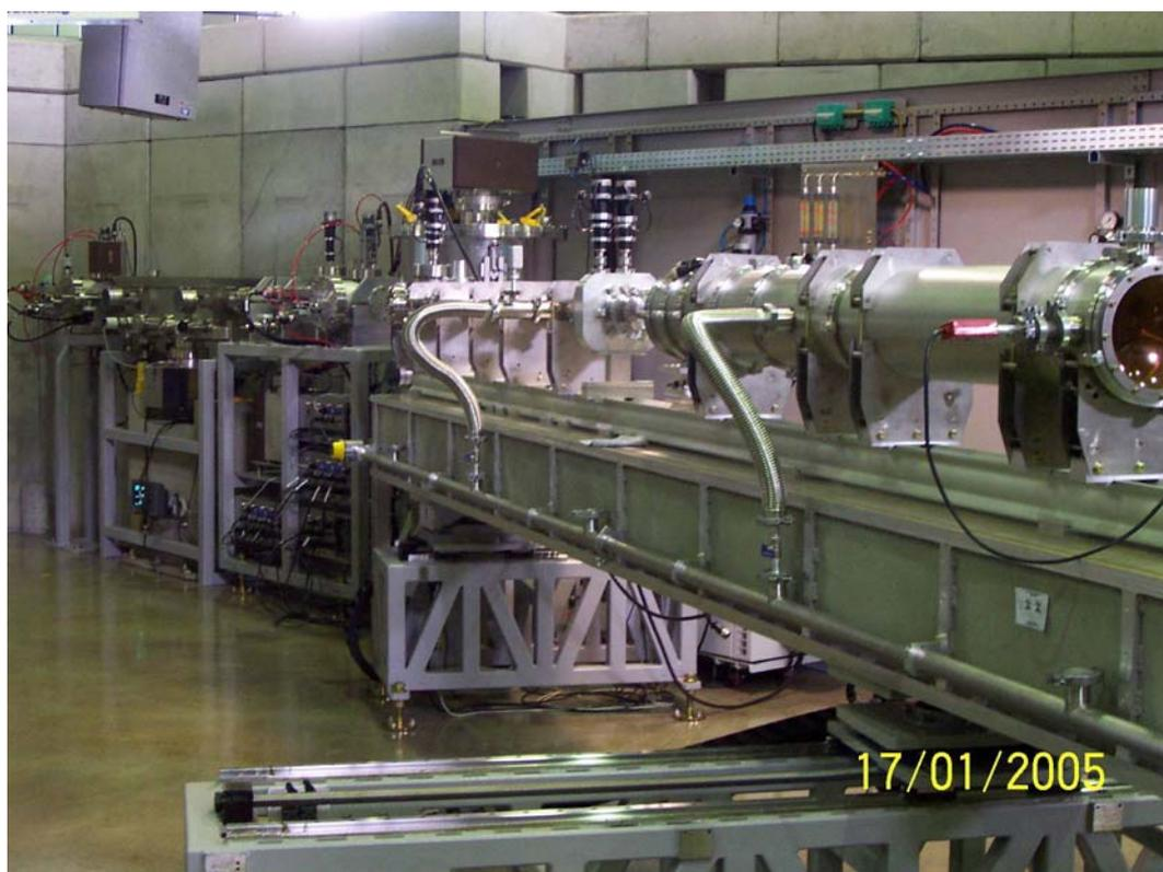
*Figura 1: Linha SAXS2 aguardando últimos componentes. O berço porta amostra tem 5 m de comprimento e é feito inteiramente em alumínio estrutural.*
