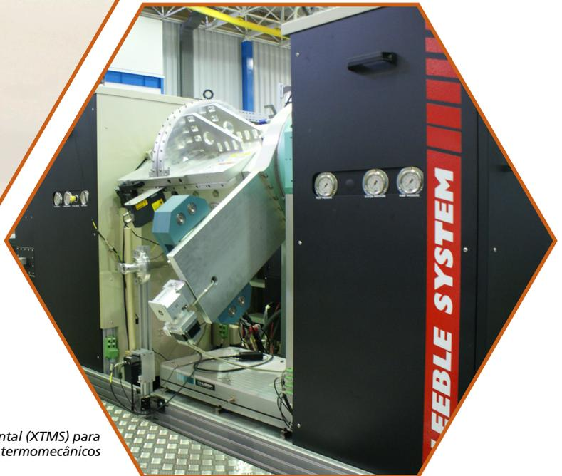
*Estação experimental (XTMS) para ensaios termomecânicos*
