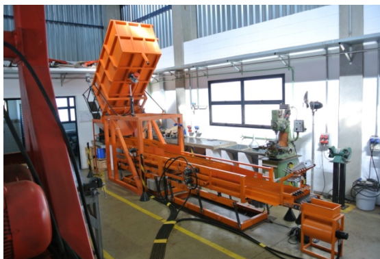
Figura 38 - Unidade experimental construída para o desenvolvimento da fase de laboratório do processo de plantio de precisão
