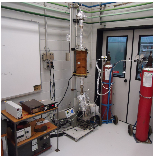
Figura 21 - Sistema provisório, construído no laboratório de vácuo do LNLS, para desenvolvimento da tecnologia de deposição de filmes NEG
