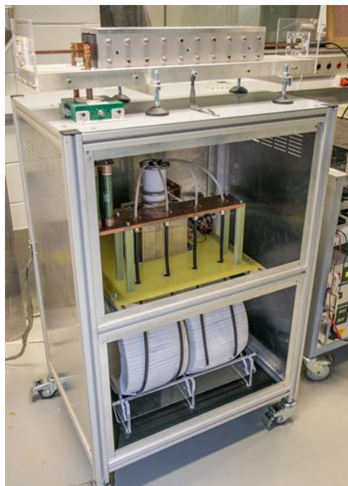
Figura 2.52: Kicker de Injeção do Booster durante a Caracterização Magnética
