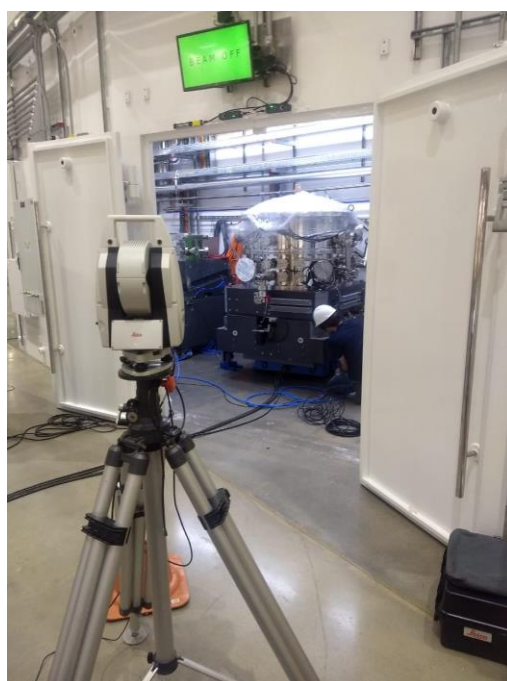
Figura 69. Etapa de posicionamento de monocromador (DCM) na cabana ótica, também da Manacá
