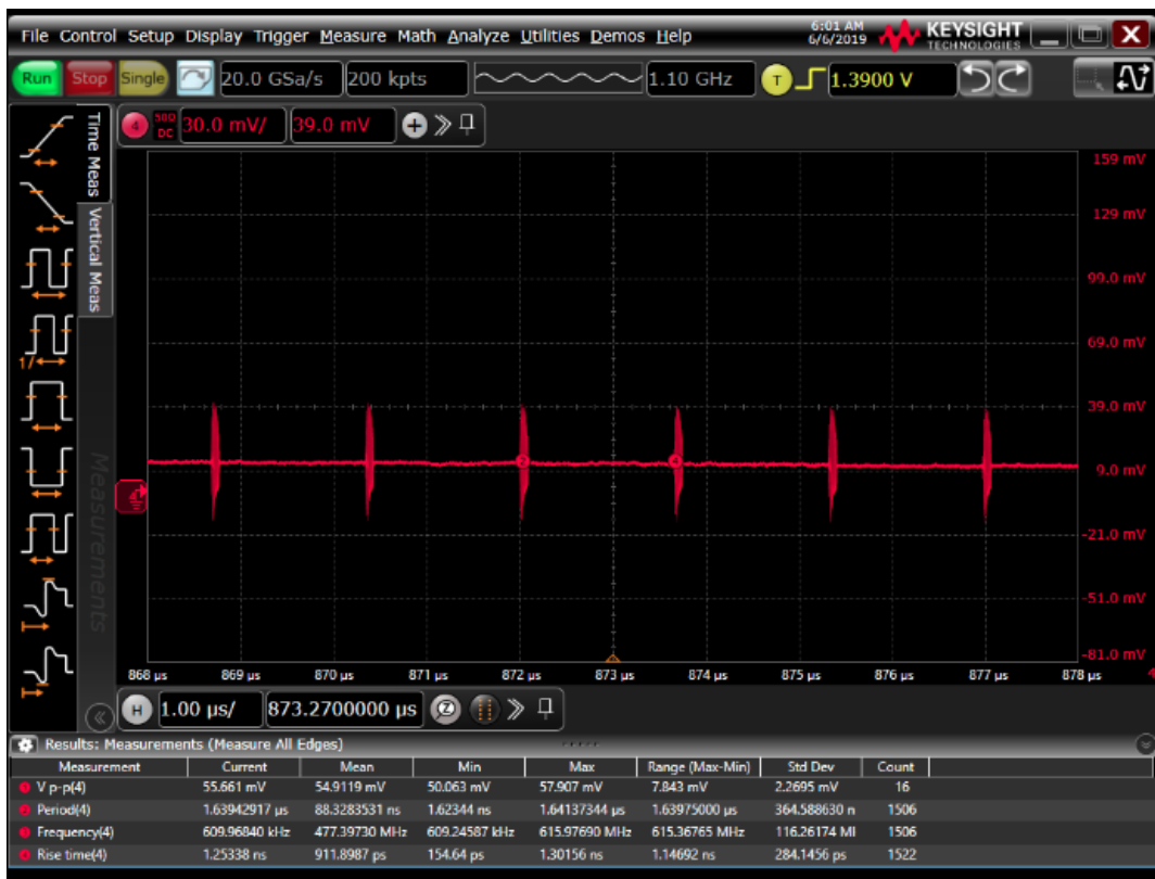
Figura 19. Sinal do feixe do Booster detectado no monitor stripline no dia 6 de junho. O feixe deu mais de 15 mil voltas nesse dia sem radiofrequência
