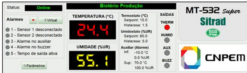
Figura 137. Painel de monitoramento de temperatura e umidade relativa do ar feita pelo software 'Sitrad' que permite acessar à distância tais parâmetros dos biotérios de produção e experimentação animal
