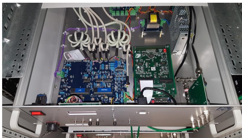
Figura 73. Gaveta do sistema de ímãs pulsados contendo uma placa de interface com BBB (Beagle Bone Black)
