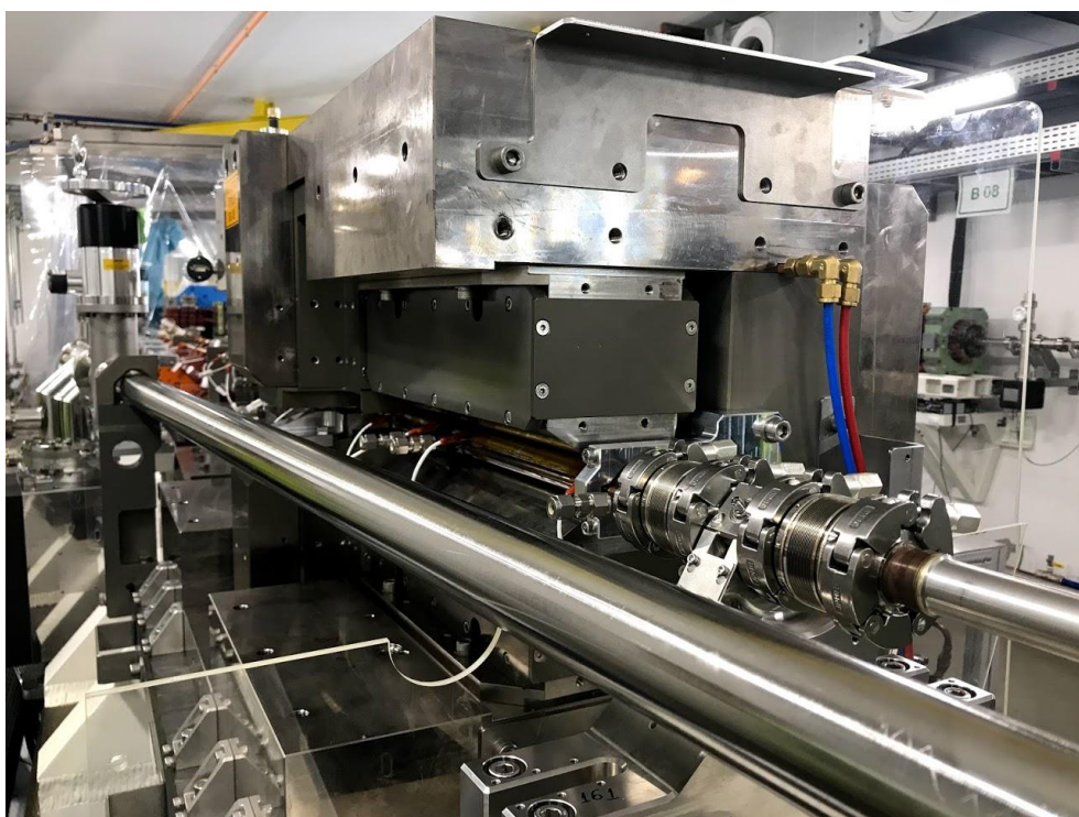
Figura 51. Câmara de vácuo já com saída de linha em frente do dipolo central (BC)
