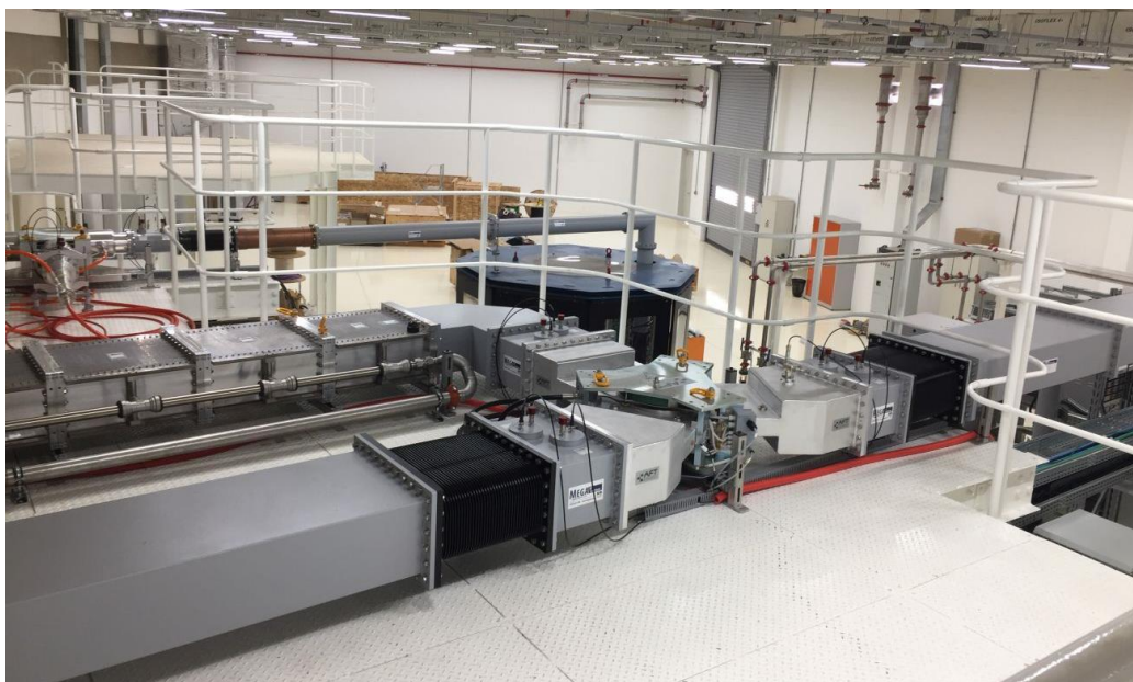
Figura 81. Circulador e carga do sistema de RF do anel
