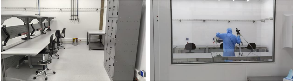
Figura 117. Laboratório de desenvolvimento de detectores, com bancadas de isolamento elétrico e sala limpa ISO 6
