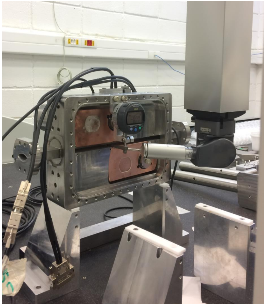
Figura 89. Caracterização mecânica do scraper vertical realizado com a máquina de medição por coordenadas 3D
