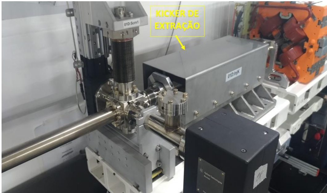
Figura 60. Magneto pulsado do tipo kicker de extração do booster construído com ferrites CMD 5005 Ni-Zn
