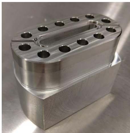
Figura 42. Usinagem de peça protótipo soldada por difusão (Al6061/inox) para ondulador planar
