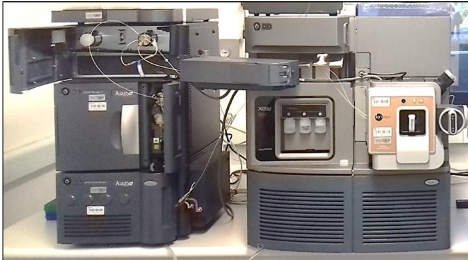
Figura 122. Espectrômetro de Massas 'Xevo TQ-XS', da marca Waters, um dos equipamentos mais sensíveis do mercado que permite a detecção de íons de uma grande variedade de moléculas.
