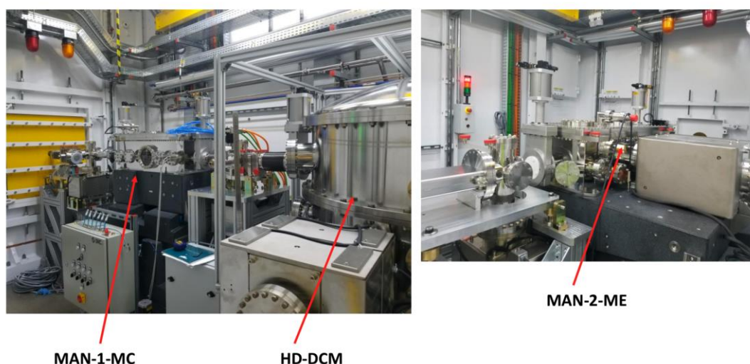
Figura 98. (esq.) Cabana ótica da linha MANACÁ, com espelho M1 e monocromador HD-DCM. (dir.) Interior da cabana experimental da linha MANACÁ, com detalhe do espelho M2
