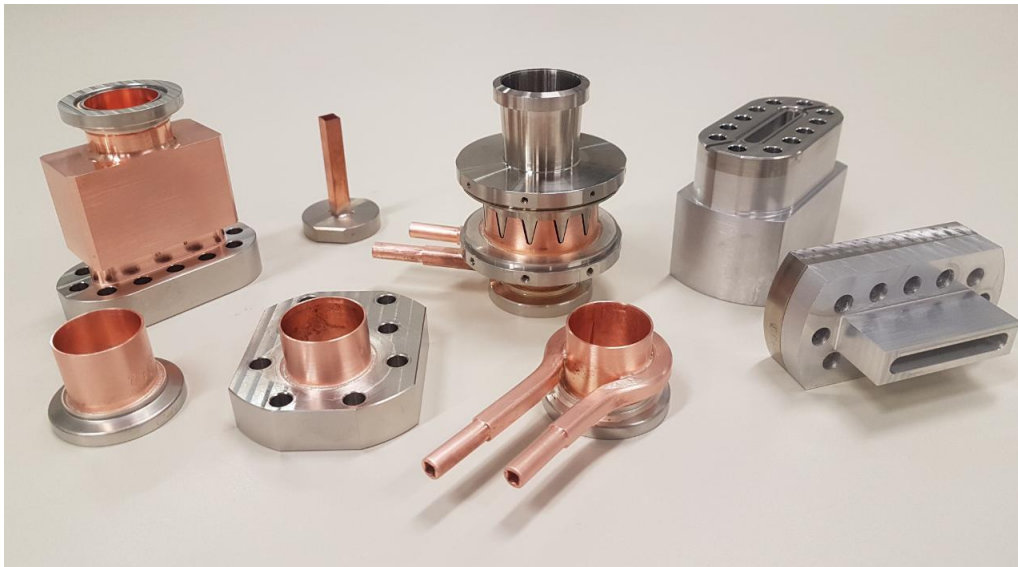
Figura 39. Amostras de brasagens e soldagens por difusão
