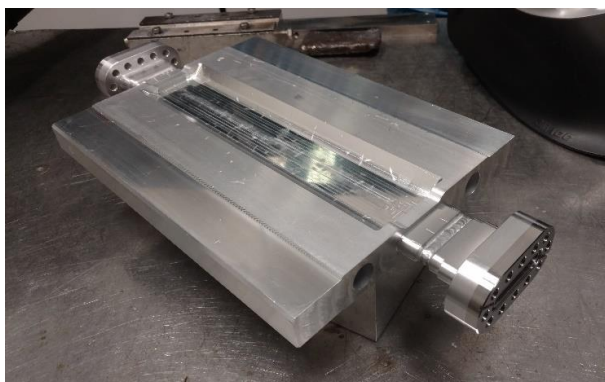
Figura 31. Desenvolvimento da câmara de vácuo especial para os onduladores planares: a) desenho da seção transversal do ondulador planar com a câmara de vácuo; b) perfil de alumínio conforme extrudado; e c) protótipo da câmara completo com comprimento menor, 380 mm
