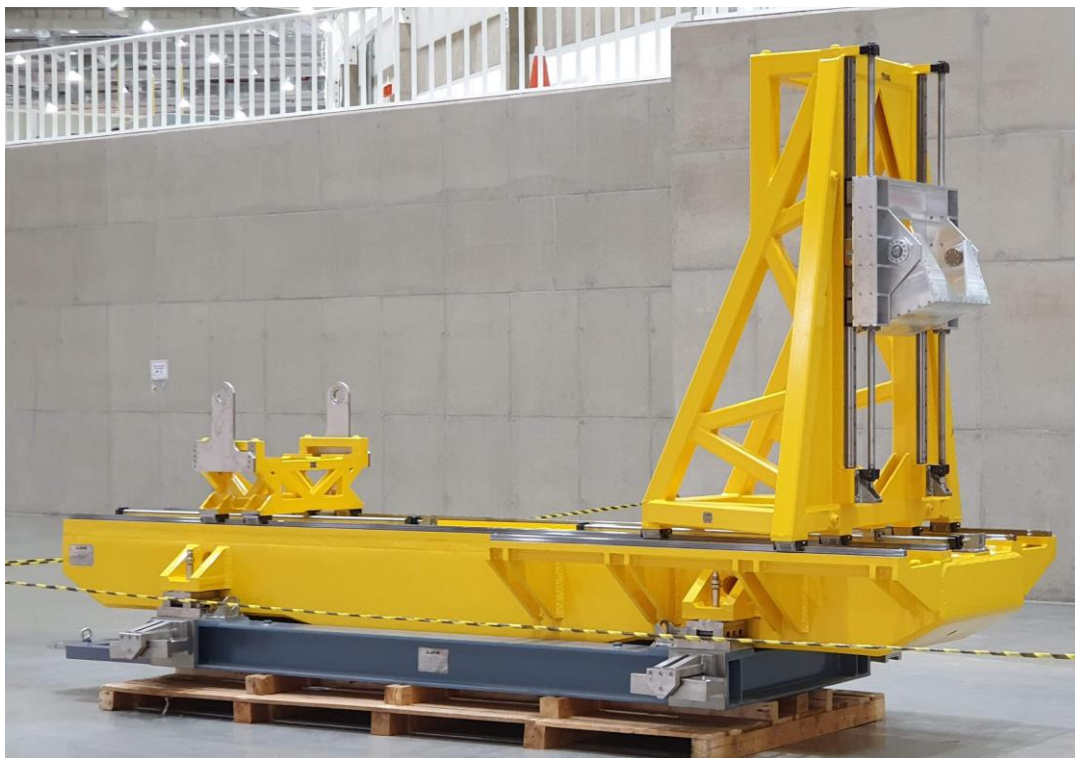
Figura 108. Espectrômetro de RIXS da linha IPÊ em montagem no hall experimental
