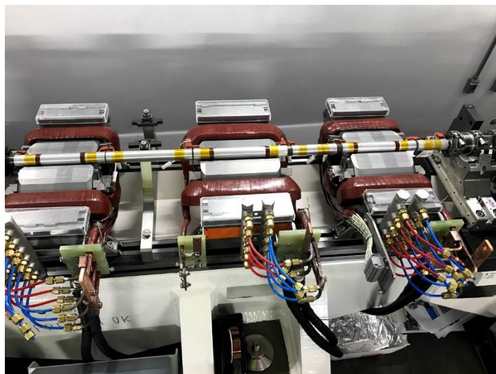
Figura 49. Berço de multipolos com magnetos abertos para instalação das câmaras de vácuo
