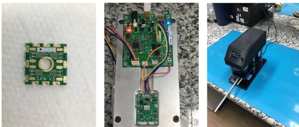
Figura 195. (esquerda) PCB com o sensor SAW. (centro) circuito eletrônico para efetuar a leitura do sensor. (direita) primeira versão do aparelho
