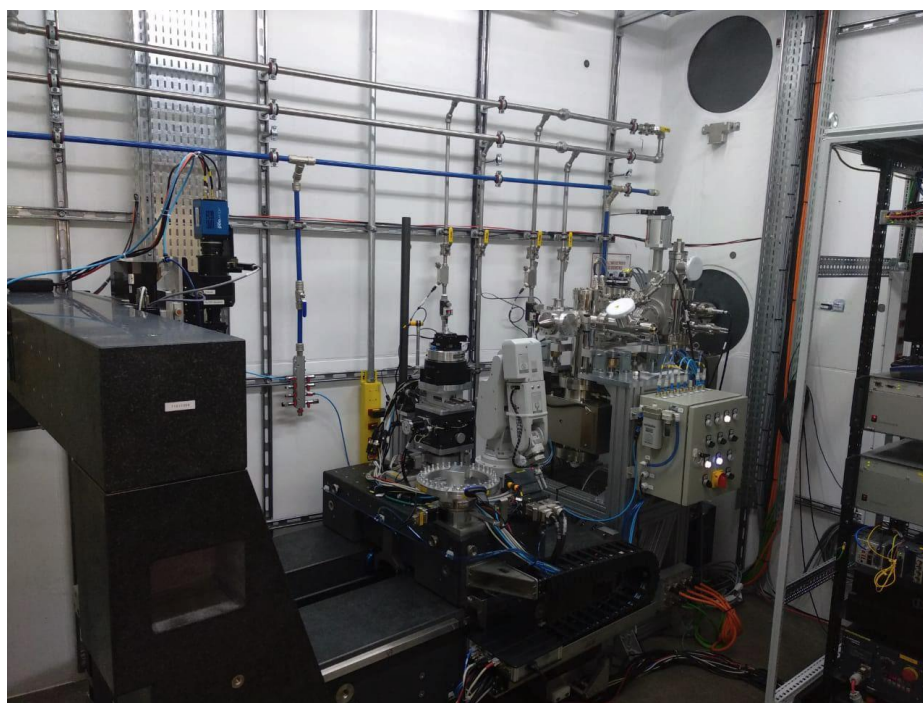
Figura 103. Interior da cabana ótica da linha MOGNO, com o experimento de tomografia com feixe branco instalado provisoriamente (projeto IMXS), pronta para receber raios-X do dipolo BC, e aguardando feixe armazenado
