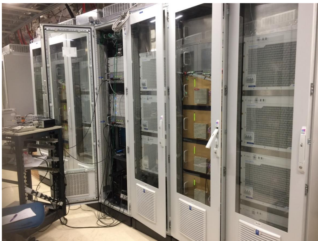
Figura 90. Fontes dos dipolos do Anel de Armazenamento sendo testadas
