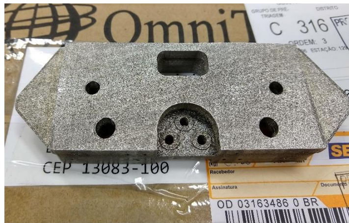
Figura 45. Manifold fabricado via prototipagem rápida aprovado para uso em ultra alto vácuo
