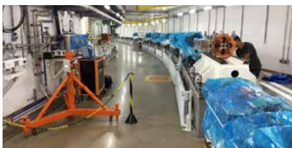
Figura 47. Etapa de pré-alinhamento do Anel de armazenamento do Sirius
