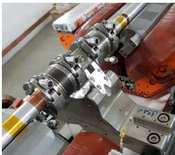
Figura 57. BPM sob vácuo instalado no anel
