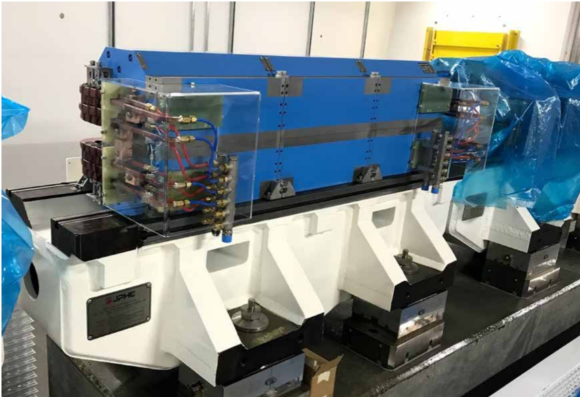
Figura 68. Dipolo B120 instalado na base no anel de armazenamento. Todos os dipolos B80 e B120 já se encontram instalados e alinhados, aguardando o recebimento das câmaras de vácuo
