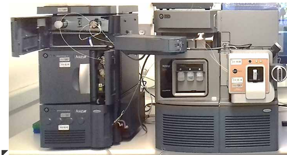
Figura 109. Espectrômetro de Massas 'Xevo TQ-XS', da marca Waters, um dos equipamentos mais sensíveis do mercado que permite a detecção de íons de uma grande variedade de moléculas
