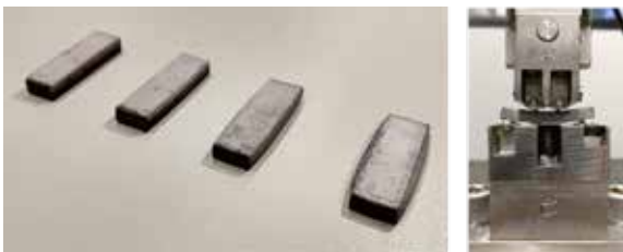
Figura 64. Corpos de prova produzidos por soldagem por difusão (esq) e ensaios de flexão em 4 pontos (dir)
