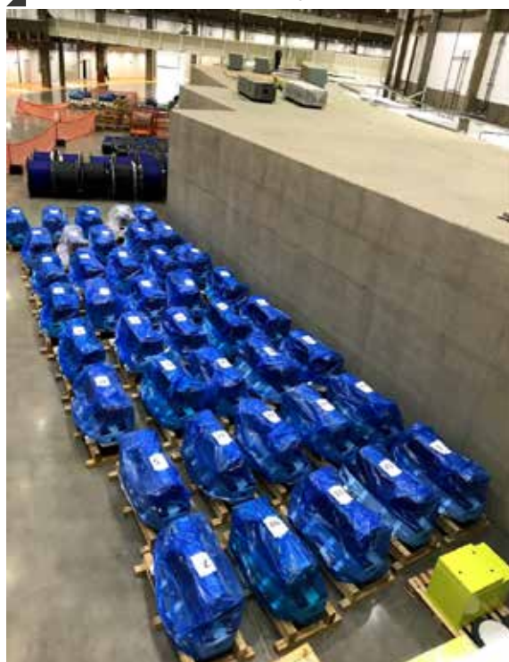
Figura 67. Dipolo B80 e B120 armazenados no Sirius antes da instalação no acelerador
