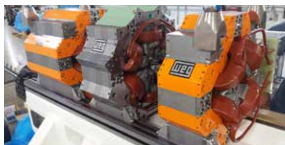
Figura 48. Soquetes especiais removíveis em substituição aos fiduciais convencionais
