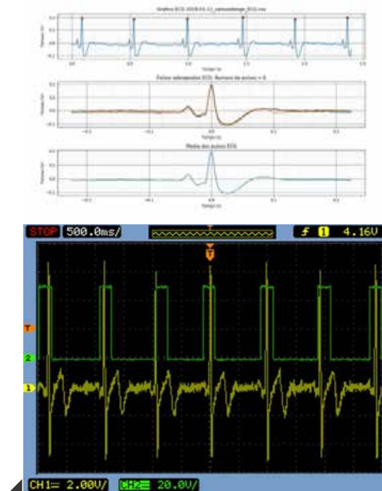
Figura 7. ECG de camundongo sedado com administração IP de Xilazina/Cetamina. Identificação em tempo real da onda R (A). Exemplo do teste de ECG em humanos (amarelo) com detecção dos pontos R, a geração de sinal de sincronismo preditivo (verde) que irá atuar para disparar a aquisição da imagem (B).
