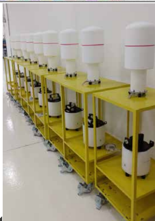
Figura 82. Parte dos 18 medidores de fótons e nêutrons integrados no sistema supervisorio
