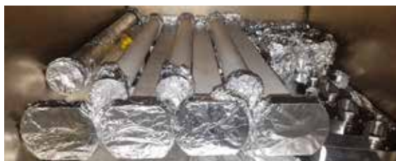
Figura 60. Câmaras dos kickers on-axis e pinger armazenadas em estufa a vácuo
