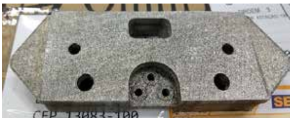
Figura 65. Protótipo produzido por impressão 3D de um manifold para monocromador
