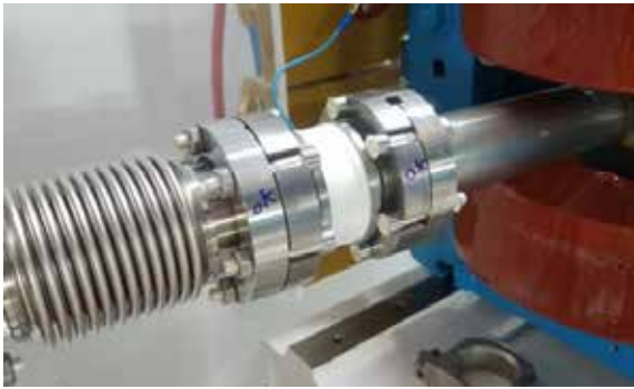
Figura 61. Câmara de interrupção elétrica instalado no Booster
