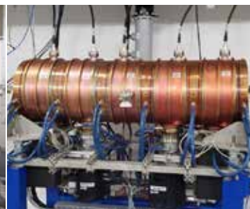
Figura 77. Cavidade de RF do Booster instalada e pronta para operação
