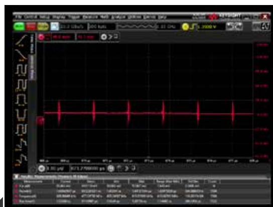
Figura 46. Sinal do feixe detectado no monitor stripline do Booster no dia 6 de junho. O feixe deu mais de 15 mil voltas nesse dia sem radiofrequência
