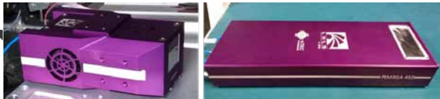
Figura 96. Modelos de detectores \pi -M3GA 15D (Mobipix) e 45D montados e em comissionamento
