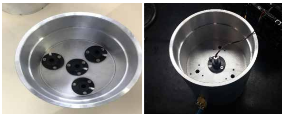
Figura 105. Montagens da versão preliminar do protótipo: esquerda, unidade apresentando as sondas; direita, unidade apresentando as conexões eletrônicas
