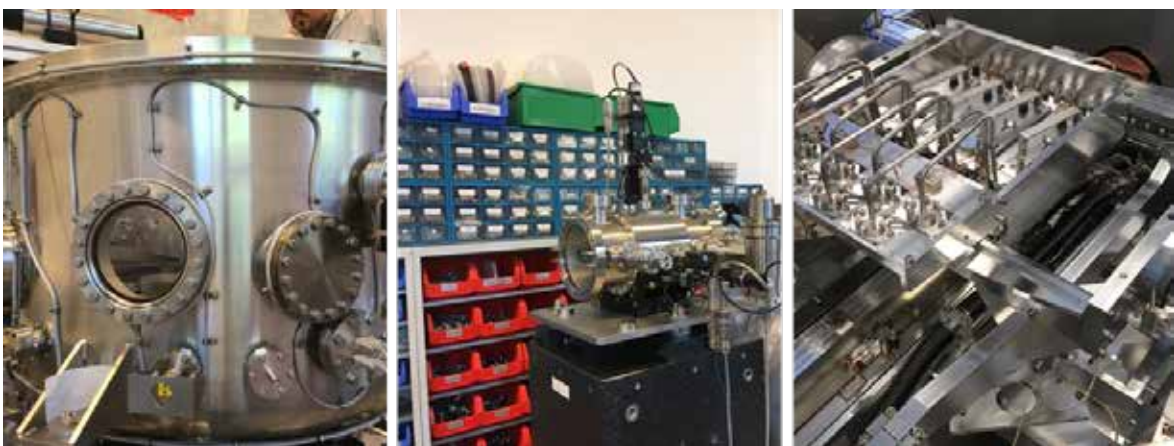
Figura 91. Câmara de vácuo e mecânica interna do monocromador PGM (esq. e dir.) e fenda manocromática (centro)
