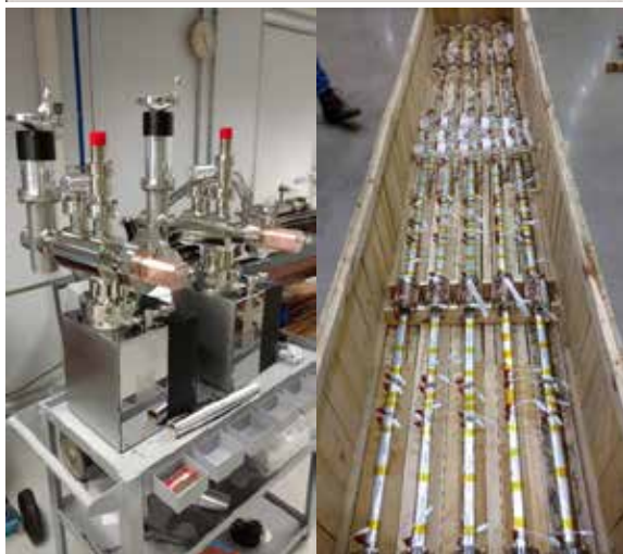
Figura 55. Câmaras de vácuo para as saídas de luz: a esquerda, as câmaras com obturador de fótons para saídas sem linha de luz; a direita, as câmaras para saídas de luz pré-montadas com as máscaras refrigeradas e as fitas finas de aquecimento
