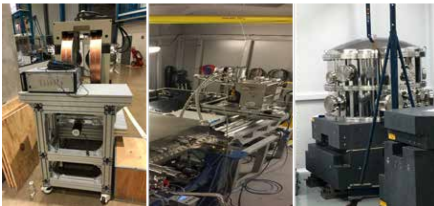
Figura 89. Eletro-ímã de 2.5T e sistema de microfocalização da estação experimental da linha EMA (esq. e centro). Monocromador HD-DCM da linha EMA em montagem na metrologia.
