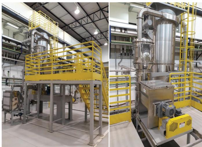
Figura 73. Secador Multipropósito de Biomassa (secagem e limpeza a seco) em finalização de montagem.
