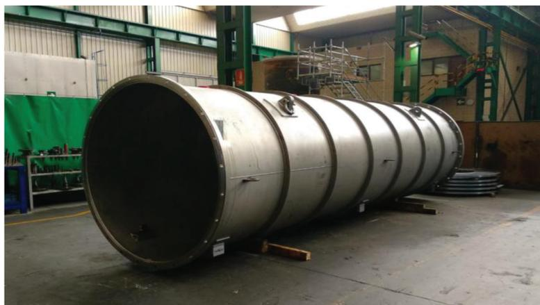
Figura 45. Câmara de vácuo do túnel de espalhamento da linha CATERETÊ.
