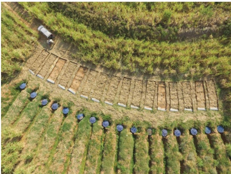
*Figura 7. Ilustração de experimento de campo para avaliação do impacto da remoção de palha nas perdas de solo, água e nutrientes por processos erosivos.*
