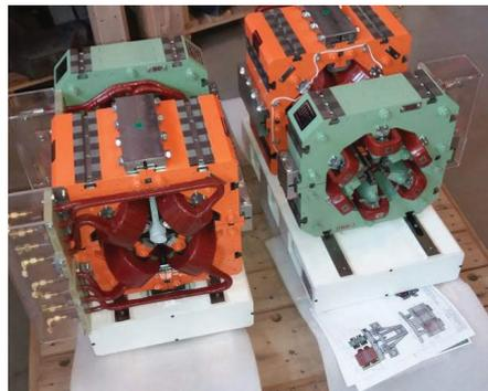
Figura 32. Quadrupolos, Sextupolos montados nos berços e prontos para instalação (todos os 50 berços de multipolos já se encontram montados e prontos para instalação).
