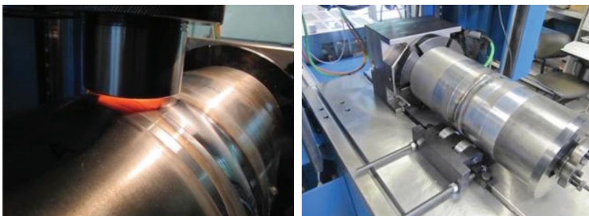
Figura 66. Tubos de aço inoxidável do Projeto CO<sub>2</sub>. Esquerda: tubos durante processo de soldagem FSW. Direita: tubo soldado
