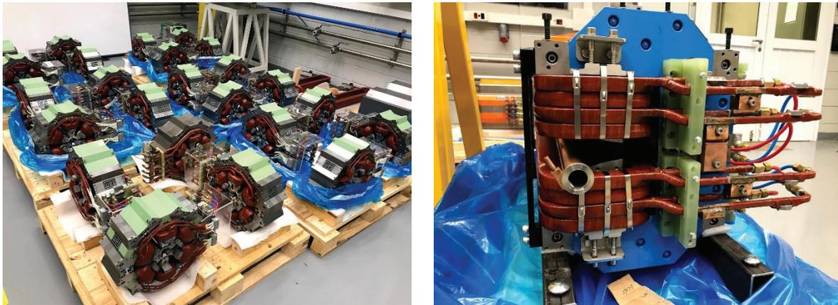
Figura 33. Esquerda: Lote de produção dos sextupolos do anel. Direita: Verificação do protótipo do Dipolo B80.
