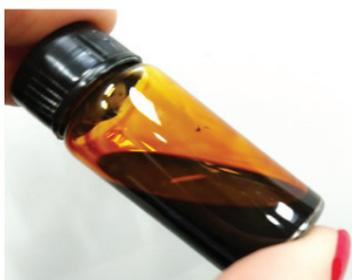
Figura 65. Tinta condutiva produzida com as nanopartículas metálicas
