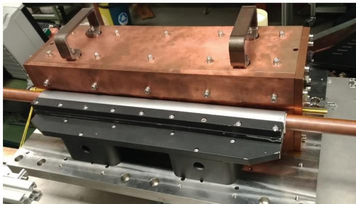
Figura 34. Fabricação da versão final do Septum de Injeção no Anel de Armazenamento.
