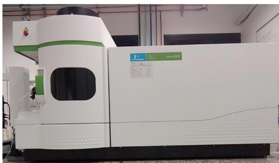
Figura 74. Equipamento Espectrômetro de Emissão Atômica por Plasma Acoplado Indutivamente da marca Perkinelmer (ICP OES/Optima 8000).
