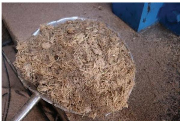
Figura 63. Aspecto da mistura bagaço + palha na saída da moenda, após lavagem e dosagem no último terno.
