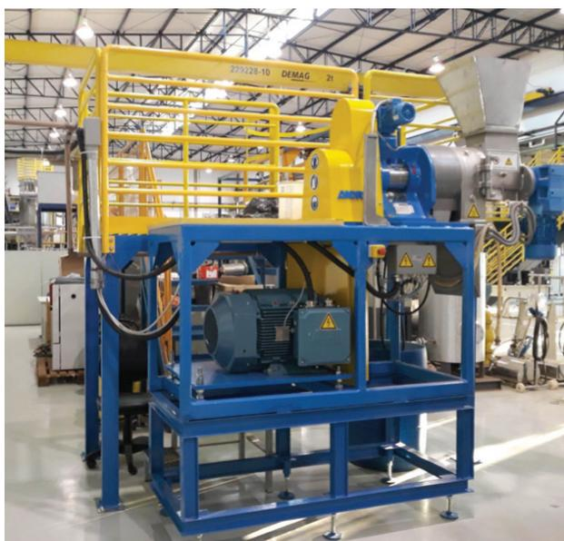
Figura 72. Refinador de discos (capacidade: 10-100 kg/h - base seca - potência 48 kW).
