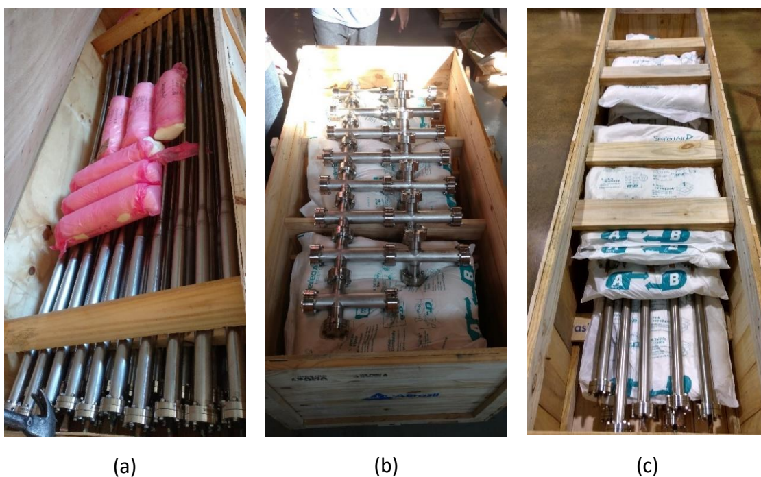
Figura 0.14: Todas as câmaras do booster entregues e prontas para a instalação: (a) câmaras de dipolo; (b) estações de bombeamento; e (c) câmaras para os trechos retos multipolares.
