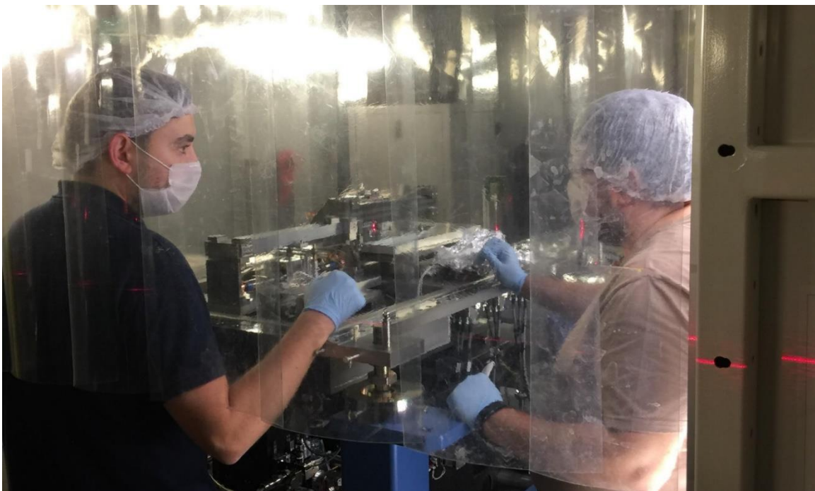
Figura 0.75: Detalhe da instalação do KB da EMA para testes na linha XDS do UVX.
