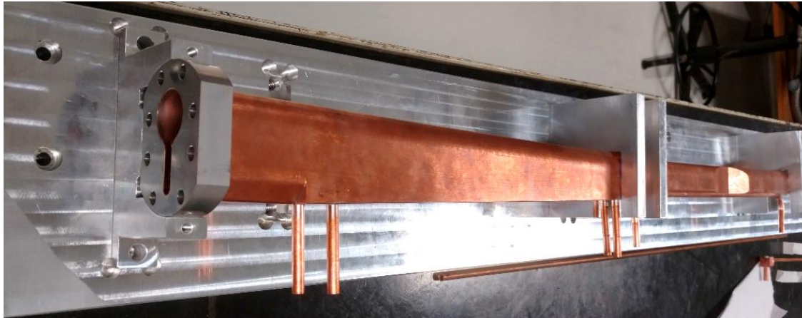
Figura 0.8: Câmara de dipolo, modelo BC, montada em gabarito para o início do processo de soldagem.
