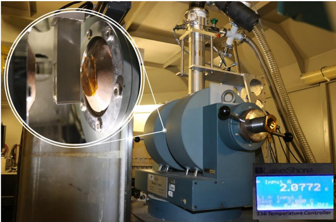
Figura 1.9. Criostato de fluxo de hélio para experimentos de XAS/XMCD/XRD sob altas pressões em temperaturas tão baixas quanto 2K.
