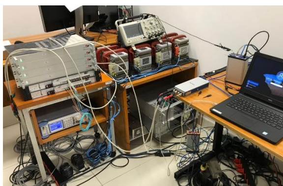
Figura 0.3: Esquerda: Bancada de testes para as fontes do Sirius. Direita: Teste de linearidade da corrente durante a rampa em energia do Booster . Corrente de saída das corretoras do Booster medida em um curto intervalo na subida de energia da rampa. Na curva azul há 4000 pontos por período, e na curva vermelha, 2000.
