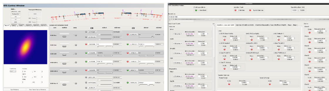
Figura 0.2: Mais interfaces gráficas de aplicativos de alto-nível para o Sirius. Esquerda: aplicativo para controle dos ímãs, correção de órbita e controle dos monitores de tela fluorescente da linha de transporte booster-anel. Direita: aplicativo para controle dos parâmetros de sincronismo durante o processo de injeção.
