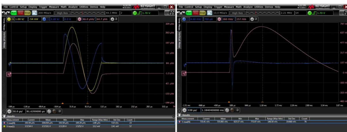
Figura 0.20: Medida do campo magnético no gap (esquerda) e do campo de fuga (direita). A linha amarela representa o pulso de corrente na bobina do septum, a linha azul representa a tensão induzida na bobina de medida e a linha magenta representa a integral da tensão induzida na bobina de medição.
