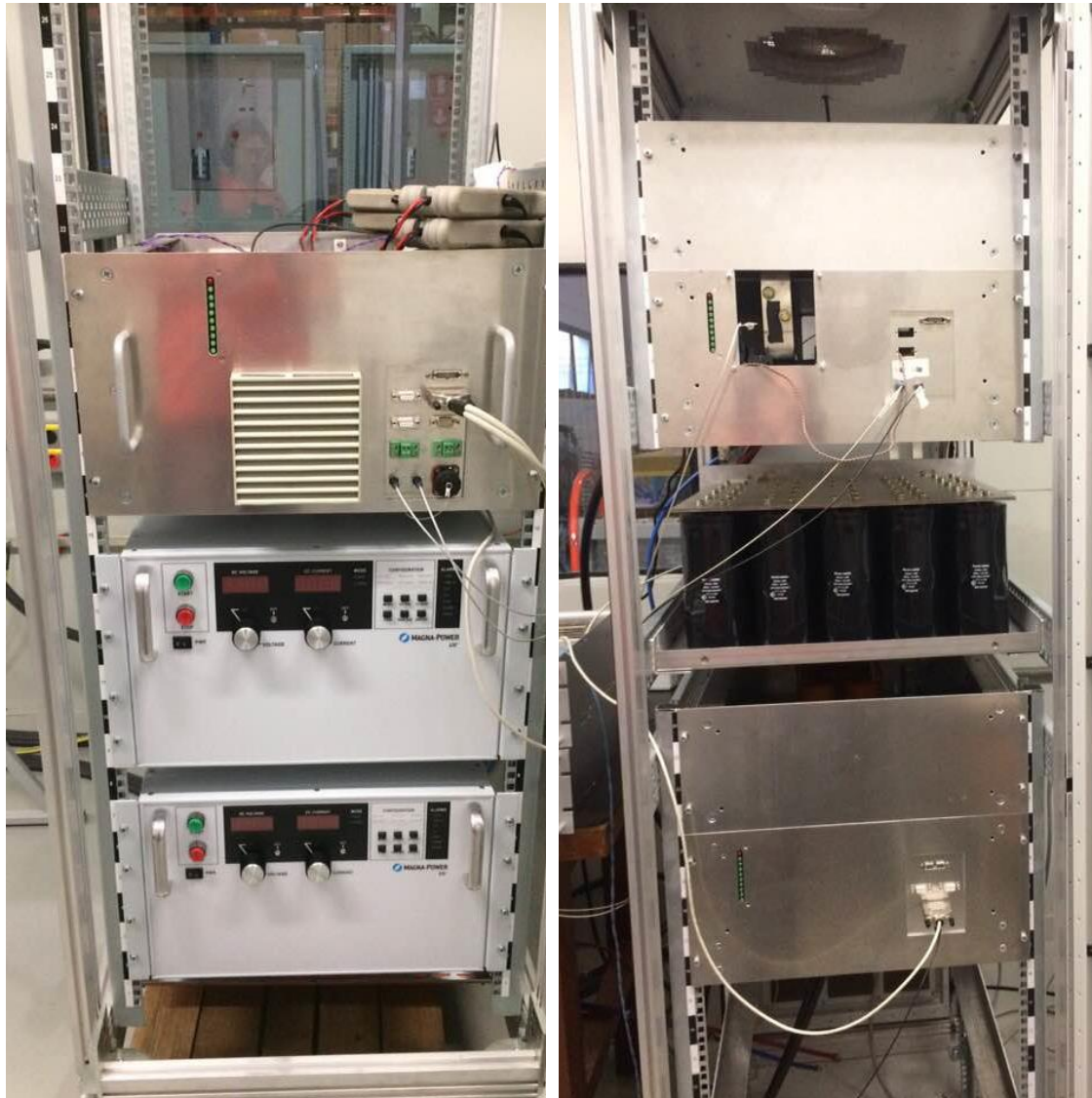
Figura 0.61: Módulos do lote piloto das fontes FAP (esquerda) e FAC (direita) sendo testados.
