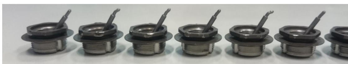
Figura 0.52: Superior: Aspecto da ruptura da brasagem após ensaio de compressão; superior direito, pino torto após o ensaio – deformação plástica. Centro: Montagem do ensaio de compressão sob vácuo. Inferior: Corpos de prova deformados após ensaios de flexão no pin o, ensaio realizado sob vácuo. Apesar da deformação plástica acentuada do pino, não ocorreu ruptura na brasagem e as peças permaneceram estanques.
