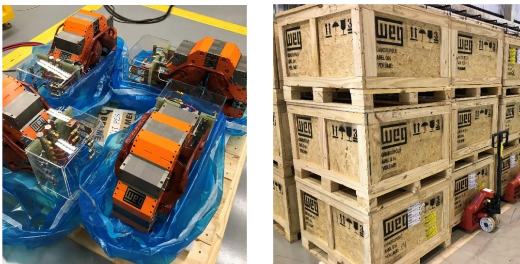
Figura 0.16: Esquerda: Lote de produção dos quadrupolos do anel. Direita: Conjunto de quadrupolos do anel (Q14, Q20 e Q30) totalmente entregues e em processo de medição no LNLS.
