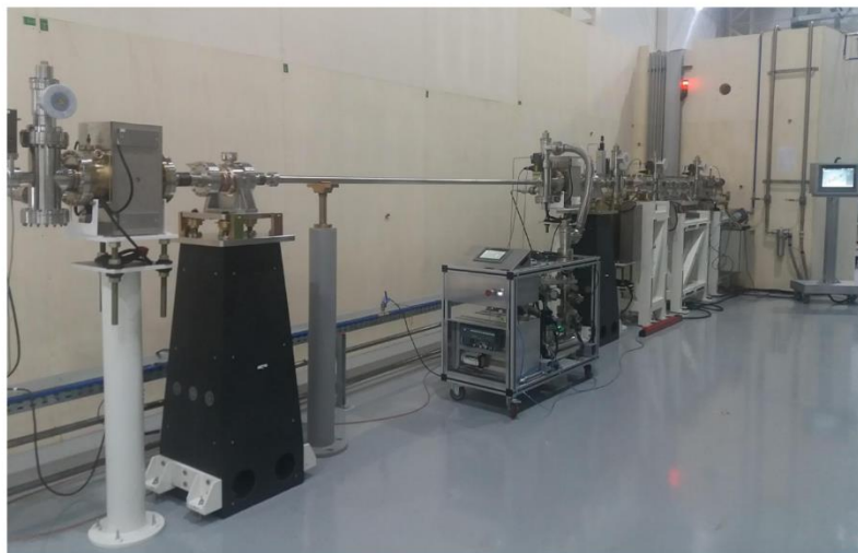
Figura 0.67 Front-end completo montado no prédio de metrologia
