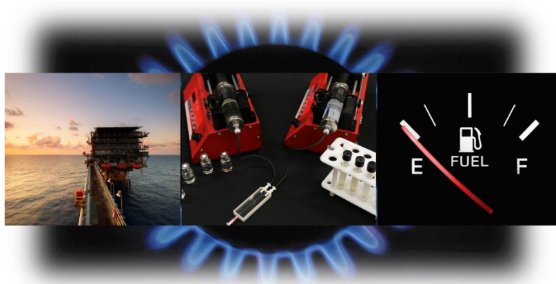
Figura 4.13 - Ilustrações do método desenvolvido no LNNano para quantificação de traços de glicol em amostras de condensado. A foto central mostra o setup usado para extrações líquido-líquido.
