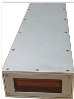
Figura 0.77: Detector de 12 chips montado e aguardando a conclusão da eletrônica de leitura para comissionamento.
