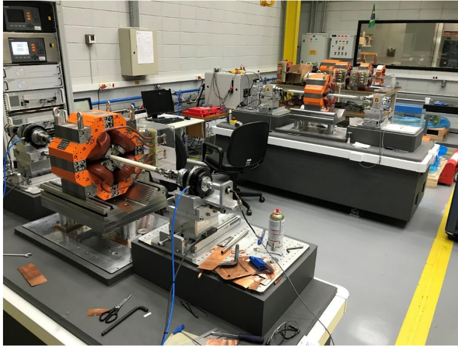
Figura 0.18: Bancadas de bobina girante duplicada para aumento de produtividade de medição magnética. (Bancada 1 já com sistema de rotação pneumático para melhoria de repetibilidade).
