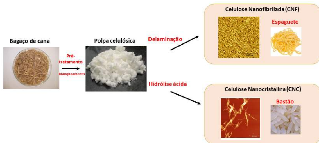
Figura 4.22. Celulose nanocristalina e nanofibrilada preparadas a partir de bagaço de cana-de-açúcar
