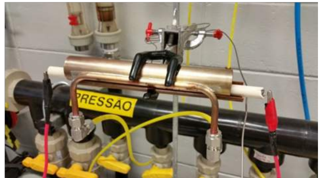
Figura 1.7.20. Sistema de testes de fadiga térmica sobre a bancada (esquerda) e detalhe da construção do sistema de aquecimento simulando a carga térmica do feixe de luz síncrotron (direita). Os 1093 ciclos realizados tiveram rampa de aquecimento de 10 min, patamar a 200° C de 10 min e rampa de resfriamento de 10 min.
