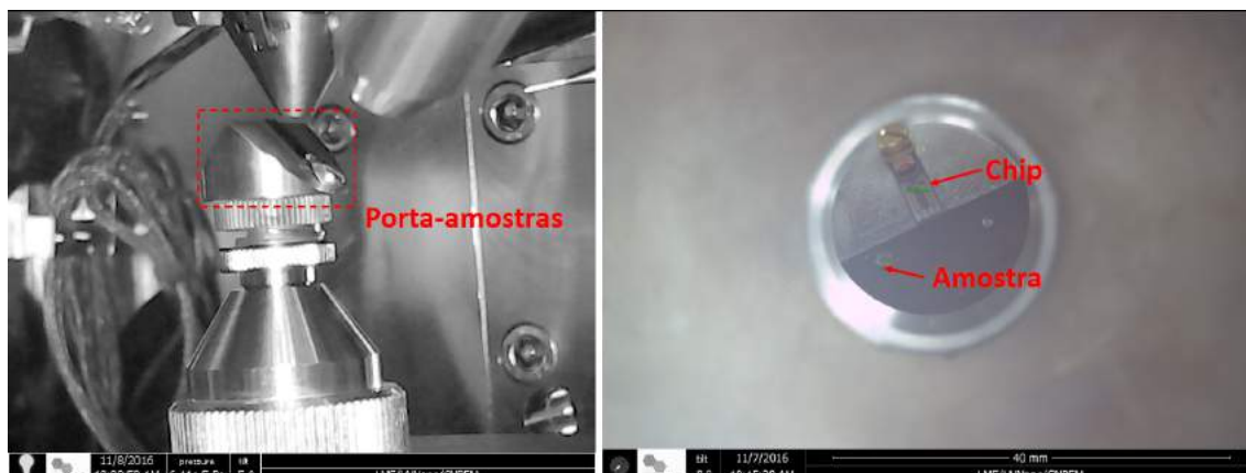
Figura 4.30. Imagem do interior da câmara do Helios NanoLab 660 Dual Beam (esquerda), mostrando o porta-amostra desenvolvido para a retirada de lamelas de amostras e integração em chips de aquecimento (direita)
