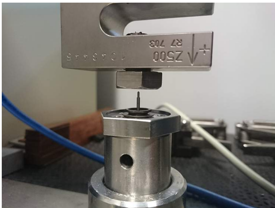
Figura 1.7.59. Teste de resistência mecânica do pino do botão do BPM. Nas amostras analisadas, a força necessária para romper a cerâmica à qual o pino é brasado ficou acima dos 400 N.
