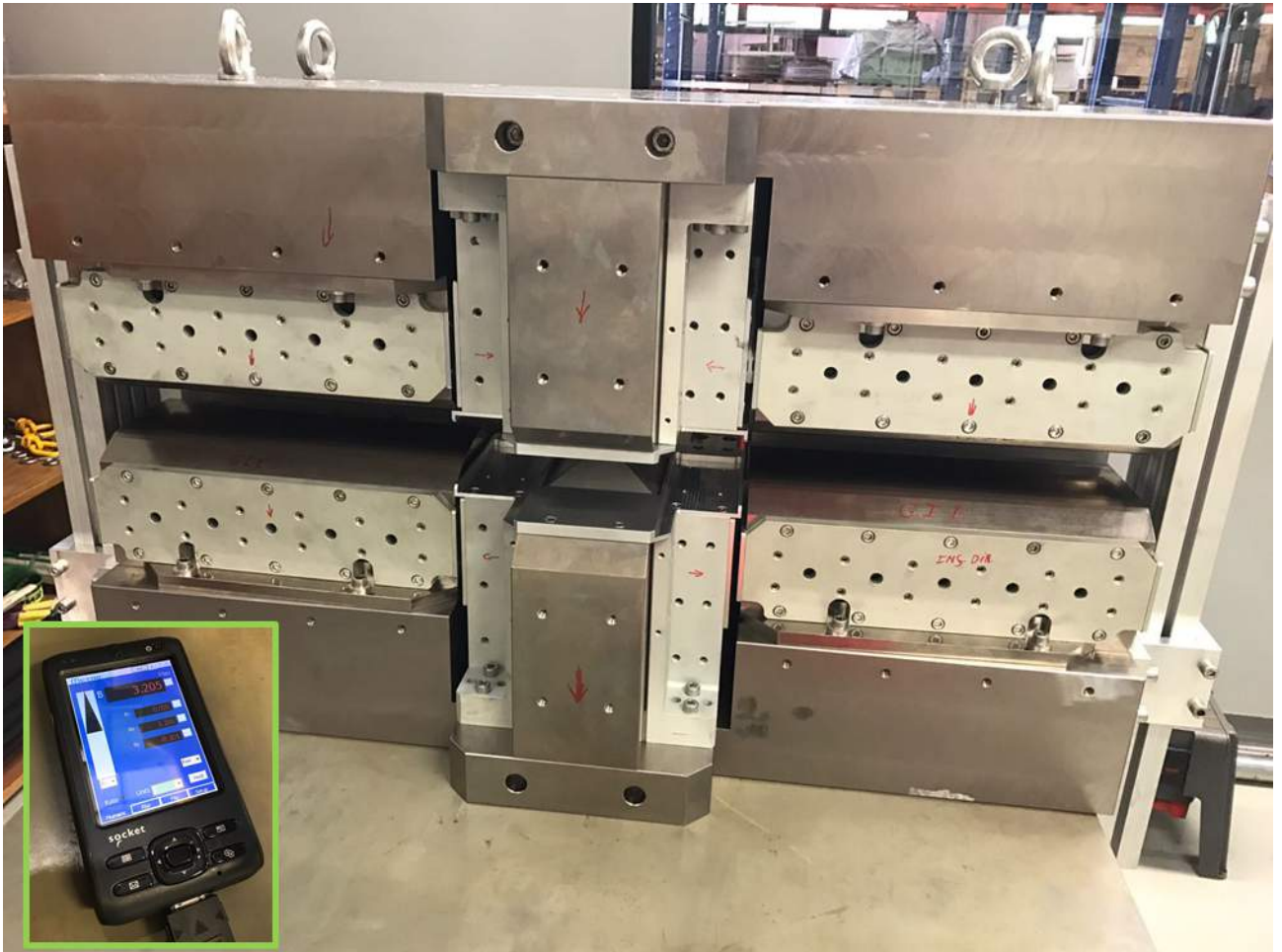
Figura 1.7.28. Protótipo do dipolo central (BC) alimentado por magnetos permanentes, com duas regiões de baixo campo (esquerda e direita) e uma região central de alto campo. O valor de campo obtido na região central, em uma primeira medição com instrumentos portáteis (detalhe à esquerda), foi de 3.205T.
