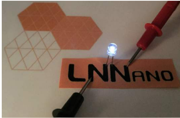
Figura 4.33. Estrutura condutora incorporada em papel
