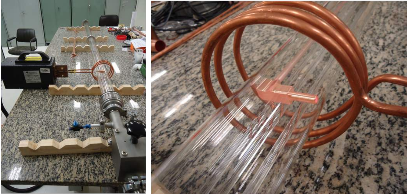
Figura 1.7.23. A esquerda o transformador que aplica a corrente alternada de alta frequência (290 kHz) na espira de cobre em volta do tubo de quartzo e à direita o resultado do aquecimento do terminal de refrigeração durante a brasagem ao tubo de refrigeração.
