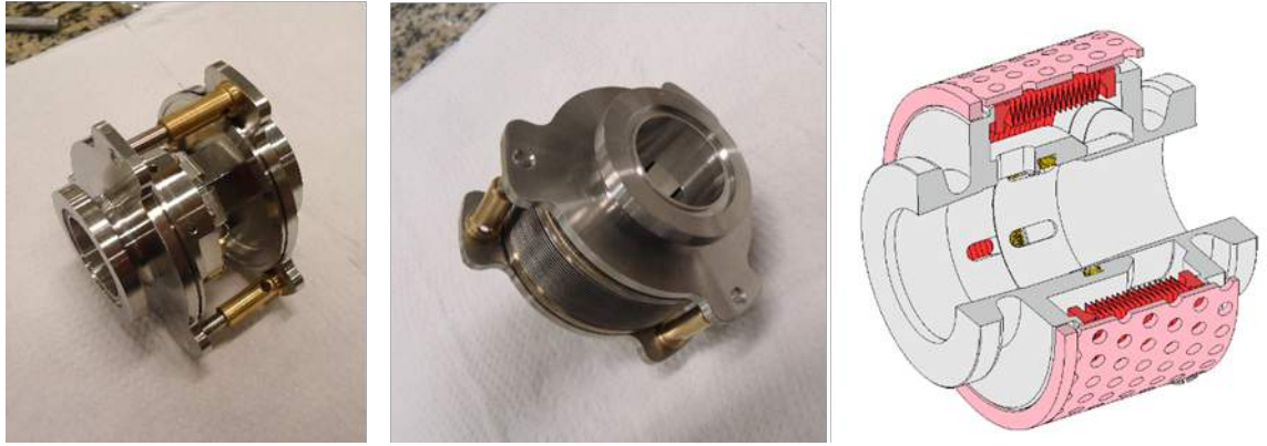
Figura 1.7.16. Protótipo do conjunto bellows conceito “strips” em formato \Omega (esquerda e centro) e desenho do conjunto bellows conceito “telescópico” (à direita).
