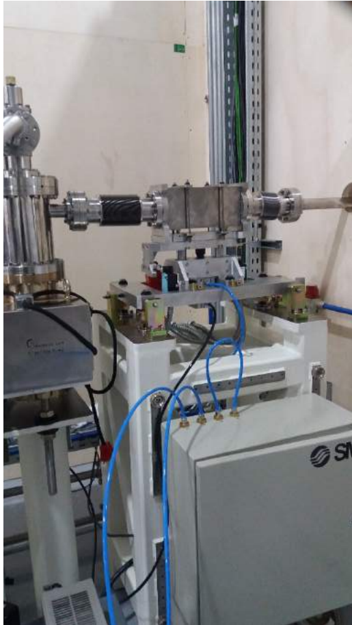
Figura 1.7.80 Esq. Estação de bombeamento com gamma shutter do lado de dentro da blindagem; Dir.: Estação de bombeamento do lado de fora da blindagem.
