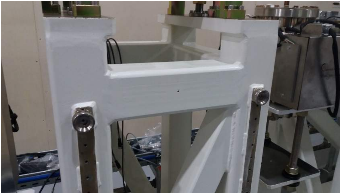
Figura 1.7.81 Detalhe dos suportes das miras no berço
