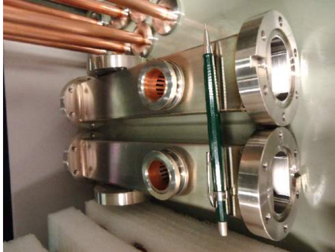
Figura 1.7.15. Novos protótipos das estações de bombeamento convencionais.
