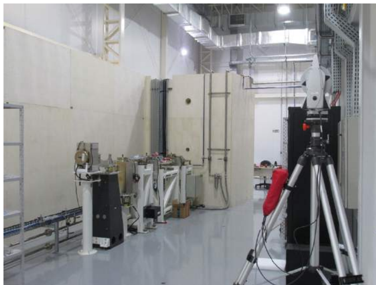
Figura 1.7.90: Laser Tracker (AT-402/Leica). Utilizado para alinhamento de berços e componentes das linhas de luz e front-ends . Na figura, alinhamento do protótipo do front-end , montado no laboratório de metrologia.
