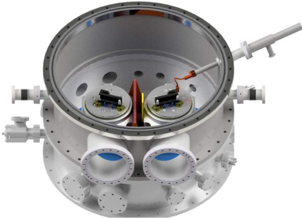
Figura 1.7.84 Arranjo dos dois cristais channel-cut , fenda e elemento de refrigeração dentro da câmara do 4CM.
