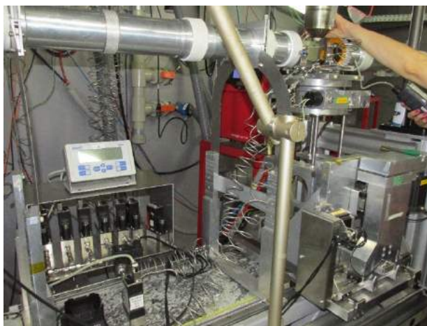
Figura 1.6.11 Controladores de vazão de gases (esq. inf.) próximos aos fornos e porta-amostras na linha DXAS.
