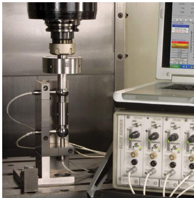
Figura 1.7.88 Spindle Error Analyser (SEA). Equipamento fornecido pela empresa Lion Precision. Referência: curso de mecânica de precisão oferecido pela Cranfield University (Inglaterra); equipamento utilizado em outros síncrotrons (ex. ESRF).
