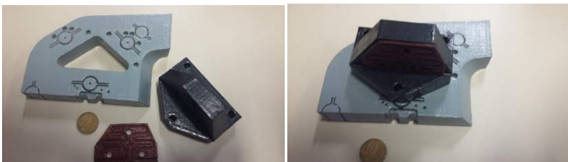
Figura 4.4. Detalhes do suporte do cristal do monocromador para a linha EMA do Sirius. Partes incluem os canais de refrigeração e suporte mecânico
