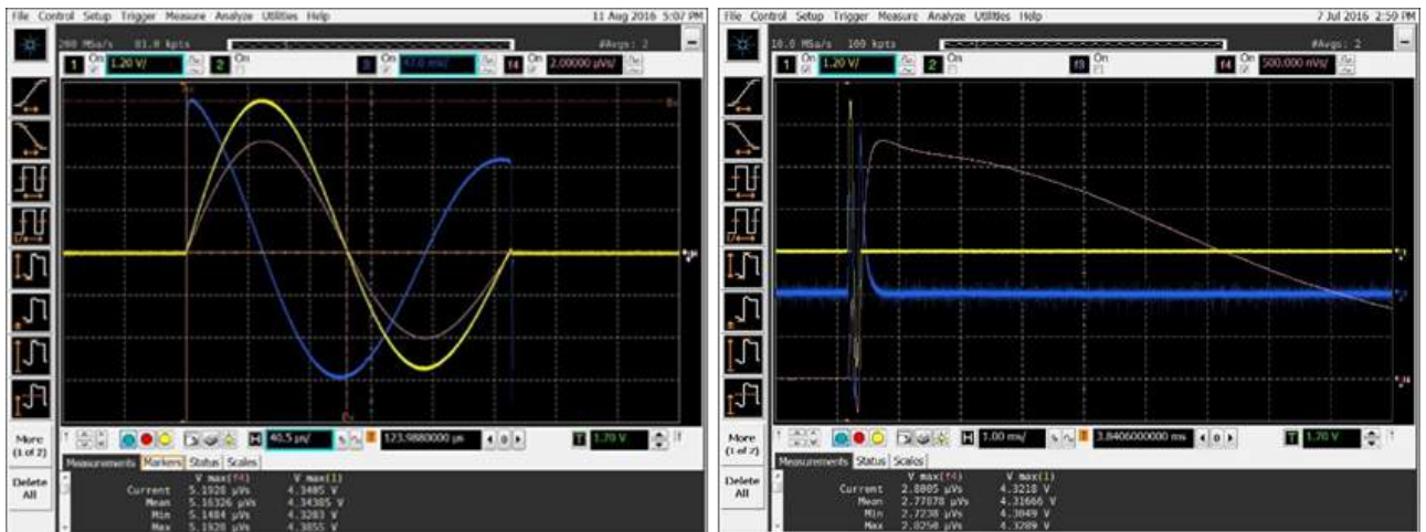
Figura 1.7.33. Medida do campo magnético no gap (esquerda) e do campo de fuga (direita). A linha amarela representa o pulso de corrente na bobina do septum, a linha azul representa a tensão induzida na bobina de medida e a linha magenta representa a integral da tensão induzida na bobina de medição.
