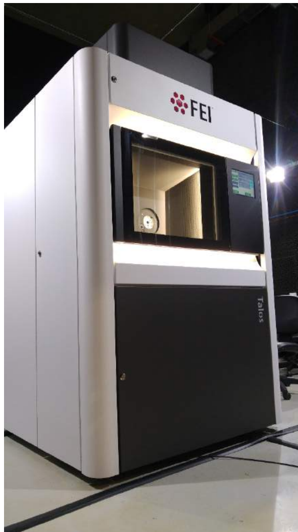
Figura 4.11. Foto do microscópio eletrônico de transmissão Talos F200C (FEI)
