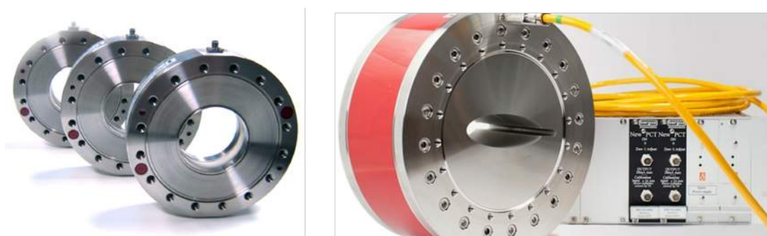
Figura 1.7.46. Sensores comerciais de carga e de perfil temporal para feixe de elétrons pulsado (esquerda) e de carga para feixe contínuo (direita). Os modelos do Sirius já estão em fabricação na empresa Bergoz Instrumentation , na França.
