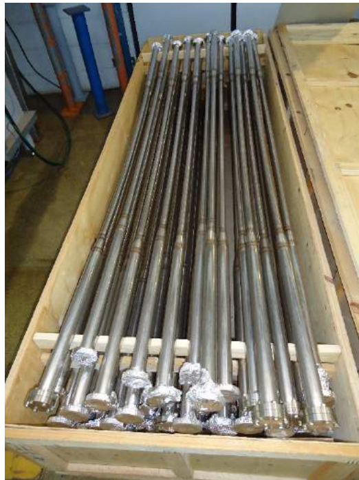
Figura 1.7.17. Todas as câmaras de dipolo do booster.
