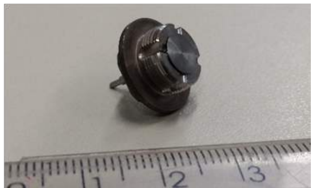
Figura 1.7.58. Casulo, arruela de cerâmica e pino central de um botão de BPM antes da brasagem (esquerda) e conjunto completo após a brasagem (direita).
