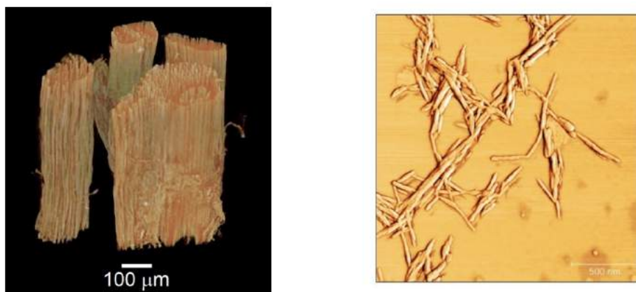
Figura 4.24. Imagem de microtomografia de raios-X da celulose (esquerda). Imagem de força atômica (AFM) de nanocristais de celulose (direita)
