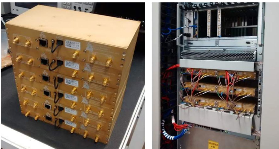
Figura 1.7.51. Caixas com as eletrônicas dos circuitos RFFE sobre a bancada (esquerda) e no rack de testes (direita).
