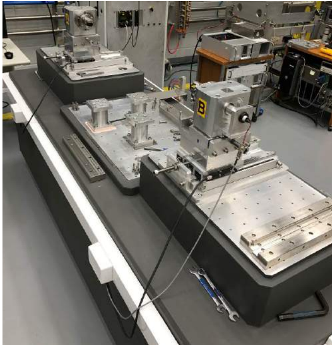
Figura 1.7.29. Nova bancada de bobina girante para aferição dos magnetos do Sirius.
