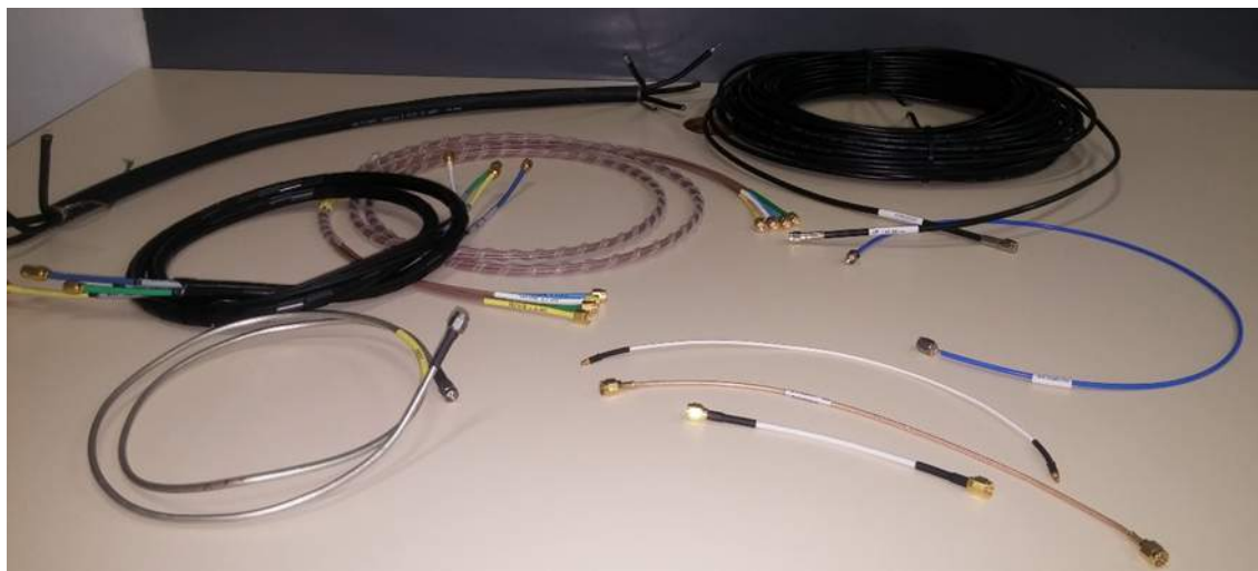
Figura 1.7.45. Alguns dos cabos coaxiais usados no sistema de medida de posição de feixe. Serão necessários milhares de cabos, de diferentes modelos e com diferentes tipos de conectores.
