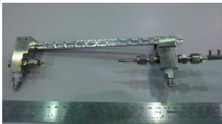
Figura 1.6.6 Cela capilar, resultante projeto da pesquisadora Cristiane Rodella da linha XPD, financiado pela FAPESP, instalada na XRD1 e disponível para usuários.
