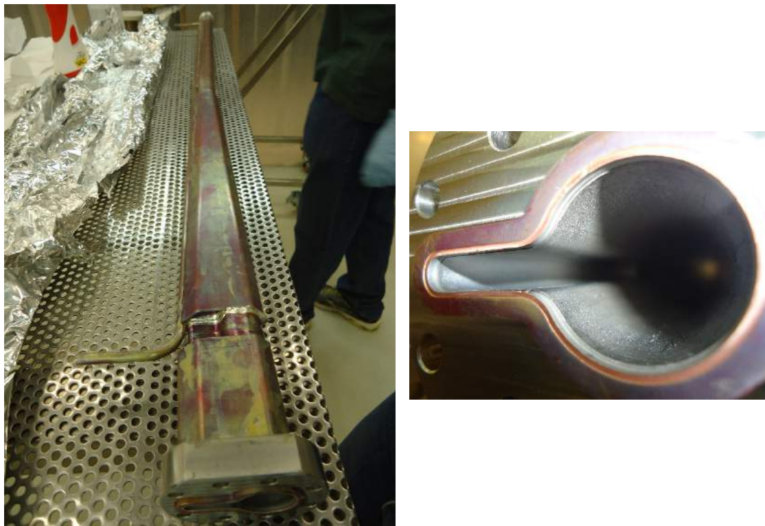
Figura 1.7.13. Esquerda: Protótipo de câmara de dipolo com saída de luz. Direita: Interior da câmara pós deposição do filme NEG.
