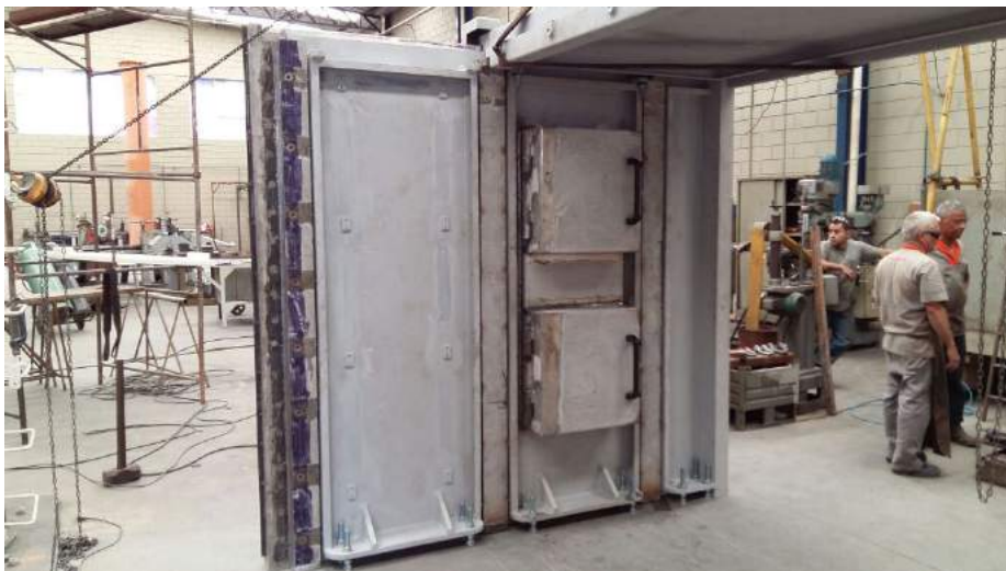
Figura 1.7.73 Partes da cabana ótica que estão sendo montadas para testes do protótipo que ficará no UVX
