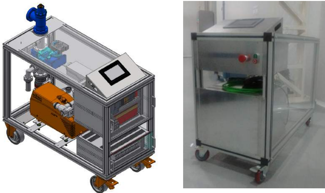
Figura 1.7.75 Esquerda: Desenho isométrico da montagem da estação de bombeamento (MPS), com o detalhe do sistema de controle. Direita: Montagem do carrinho, parte mecânica e controle já finalizador, faltando somente a parte de vácuo e testes finais de performance.
