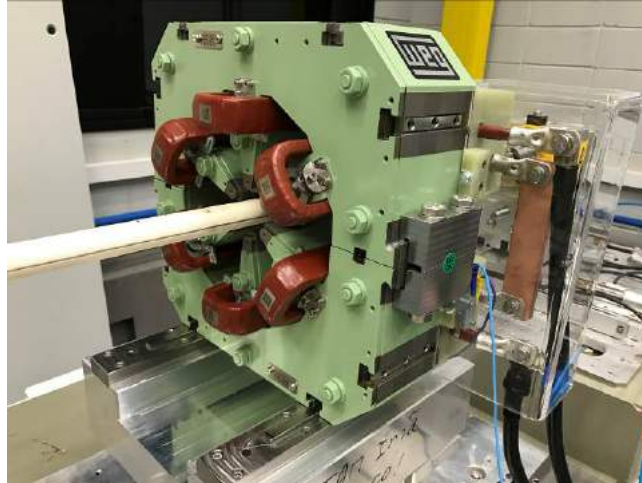
Figura 1.7.24. Sextupolos do Booster em fase de caracterização magnética.
