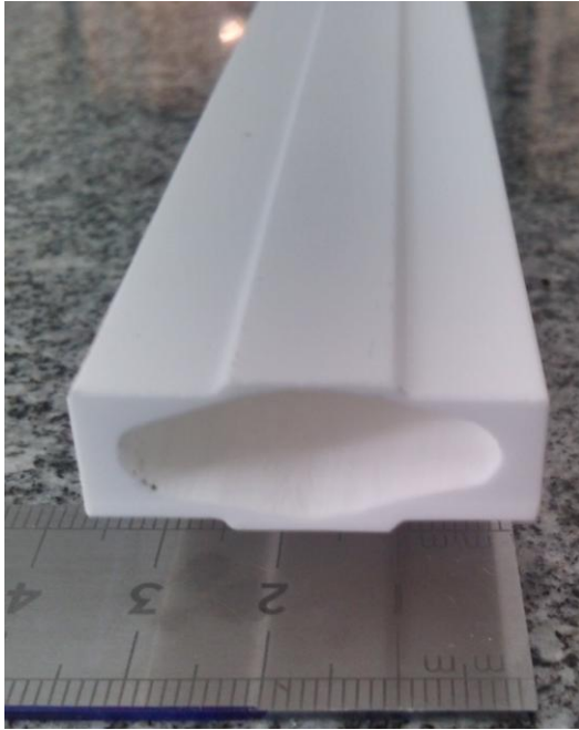
Câmara de vácuo em alumina de lata pureza desenvolvida para o Projeto Sirius pela empresa ENGE CER.
