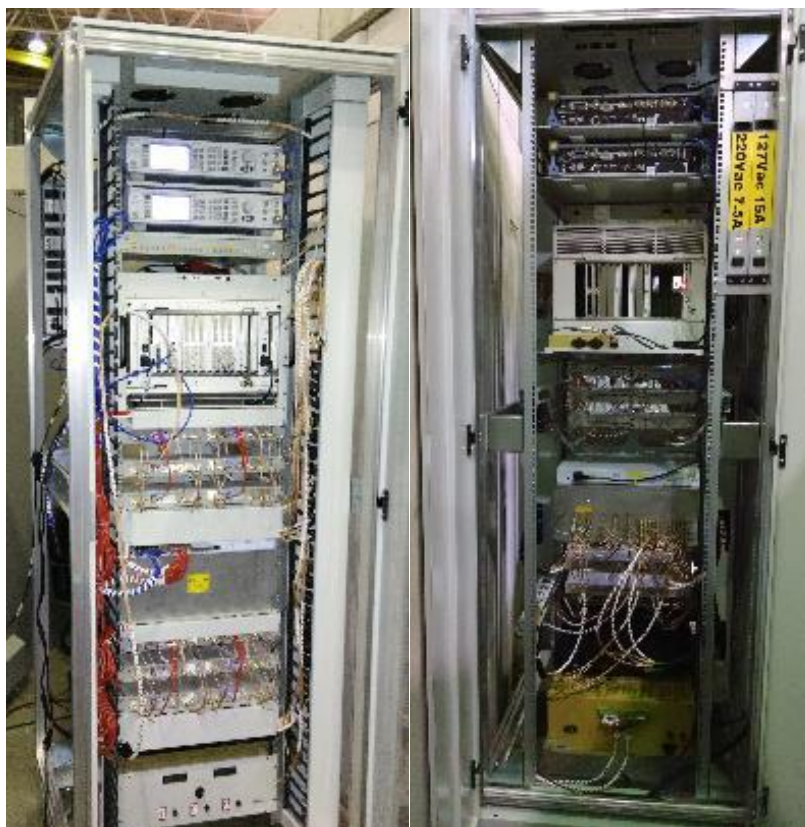
Eletrônicas de medida de órbita integradas e em teste de estabilidade.
