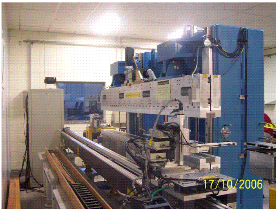
Figura 29: O ondulador elíptico (EPU) durante testes na bancada de medidas magnéticas.
