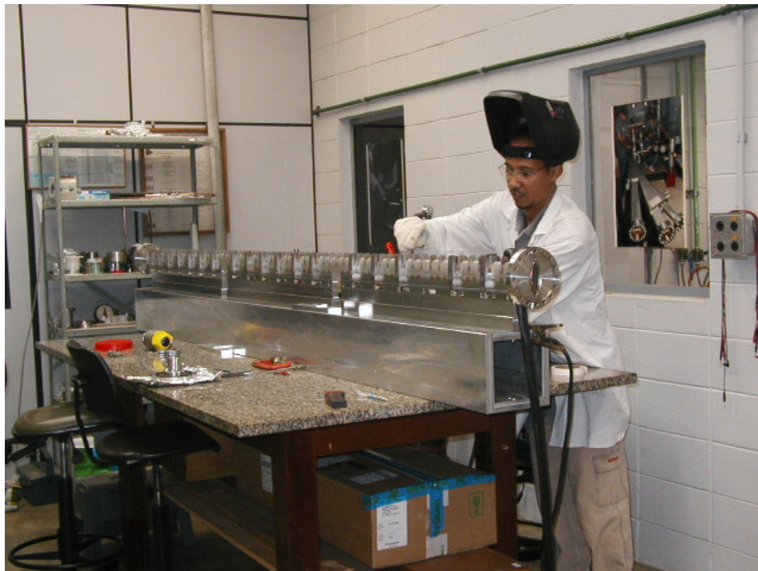
Figura 04 : Protótipo da câmara do wiggler de três metros de comprimento sendo preparada para seu envio ao ESRF.
