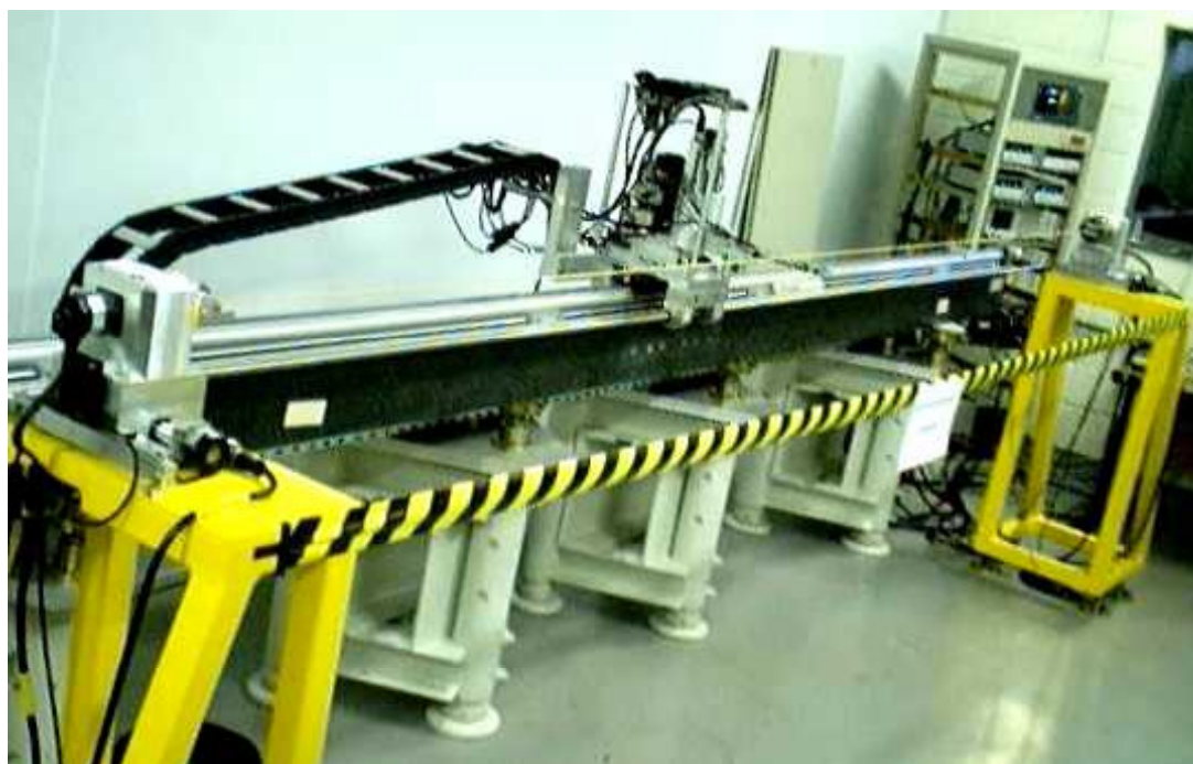
Figura 5: Bancada de Caracterização de dispositivos de inserção construída no LNLS. Vemos uma bobina girante de 4.2 m de comprimento e um conjunto de sensores hall para mapeamento do campo.
