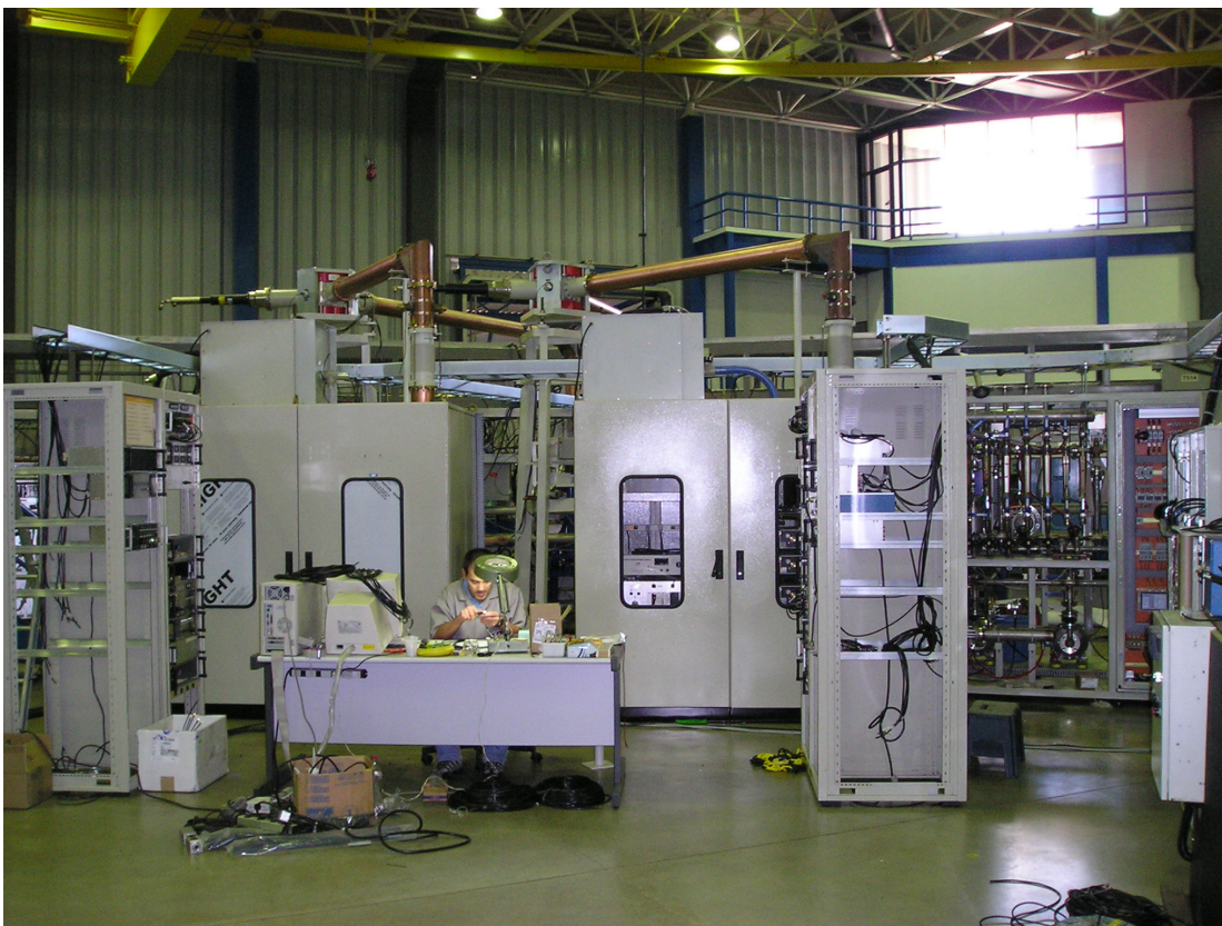
Figura 2: Novo sistema de RF do anel de armazenamento em fase final de testes. Ao alto vemos os guias de onda que conduzem a RF de alta potência às duas cavidades instaladas no trecho 5 do anel.
