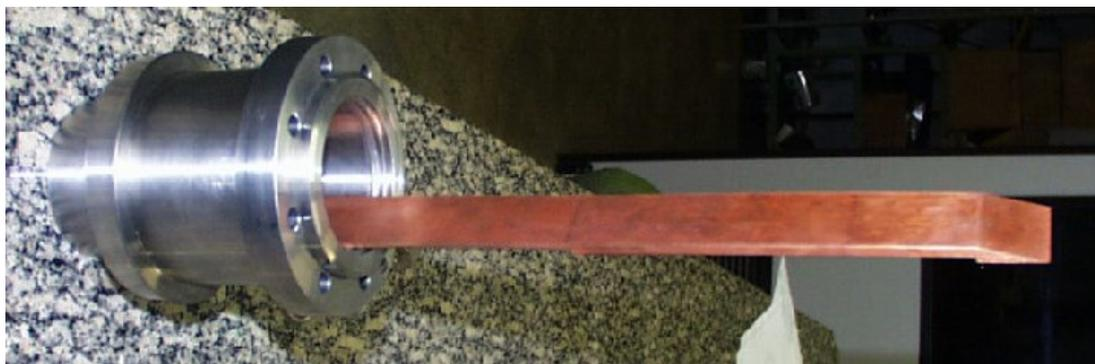
**Figura 2: Uma das doze máscaras de cobre instaladas nas câmaras de dipolo**
