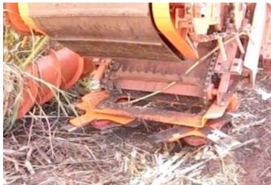
*Figura 4.10: Cortador de base duplo instalado na frente de colheita de esteira.*
