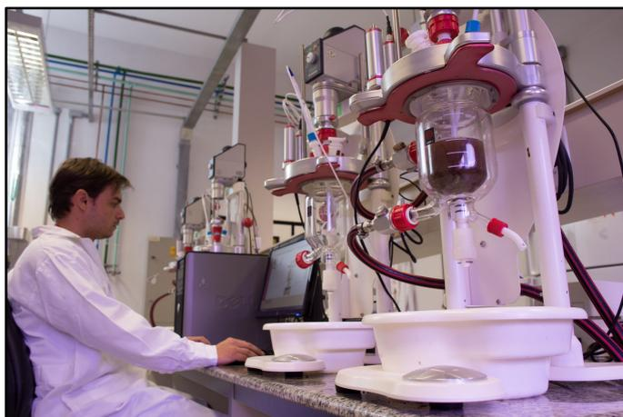
*Figura 4.20: Reator para hidrólise da biomassa lignocelulósica presente no LDB.*
