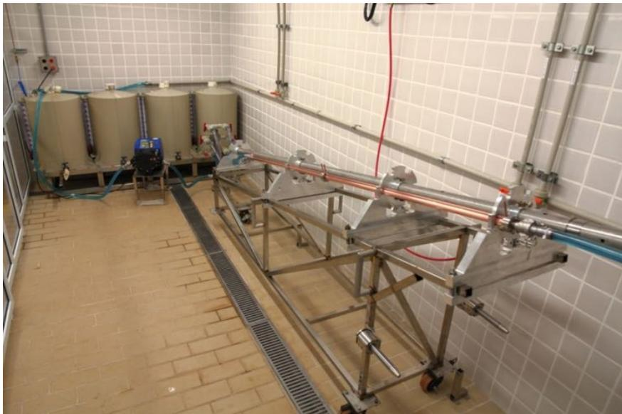
2. 67 – Equipamento de limpeza/decapagem das câmaras de cobre do Sirius.
