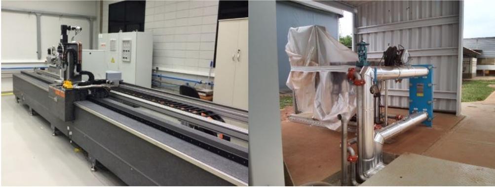
2. 66 – Nova bancada para mapeamento de eletroímãs (esquerda) e sistema de resfriamento de eletroímãs para a sala de medidas.
