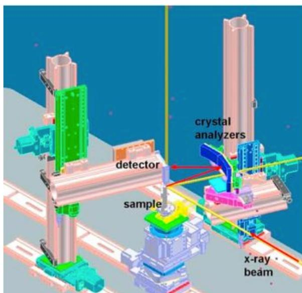
Figura 2. 80 – Desenho esquemático do espectrômetro de von Hamos, desenvolvido na linha SuperXAS do SLS.
