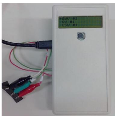
*Figura 5. 4 Protótipo do potenciostato portátil desenvolvido no LMF*
