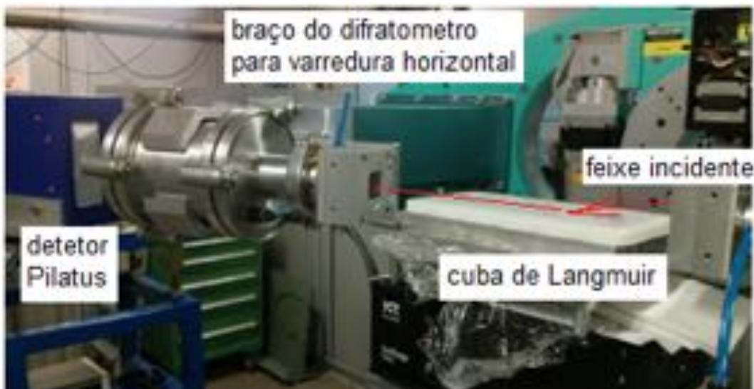
Figura 2. 28 – Setup experimental de GID/GISAXS em líquidos na linha XRD2
