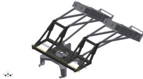
*Figura 4.9: Estrutura para simulação das condições de carga atuantes na ETC.*
