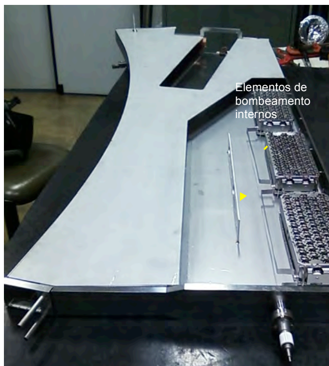
Figura 13 – Câmara de vácuo para uma linha de infravermelho projetada segundo os conceitos em estudo no Projeto Sirius e instalada na fonte de luz Síncrotron atual
