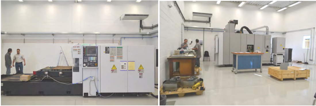
Figura 14 – Ampliação da oficina mecânica do LNLS para abrigar as novas máquinas de usinagem: corte a laser (esquerda) e centro de usinagem de cinco eixos (direita). A terceira máquina, um centro de usinagem de quatro eixos, foi instalada no segundo semestre de 2011
