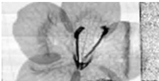
Figura 7 - Radiografia de uma flor obtida com o uso das três grades de difração para 14 keV na Linha XRD-2
