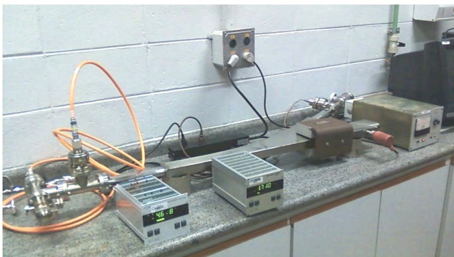
Figura 12 – Teste de velocidade de bombeamento de um elemento de bomba iônica inserido diretamente dentro de uma câmara de dipolo
