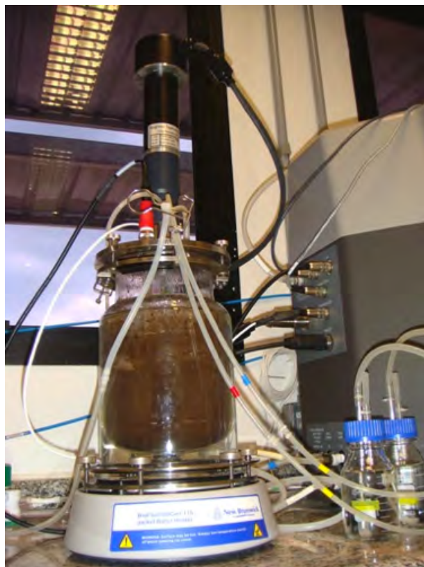
Figura 34 - Hidrólise Enzimática em laboratório
