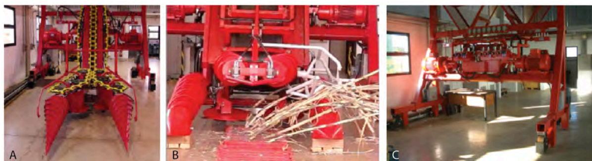
Figura 29 - Frentes de colheita de correntes e esteiras em fase de desenvolvimento no CEI (A e B) e de Ensaio de Implementos (CEI) com controle eletro-hidráulico de funções (C)
