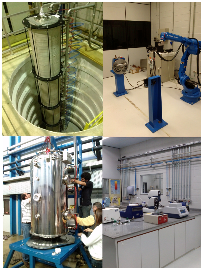
Figura 2.9: Alguns exemplos de melhoramentos da infraestrutura técnica nas áreas de materiais e vácuo: Equipamento para deposição de filmes NEG (acima à esquerda), robotização de soldas para vácuo (acima à direita), forno vertical de brasagem em vácuo (abaixo à esquerda) e novas instalações do laboratório de materiais (vista parcial).
