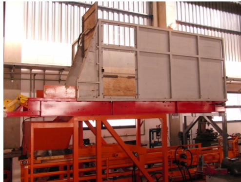
Figura 4.17: Unidade desagregadora substituída no módulo experimental de plantio de precisão existente no LPA
