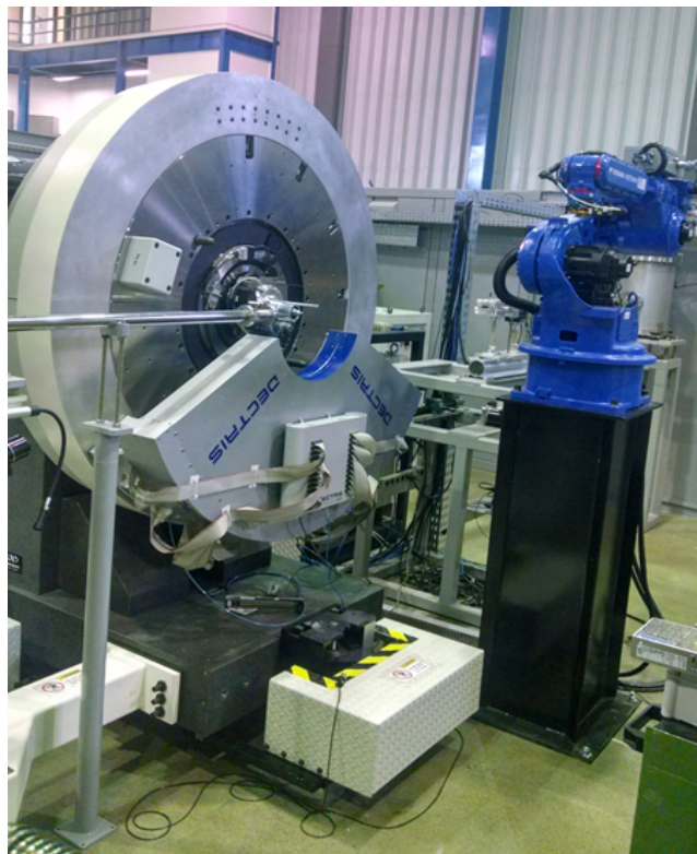
Figura 2.14: Nova estação experimental da Linha XRD1 com o difratômetro e o braço robótico para troca de amostras
