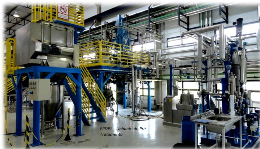
Figura 4.8 – PPDP2: Unidade de Pré-Tratamento Contínuo
