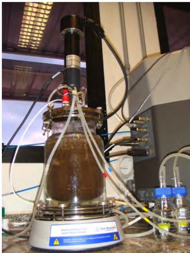
Figura 34 - Hidrólise Enzimática em laboratório
