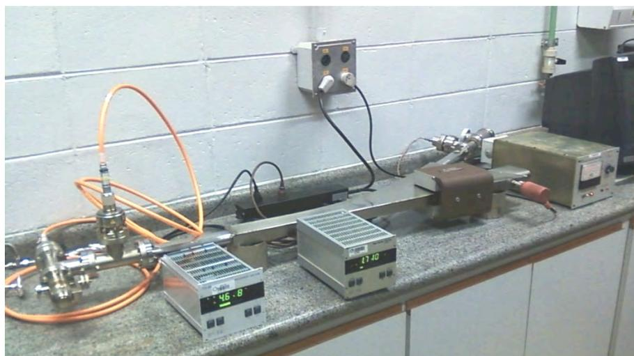
Figura 12 – Teste de velocidade de bombeamento de um elemento de bomba iônica inserido diretamente dentro de uma câmara de dipolo
