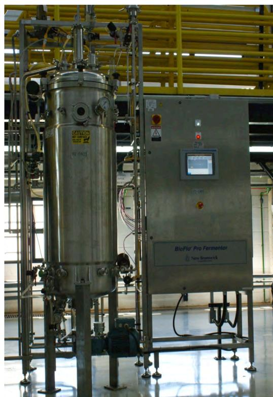
Figura 35 - Fermentador de Hidrólise Enzimática em funcionamento
