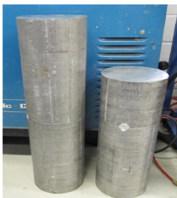
União de tarugos de alumínio com alinhamento perfeito
