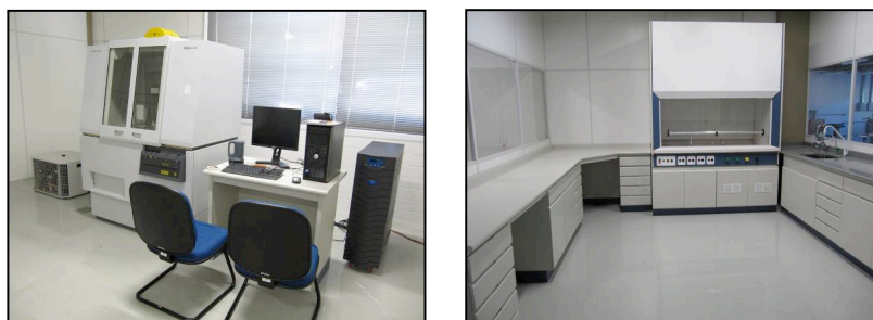
Difratômetro de raios X para análise de tensão residual (a) e a sala de preparação de amostras (b).
