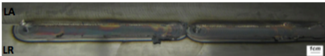
Chapas depois das tentativas de soldagem por FSW: ferro fundido cinzento no LA e aço 4140 no LR.
