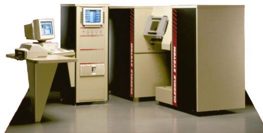
Sistema de simulação física de materiais Gleeble 3800®. Vista frontal com unidade móvel para tração compressão. Imagem cedida pela DSI
