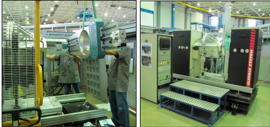
Estação Experimental de Simulação Termomecânica e Difração de Raios-x (TMX). (a) Atividades de montagem do Goniômetro Huber 440 X2 W2, (b) estação experimental
